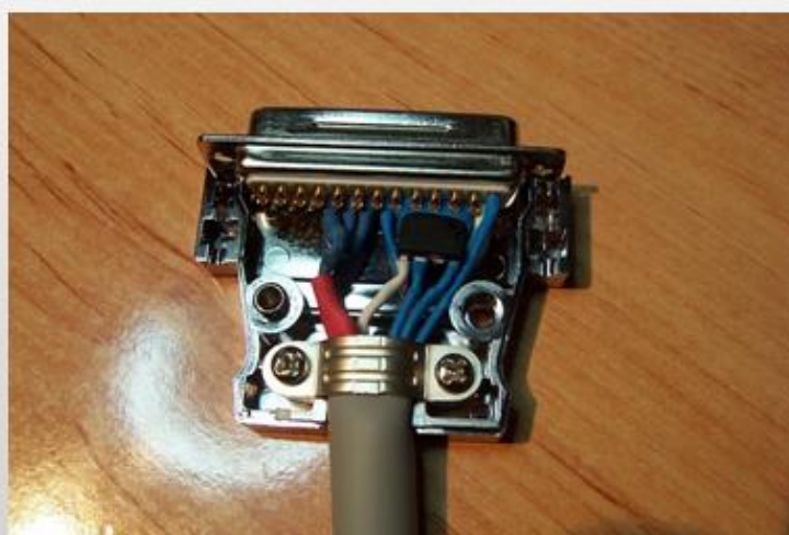
Ejemplo de otro montaje, con un adaptador DB25 a emisora Teltronic
