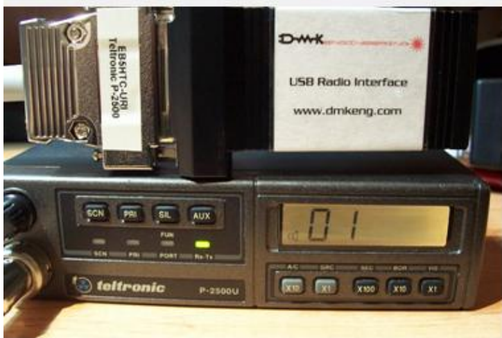
Ejemplo de otro montaje, con un adaptador DB25 a emisora Teltronic
