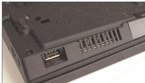
La posición de la rejilla de ventilación, junto a uno de los puertos USB, resulta poco acertada, pues es fácil taponarla al trabajar con el X23 sobre las piernas.
