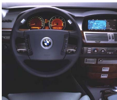
Éste es el aspecto que presenta el cuadro de mandos del serie 7. En el apoyabrazos se puede observar el mando que controla el sistema iDrive.
