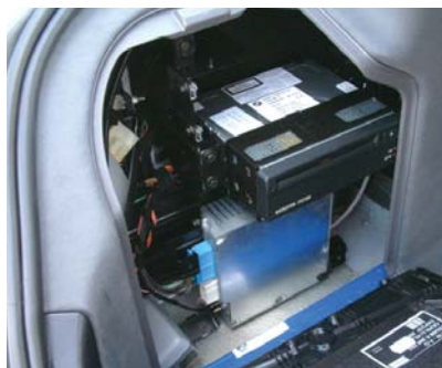
Ambos lados del maletero se sitúa buena parte de la electrónica. En la imagen se ve el lector DVD, el navegador y su correspondiente sistema de navegación.
