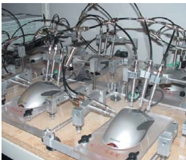
Este ingenioso artefacto es el encargado de verificar la resistencia y durabilidad de los botones de los ratones que utilizamos.
