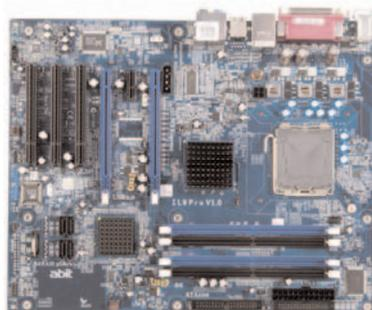
LPT. Tiene, también, una ranura de expansión PCI-E X1, tres PCI convencionales y dos PCI Express X16 para conectar tarjetas RAID o de televisión, por ejemplo. Cuatro conectores Serial ATA de 3 Gbytes/s y un conector IDE Ultra DMA 100/66/33 en un tamaño de 305 x 244 mm completan las prestaciones de esta placa base cuyo precio es de **88 euros**.
