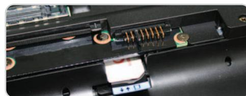
Como en la mayoría de los modelos, la SIM se aloja en el espacio de la batería. La antena del 3G, en cambio, se sitúa en uno de los laterales de la pantalla TFT.
