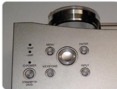
Desde los controles del panel alojado en el chasis de la máquina podemos manejar la mayor parte de los parámetros de funcionamiento del proyector.
