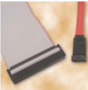
En esta imagen se puede comparar el tamaño del cable y el conector entre la clásica interfaz IDE y la nueva Serial ATA.
