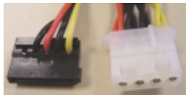
Las diferencias de tamaño entre el nuevo conector de alimentación (de 3,3 voltios) y el clásico (de 5 y 12 voltios) son más que evidentes.
