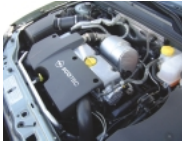
El motor 2.2 DTI del Vectra ofrece una potencia de 125 CV, apoyados por un par motor de 280 Nm.
