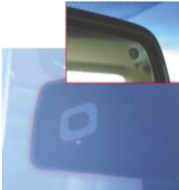
Este es un detalle del sensor de lluvia por infrarrojos que se encuentra en el parabrisas, y el de antideslumbramiento ubicado en el retrovisor interior.
