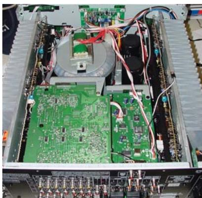
Esta instantánea muestra el aspecto interno de un receptor A/V convencional. Destaca especialmente el impresionante volumen del transformador toroidal, elemento caracterizado por la ausencia de distorsión de onda así como por la prácticamente despreciable dispersión del campo magnético y magnetoestricción en el núcleo.
