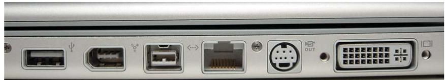
El lado derecho del PowerBook muestra los siguientes puertos (de izquierda a derecha): USB, FireWire 400, FireWire 800, Ethernet 1000Base-T, salida Y/C (S-VHS) y video DVI.
