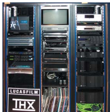
Un sistema de sonido extraordinario. El tercer aparato (desde arriba) por de la columna derecha es el ecualizador digital THX de JBL, el Synthesis SDEC-2500A.
