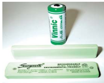
Las pilas tipo «chicle» son una versión distinta de las baterías AA recargables de Ni-MH.
