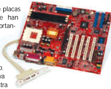
No obstante, ésta no es la única característica destacable de este producto. La K7T266 Pro2 integra la popular controladora RAID Promise 20265R, un útil sistema de detección de errores al que han bautizado como D-Bracket y una eficaz utilidad apodada Fuzzy Logic 3, que permite manipular los parámetros de forzado del «micro», memoria y buses desde el sistema operativo, entre otras características.
