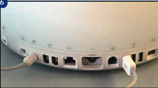
Los cuartos traseros del iMac de cerca. De izquierda a derecha: enganche para cable de seguridad de Kensington, mini-jack estéreo para auriculares, jack para altavoces Harman/Kardon, dos puertos FireWire en dos
