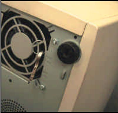
En la imagen podemos apreciar la cerradura de seguridad de un equipo HP Vectra que impide, una vez cerrada, la apertura de la carcasa del PC.
