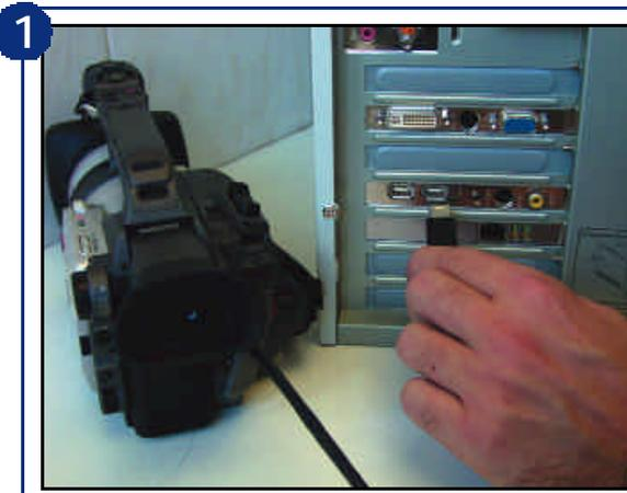
El primer paso consiste en enlazar la cámara al PC mediante el FireWire. Una vez conectados, ambos extremos, nos disponeremos a encender la cámara en modo VCR. Al activar este modo, el Windows XP detectará un nuevo dispositivo de captura de imágenes y lo configurará automáticamente, dándonos la posibilidad de utilizar Movie Maker para realizar el tratamiento digital. No obstante, vamos a abrir en su lugar Studio 7 de Pinnacle, si no lo habríamos hecho ya.
