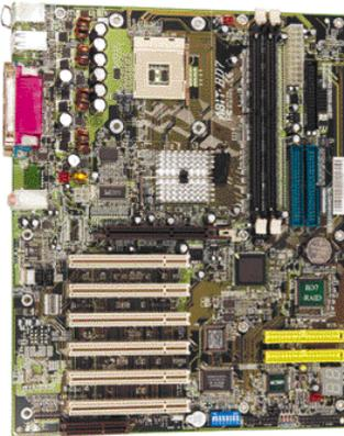
Por otra parte, sobre la propia placa encontramos un indicador digital que, utilizando códigos hexadecimales, nos indica su estado en cada momento de proceso de arranque, de modo que resulte fácil iden-
