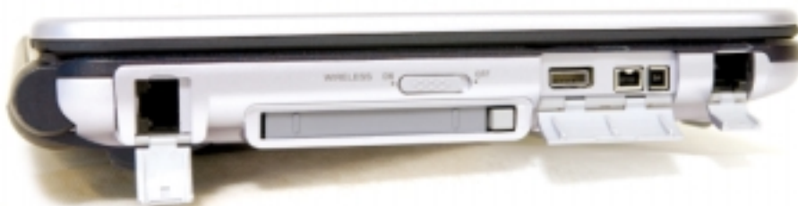
Casi todas las conexiones están protegidas por varias tapas para impedir la entrada de elementos extraños.
