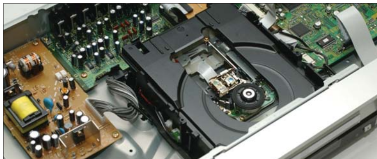
El láser ha de tener una reducida longitud de onda para leer con precisión las hendiduras de las capas de grabación de los discos usados en AOD y Blu-ray Disc.
