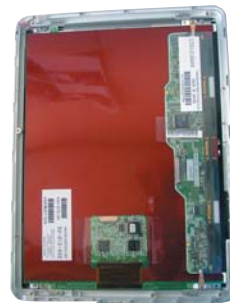
En la imagen se ve parte de la circuitería de una pantalla de Tablet PC y parte de la que emplea el sistema que detecta los movimientos del «lápiz»
