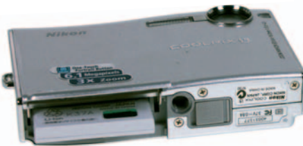
La elección entre pilas convencionales o baterías de ión-litio como sistema de almacenamiento sigue siendo contradictoria. Como se puede apreciar, albergar en el cuerpo las pilas necesarias hace que el grosor de la cámara aumente, mientras que el cuerpo de los modelos con batería suele ser más estrecho.
