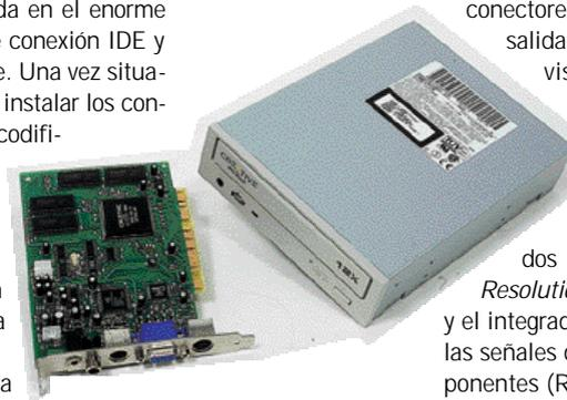
dirigirse, mediante uno de los cables que se incluyen, a la propia descompresora. Asimismo, en uno de los laterales se encuentran los conectores típicos para entrada y salida de vídeo hacia un televisor convencional, así como un enchufe S/PDIF para la extracción del audio digital.
