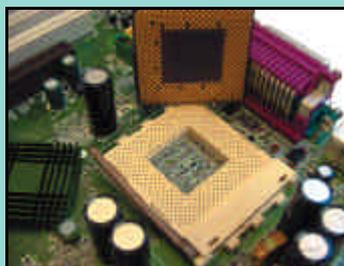
Sobre el Socket A se puede observar la distribución irregular de los terminales del «micro».
