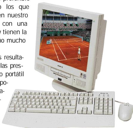
jeta gráfica ATI Rage LT. Ésta, si bien cuenta con aceleración 3D (de ahí la consecución con éxito de la prueba 3DMark), con un valor de 595 se sitúa en un nivel bajísimo. De todas formas, estas impresiones no deben sorprendernos, ya que para la inclusión de todos los componentes en el soporte de la pantalla han tenido que emplear con profusión toda la tecnología de portátiles; de ahí sus limitaciones.
