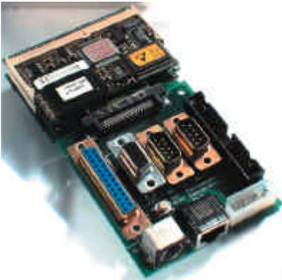
El MatchBox PC es impresionante. En el tamaño de una caja de cerillas sus creadores han conseguido meter un completo ordenador.
