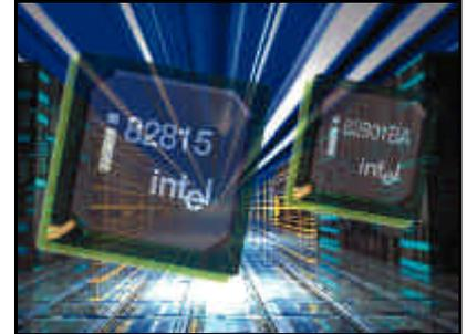
ne una mejora de la versión incluida en el i810. Este controlador es capaz de proporcionar cuatro puertos USB (sólo en la versión 815e), una interfaz de tarjeta de red LAN y hasta seis canales acústicos para la tarjeta de sonido. Este componente ha sido cuidadosamente diseñado para soportar las exigencias multimedia actuales, para lo cual se le ha dotado de la interfaz AC'97 para sonido Dolby Digital en su configuración 5.1 (cinco altavoces y un *subwoofer*).
