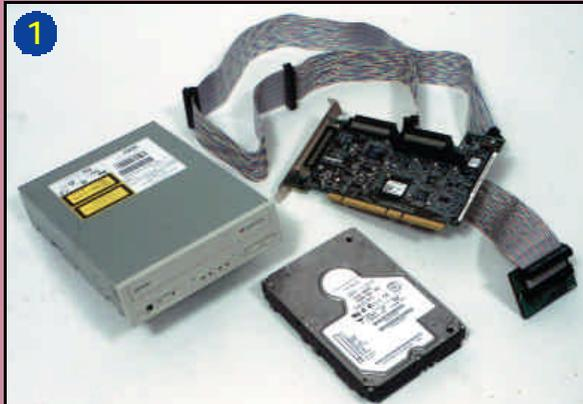
1 En este caso en concreto, vamos a llevar a cabo la instalación de una grabadora y un disco duro. Cada uno de ellos utiliza uno de los dos modos de conexión SCSI que podemos encontrar. Es decir, el disco duro utiliza una conexión de 68
