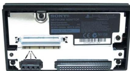
Éste es el aspecto del adaptador Ethernet de la PS2. En la parte delantera, podemos ver el lugar donde se conecta el cable de red, mientras que por detrás cuenta con conexiones para acoplar un disco duro ATA.
