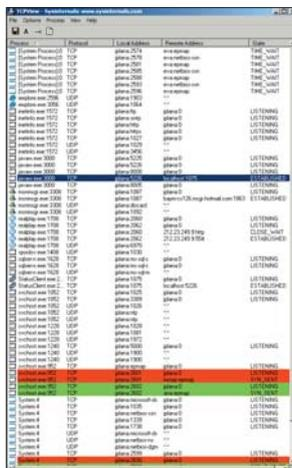
`TCPView` permite tener bajo control los diferentes procesos y las conexiones que realiza en todo momento el PC.
