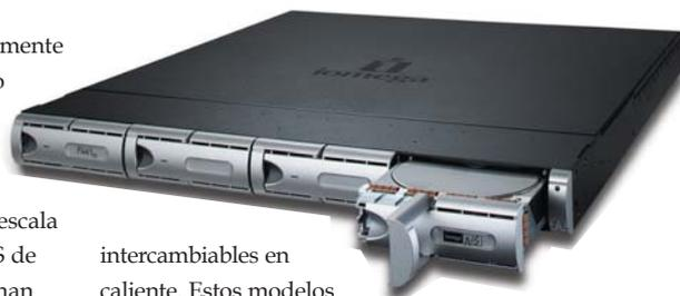
intercambiables en caliente. Estos modelos además cuentan con cuatro ventiladores intercambiables en caliente, doble fuente de alimentación también intercambiable con la máquina funcionando y tres puertos LAN en total. Todas las máquinas incluyen software de alta disponibilidad y *backup* y tienen una sencilla instalación.
