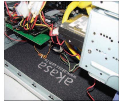
La correcta disposición del cableado facilita el acceso al interior, optimizando a su vez el flujo de aire.
