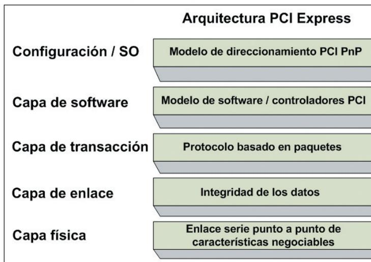
Esquema que muestra la estructura de capas de la arquitectura PCI Express.
