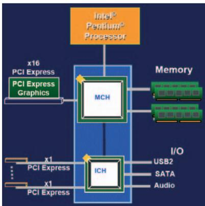
En este diagrama de bloques elaborado por Intel puede apreciarse que la lógica de control del bus PCI Express x16 se aloja en el northbridge del chipset.
