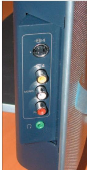
En la imagen se aprecia otro detalle propio de Sony: los conectores S-Vídeo, Video por componentes y auriculares, accesibles fácilmente en cualquier momento desde el lateral del equipo, sobre una pieza escamoteable que nos permite ocultarlos cuando no nos sean necesarios.
