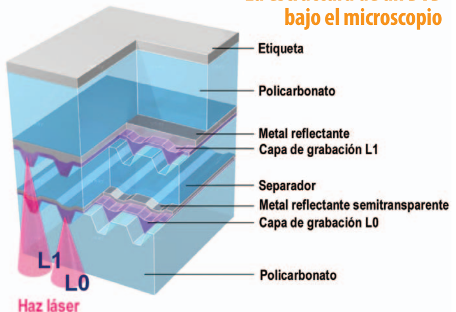
La estructura de los discos de doble capa encierra propiedades de reflexión y transparencia que son la clave de sus funcionalidades.
