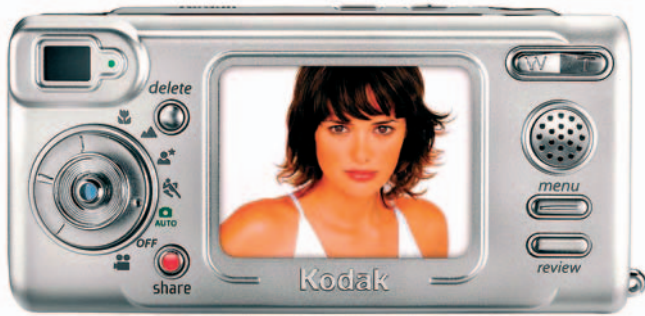
La cámara digital Kodak EasyShare LS633 incorpora un panel OLED (denominado por Kodak NuVue) de 2,2 pulgadas, resultado de su trabajo de investigación con Sanyo.
