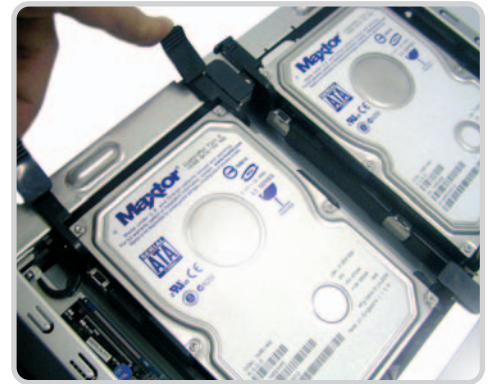
El hecho de tener dos discos duros Serial ATA en la misma caja abre las puertas a posibilidades como montar un RAID por software.
