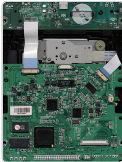
El interior de una regrabadora de este tipo encierra una placa PCB con toda la circuitería necesaria. En la parte baja de la imagen, se puede apreciar que el chip más grande es el responsable de las verdaderas prestaciones de cada unidad.
