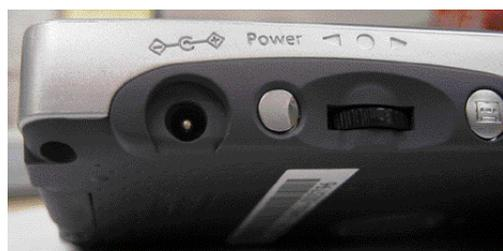
En el lateral dispone del conector para el cargador, la rueda multifunción, el botón de encendido y el de función de grabadora.
