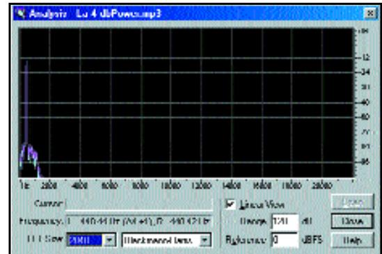
En la prueba de La 4 aparecen los mismos defectos de corte de frecuencias y pérdida de dinámica que en Mpeg 4-Track Mixer.
