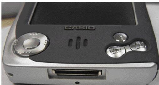
El conector de la parte inferior permite sincronizar el aparato, al tiempo que conectar un cable a nuestro teléfono GSM.
