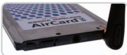
Aquí podemos ver un detalle de la ranura donde se inserta la tarjeta SIM, así como el conector previsto para la conexión de un manos libres.
