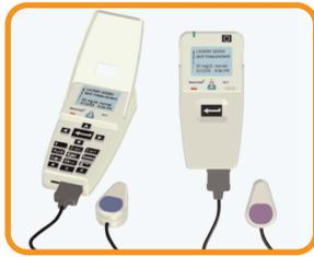
El **GlucoTrack** es un **medidor no invasivo del nivel de glucosa en la sangre**, se aplica mediante un clip a la oreja y combina ultrasonidos, conductividad y calor. Puede compartirse hasta por tres usuarios, cada uno con su dispositivo. Aunque sólo es un prototipo, las pruebas de la fase 2 comenzarán próximamente en Israel, EE UU y España.
