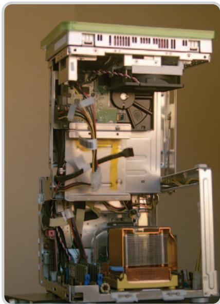
Acceder al interior de una máquina compacta no tiene que ser complicado. El MrMicro i630 cuenta con un hábil sistema mecánico que abre completamente la carcasa.
