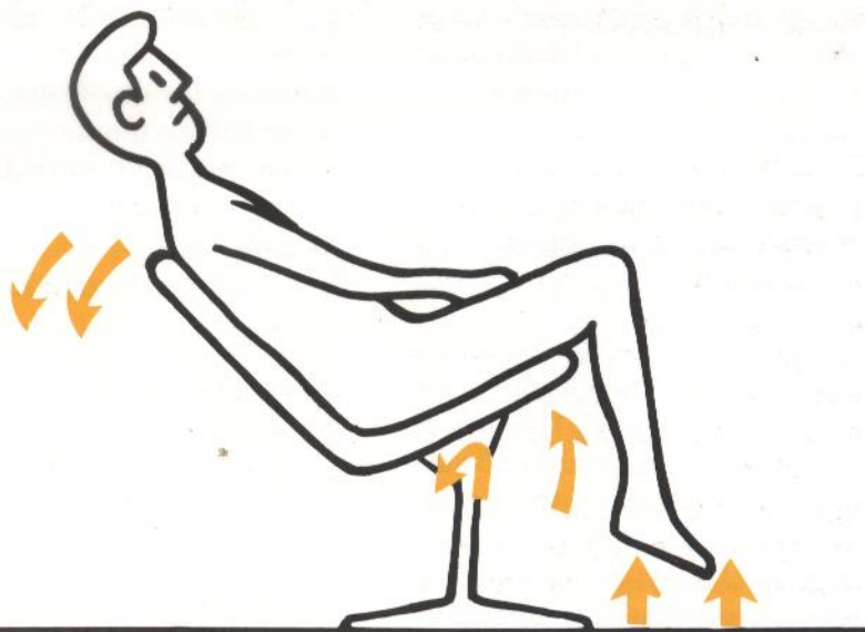
Fig. 9.17. Cuando el eje de giro de la inclinación del asiento no está en su borde delantero los pies pierden el contacto con el suelo en las posturas más posteriores.
