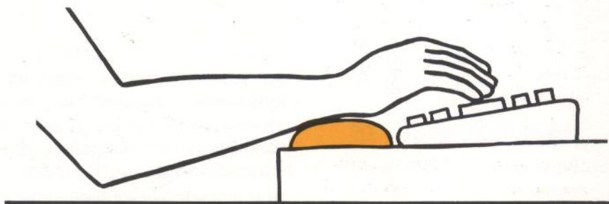
Fig. 9.24. En algunos casos es aconsejable utilizar un reposamuñecas para evitar las posturas extremas de dichas articulaciones.
