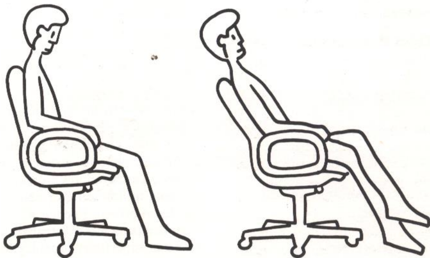
Fig. 9.5. Ajuste dinámico de la silla a las variaciones de postura del usuario.
