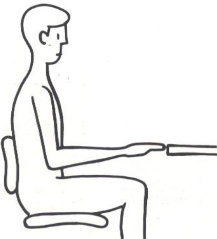
Fig. 9.11. La altura de la mesa debe quedar aproximadamente a nivel del codo.
