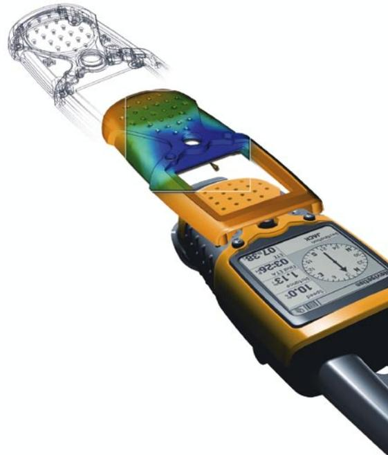
Simulación de inyección de carcasa plástica e imagen de producto final. Fuente: Aplicad.
