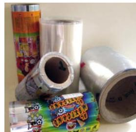
Imagen de productos fabricados por extrusión de lámina plana.
