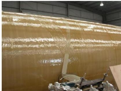
Imágenes de piezas fabricadas por el proceso de bobinado.
