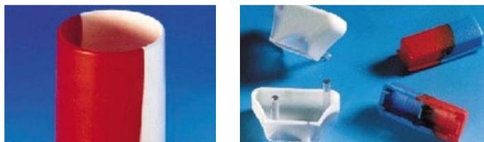
Ejemplos de piezas fabricadas por bi-inyección.
