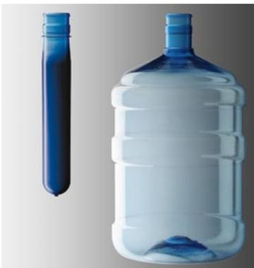
El material más utilizado en este proceso es el PET para la fabricación de envases como botellas y envases para distintos productos, ya sea para alimentación, limpieza, etc.
