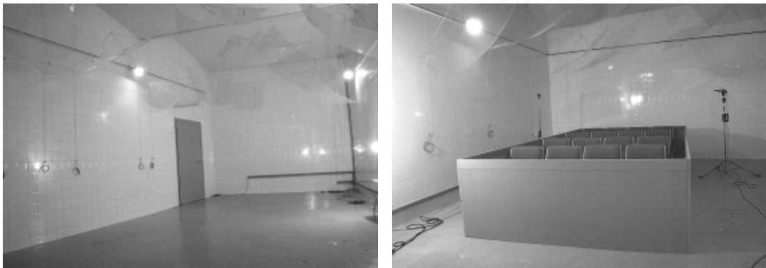
Fig. 2.1 Cámara reverberante del laboratorio de acústica del Departamento de Teoría de la Señal y Comunicaciones, Universidad Politécnica de Cataluña (Barcelona, España) y montaje típico de un conjunto de sillas para la medida de sus coeficientes de absorción
