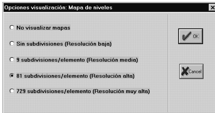
Fig. 7.42 Pantalla correspondiente a la elección del grado de resolución en la visualización de los mapas de niveles
