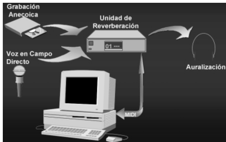
Fig. 7.49 Elementos integrantes del sistema de auralización basado en la unidad de reverberación Roland R-880
