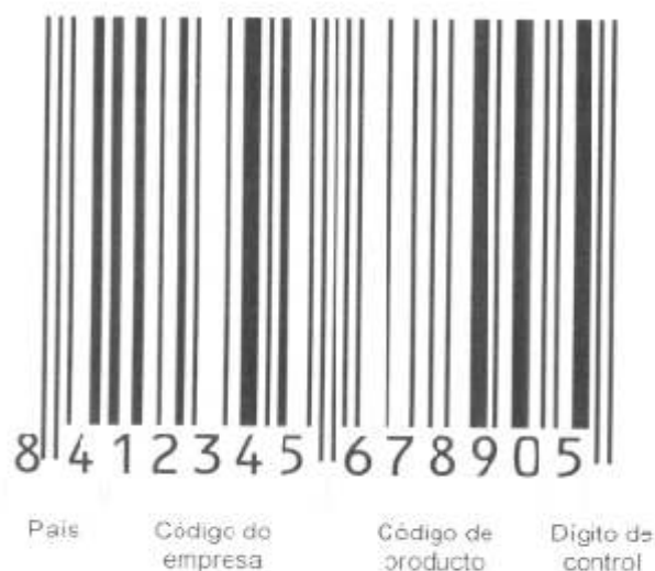
Fig. 10: Composición del código de barras
