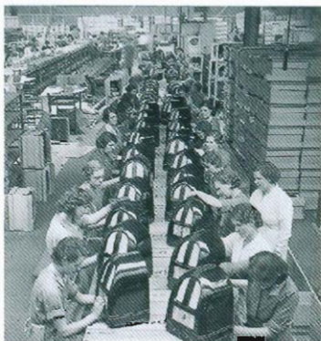
Trabajadores colocando las últimas piezas de la radio Model 444 (bautizada después People's Set ) en la fábrica de Philco en Perivale, 1936.
