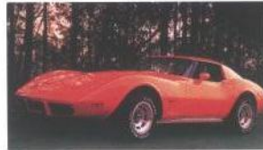
Si el techo estorba se puede retirar en dos mitades, como en este modelo de 1974.
