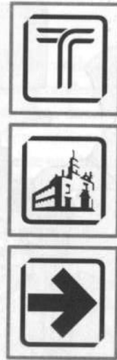
Figura 3.9. La señalización es un ejemplo de las adecuaciones sensoriales, en cuanto a la visibilidad; las señales fueron diseñadas, para verse tanto de día como de noche, ya sea por los altos contrastes de sus colores o por el material del que están elaboradas, ya que con la iluminación de los automóviles resaltan en la oscuridad de la carretera.
