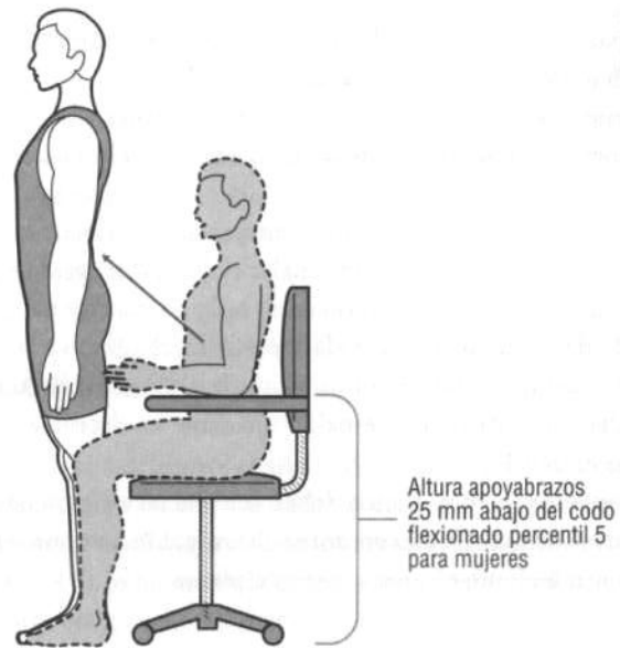
Figura 3.3. En este gráfico se muestra la altura estándar de un apoyabrazos en las sillas de trabajos. Este debe encontrarse 25 mm abajo del codo flexionado, ya que es de gran ayuda para el usuario al sentarse o pararse.
