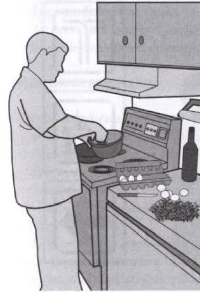
Figura 3.7. Las adecuaciones siempre conjuntan varios tipos. En este caso, una adecuación antropométrica, la altura de la estufa, también implica una adecuación biomecánica, al facilitar al usuario una postura adecuada que no provoque estrés en las articulaciones.
