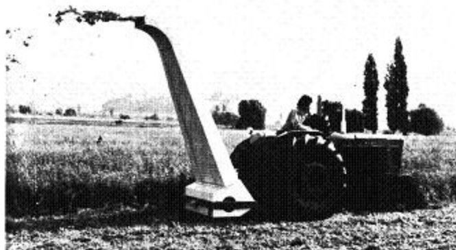
Segadora para forraje. Chopper (Chile, 1973) Máquina con un largo eyector, durante la cosecha (sin remolque)
