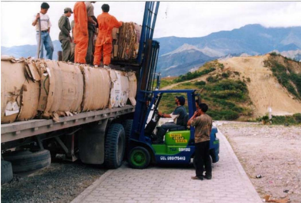
Para superponer los bultos o cargarles a un trailer, una volqueta o un camión, se pueden utilizar los mismos equipos con los cuales se realiza el transporte interno. El Dibujo 29 muestra el proceso de carga.
