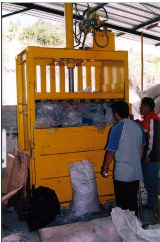
Dibujo 24: Prensa hidráulica
