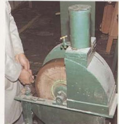
botado o gastado). Las muelas se mueven con una manivela o con un motor eléctrico y consisten en una piedra circular, natural o artificial.
