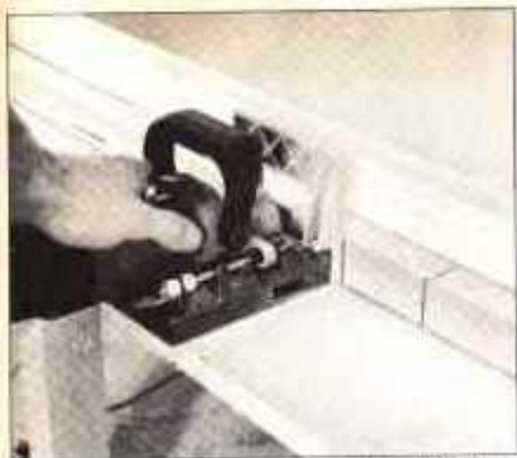
Una forma de unir los componentes del tablero es con una herramienta para fiadores de placa. Se coloca fuera del banco de trabajo para cortar ranuras concavas donde insertar cuñas hechas
