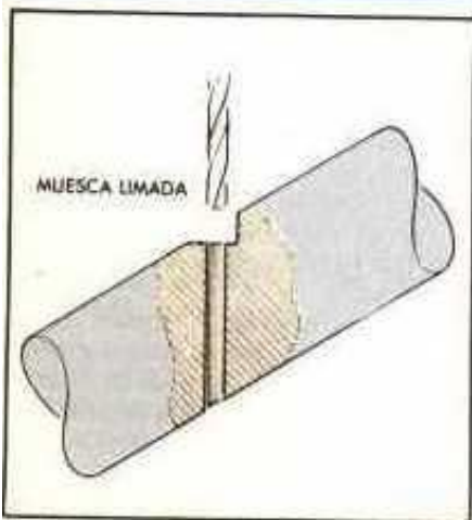
Cuando se lima o se corta una muesca en una barra con un lado perpendicular al eje del agujero, se tiene una superficie plana para la broca. Esta técnica es buena si la apariencia final no es importante. Una marca de punzón y el uso de una broca ofrecen un medio más exacto para iniciar la perforación
