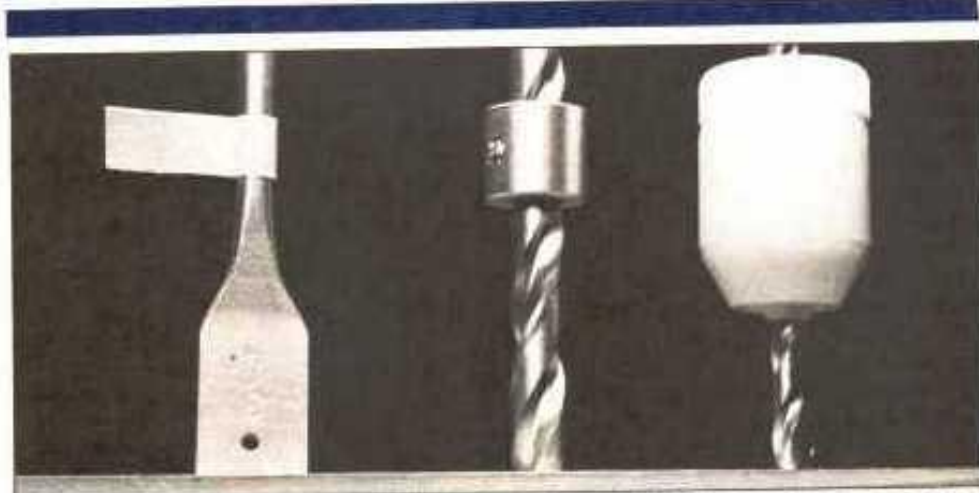
Tres formas para controlar la profundidad de una perforación son (de izquierda a derecha): una sencilla banderilla de cinta de encubrir; un collar metálico que actúa como tope de profundidad; más un collar de tipo ajustable para brocas con diámetros desde 0.15 hasta 0.635 cm (1/16 hasta 1/4")
