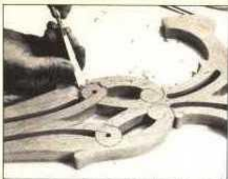
7 Use una gubia para hacer cortes traseros de poca profundidad hasta las líneas de los cortes de tope, pero procurando no astillar la madera
