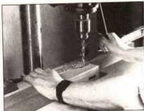
8. Fije una guía con abrazaderas al banco del taladro y haga agujeros trasiapados de 0.95 cm (3/8") de diámetro para las mortajas de las patas
