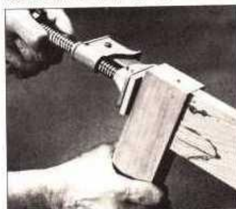
Este conjunto se abrió cuando se aplicó presión con una abrazadera. La razón: que se utilizó la varilla de espiga sin estrias ni ranuras y además una cantidad excesiva de cola (observe la foto)
