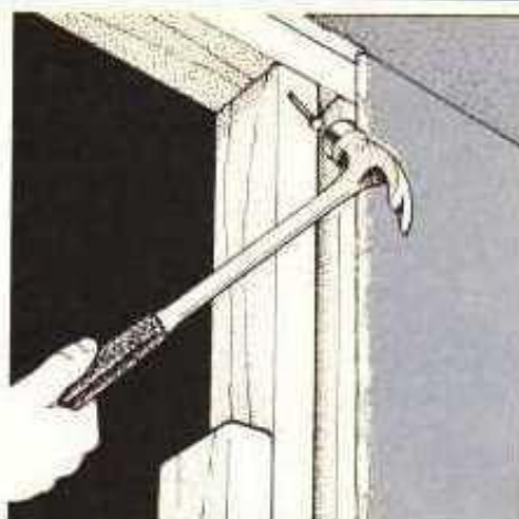
2 Arme el poste corto clavando un montante corto a otro montante común, a la altura debida. Fije el poste con un clavo oblicuo a las soleras
