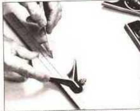
Marque el centro de piezas redondas utilizando el cabezal localizador. Asegure el cabezal a la regla apretando el perno de cierre moleteado
