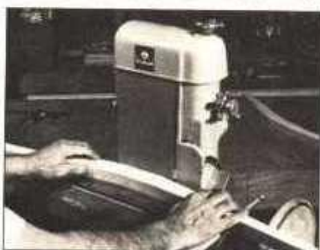
11 Lije el área donde los rieles laterales se unen a las patas y déjela plana. Verifique que la mesa de la lijadora quede perpendicular con la cinta
