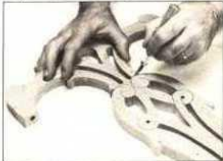
6 Marque los detalles del respaldar tallado con una cuchilla afilada. Estos cortes separarán las superficies realzadas de las áreas a bajo relieve
