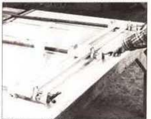
9 Primero corte todas las piezas del faldón delantero y las caras de la gaveta de una sola tabla. Luego ya puede comenzar a armar el faldón delantero con cola y con pasadores de espiga
