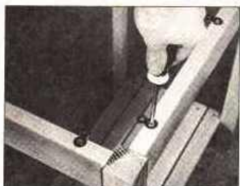
Fije los fladores del tablero a los faldones, usando tornillos de cabeza plana No. 8 de 1.59 cm (5/8"). Note cómo las mortajas de los fladores se cruzan con los bordes interiores de los faldones
