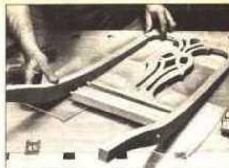
20 Comience el armado final fijando el barrote al respaldar. A continuación, pase a instalar una pata trasera, el riel trasero y por fin la otra pata
