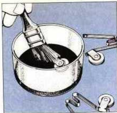
7. Lave los rodillos con espíritus minerales. Después de secarlos bien, lubríquelos con un aceite liviano para que se muevan con suavidad
