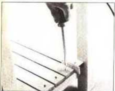
Una las tabillas a largueros con tornillos introducidos en agujeros de guía abocardados. Use un bloque de madera de 0.64 cm (1/4") de espesor para mantener un espaciado uniforme
