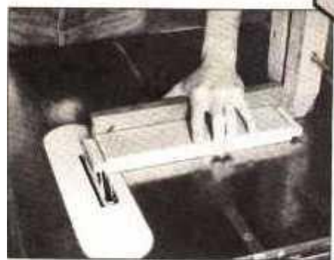
Corte las espigas de los faldones en la sierra de banco, usando cuchillas ranuradoras. El cartabón de inglete actúa como bloque de tope para hacer con una gran exactitud cortes repetidos
