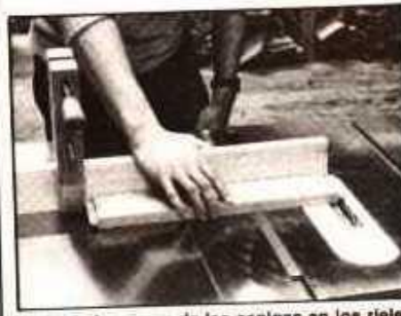
2. Corte las caras de las espigas en los rieles con la cuchilla ranuradora. Un bloque de tope en el cartabón de ingletes asegura cortes exactos
