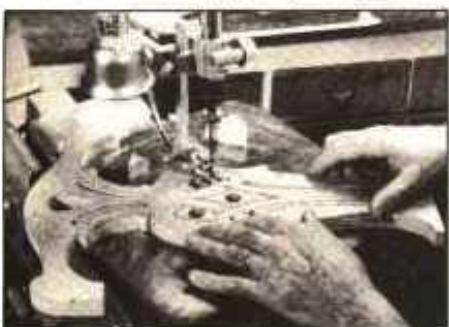
4 La sierra caladora es el medio más fácil y exacto de formar los recortes en el respaldar del asiento. Unos agujeros dan acceso a la cuchilla
