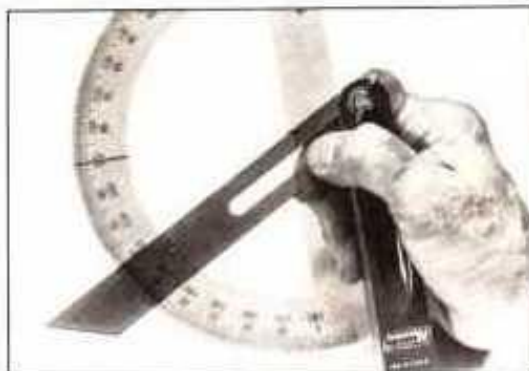
Con ayuda del transportador ajuste la regla T al ángulo deseado. Sujete la herramienta de forma que su hoja quede bien alineada con el eje central del transportador.
