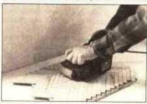
Después de pegar todas las tiras cuidadosamente a la base, alíselas con una lijadora de banda. Luego recorte el panel a su tamaño final
