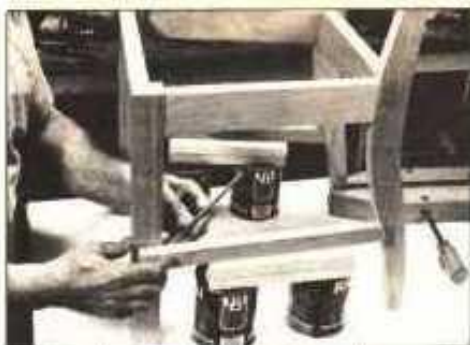
19 Arme los componentes de la silla y marque los largueros laterales para un ajuste perfecto. Levante los largueros a una altura de 15 cm (6")
