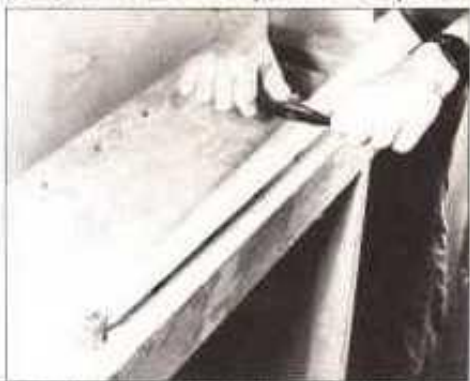
8 Con la pata que ya está firmemente asegurada entre dos perros del banco, utilice un bastrén para poder formar un bisel ligero en la esquina exterior de forma curva, como puede observar
