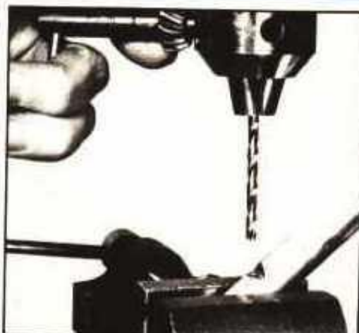
Cuando se lima o se corta una muesca en una barra con un lado perpendicular al eje del agujero, se tiene una superficie plana para la broca. Esta técnica es buena si la apariencia final no es importante. Una marca de punzón y el uso de una broca ofrecen un medio más exacto para iniciar la perforación
