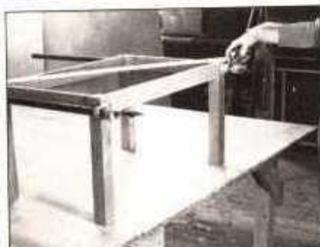
11. Arme la base de la mesa, encolando primero las patas a los faldones largos. Luego encole y fije los faldones cortos con unas abrazaderas
