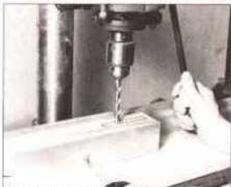
5 Forme las mortajas de las patas, perforando primero una serie de agujeros traslapados de 0.95 cm (3/8") de diámetro. Más tarde instale una guía para ubicar el trabajo de manera precisa
