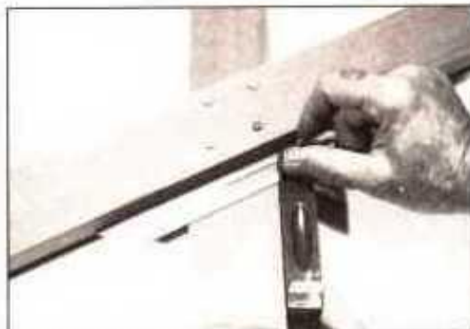
Para transferir un ángulo existente, afloje la hoja y deslice la herramienta contra el ángulo. Luego apriete la tuerca mariposa para que la hoja quede inmovilizada.
