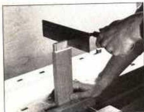
10. Cuando corte las caras de las espigas de los faldones, recorte los hombros con una sierra de cola de milano. Revise el ajuste en las mortajas
