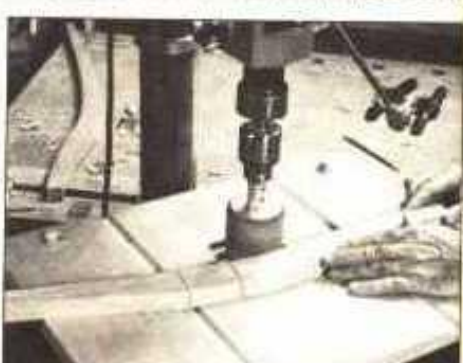
12 Alise bien las patas traseras con un tambor lijador instalado en un taladro de banco. Una lijadora portátil de cinta también podría usarse
