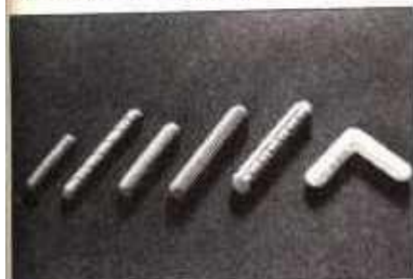
Los pasadores de espiga de madera dura tienen una superficie con estrias o con ranuras espirales. La espiga de plástico de ángulo recto a la extrema derecha es para las juntas de inglete
