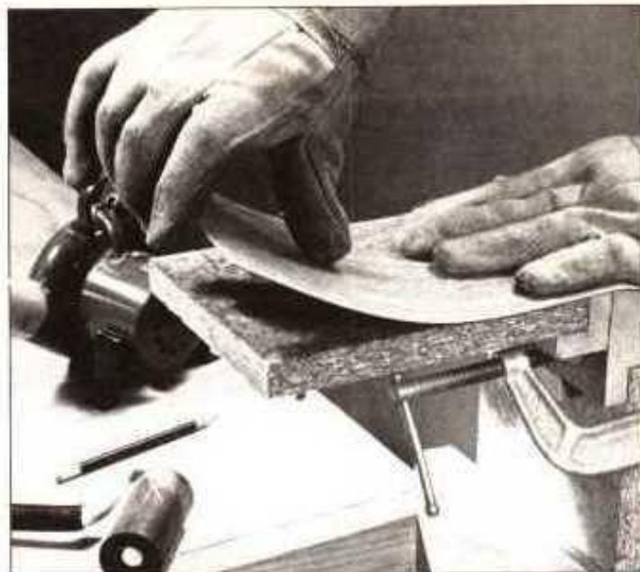
Después de doblar la lámina alrededor del radio, sujétela bien hasta que se enfríe el cemento de contacto. Un bloque de madera asegurado con abrazaderas impide que la lámina se aice si el calor ablandara el adhesivo
