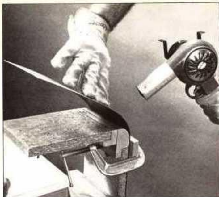
Doble la lámina de tipo vertical a un radio de 3.8 cm (1 1/2") con una pistola de calor. Aplique calor a una temperatura de 183° C (325° F). El exceso de calor produciría ampollas en la cara de la lámina (use guantes térmicos)
