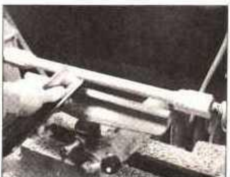
Forme el toallero a un diámetro de 3.17 cm (1-1/4") en el torno, usando roble rojo igual al del resto de la mesa. Lije la barra para alisarla y córtela a su largo correcto en la sierra de banco
