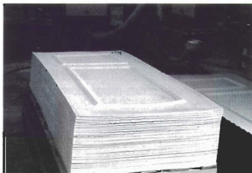
Paramentos para puerta 'molded' con tablero de partículas especial
