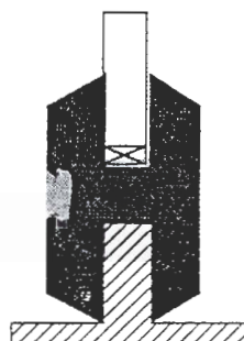
Junta estructural en forma de H
