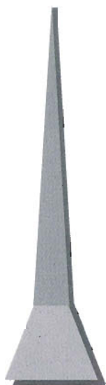
Clavo de fijación del herraje al bastidor (siglo XVII)
