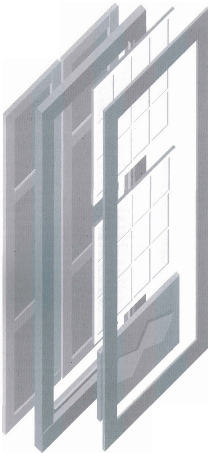
Sucesión de elementos en ventanas de guillotina
