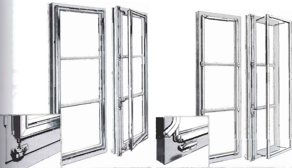
Vidrio adosado con marco de caucho, aluminio o plástico
