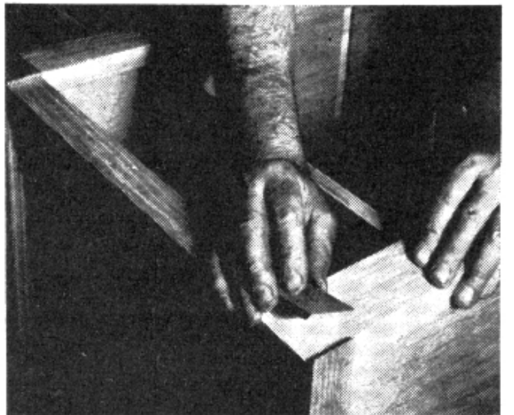
FIG. 6: Use cola y clavillos para fijar los bloques de zócalo a inglete a las esquinas inferiores. Para detalles vea Fig. 2A.
