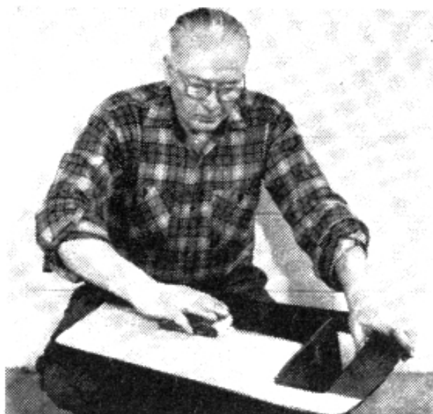
Fig. 10. Para eliminar marcas de brocha o de soldaduras, lije ligeramente la superficie asegurándose de que lo hace en la misma dirección de la veta de la madera.
