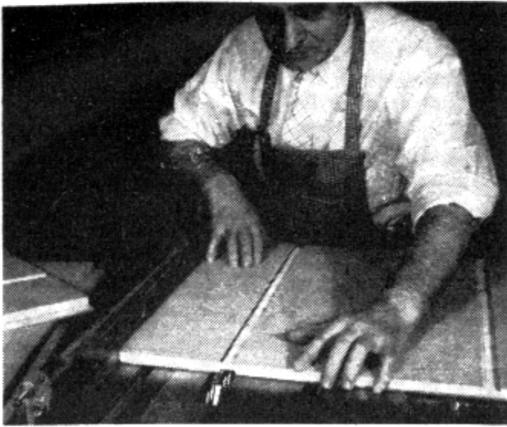
FIG. 3: Corte de ranuras en divisiones y lados para sostener las repisas. Se hacen de madera terciada de abeto de \frac{3}{4} ".
