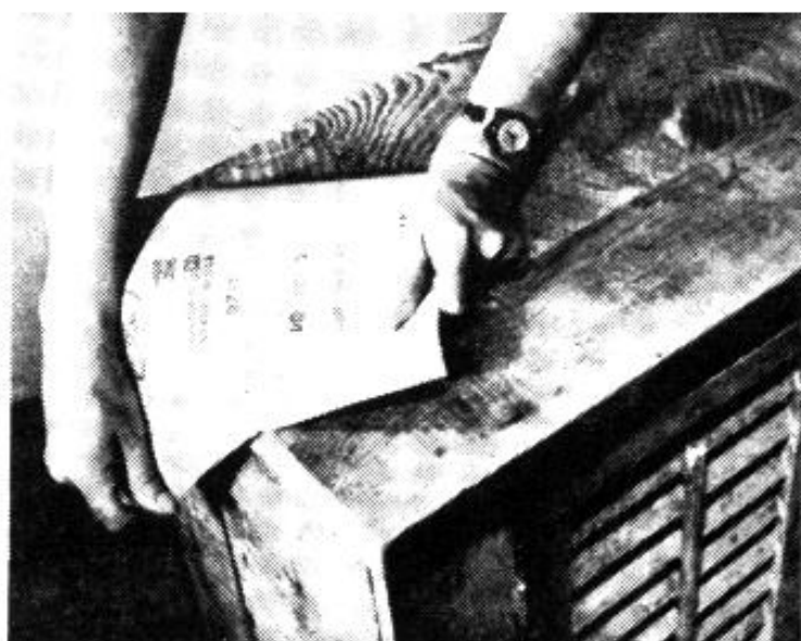
Fig. 2. — Redondee las esquinas y los bordes con papel de lija para simular mejor así el desgaste natural debido al tiempo.
