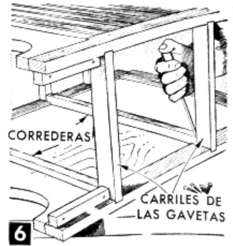
Las correderas de las gavetas descansan en el área desocupada de las mortajas de los carriles de las gavetas, y de los marcos.
