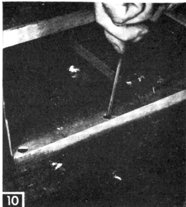
Atornillando el bastidor superior desbastado (izquierda) al panel lateral y (derecha), invertido, al tablero de la mesa.
