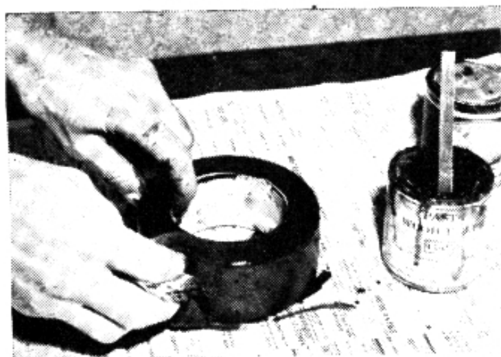
Fig. 9: Una mezcla de pasta y tintura se usa para tupir el grano de la madera, se deja secar y se frota hasta que quede pulida.
