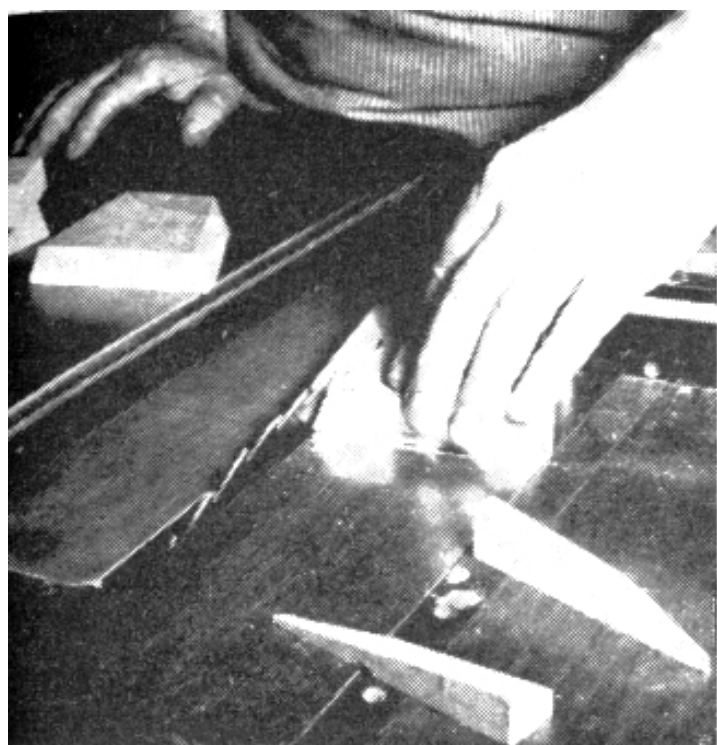
FIG. 1: Ahúse y bisele los lados de las piezas que forman la base octagonal.
