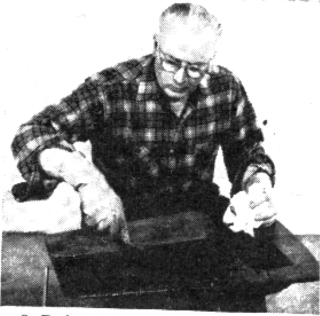
Fig. 3. Deje que la superficie seque bien y lije con papel fino. Recuerde lijar sólo con el grano. Después proceda a pulir toda la superficie con un papel de lija muy fino.
