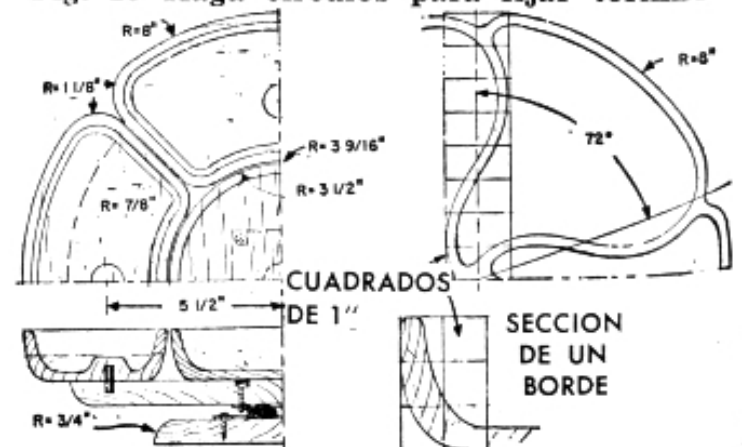
Fig. 11: Detalles de una bandeja giratoria
