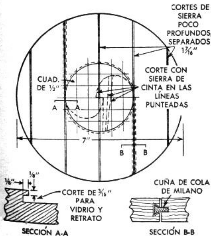
Monte el marco en el torno y socave el borde del "pozo" central para alojar al vidrio y la foto
