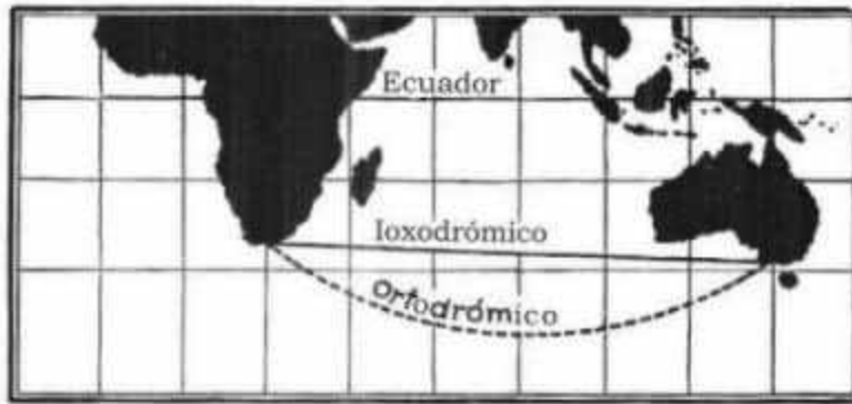
Figura 1. Las cartas náuticas no designan el camino más corto del Cabo de Buena Esperanza a la punta sur de Australia por una línea recta ("loxodrómica") sino por una curva ("ortodrómica").
