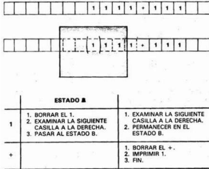
Figura 47. Máquina de Turing capaz de efectuar adiciones
