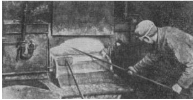
Figura 33.3 Horno para fundir mineral de wolframio
