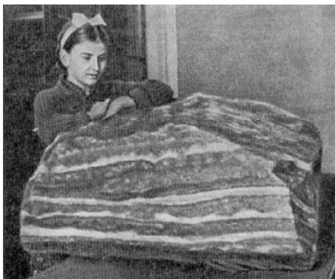
Figura 15.7 Silvinita, roca compuesta por capas de silvita y halita. Yacimiento de Solikamsk
