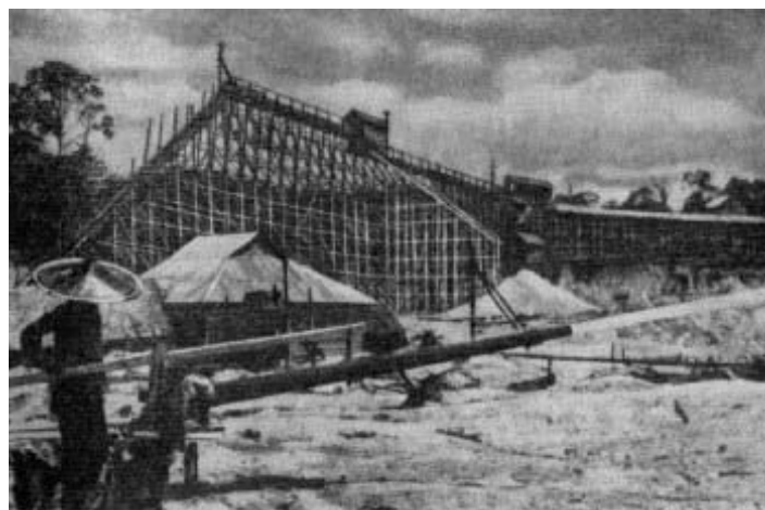
Figura 18.4 Depósitos de arenas estanníferas en la Península de Itzamal. La masa mineral se lava con hidromonitores (lanzas de agua). El barro líquido obtenido se hace escurrir por zanjas especiales. Placer de Iogore-Bagrú (año 1940)
