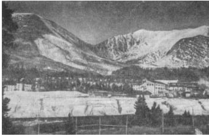
Figura 33.8 Yacimiento de molibdeno en Climax (montañas del Colorado). Aquí el molibdeno se halla formando capas en la masa de granito. A la derecha se ve una fábrica de enriquecimiento.
