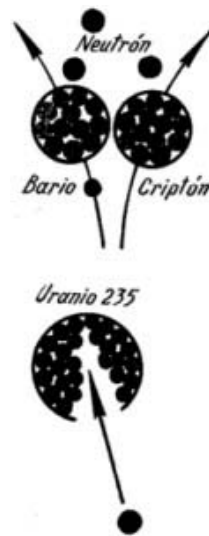
Figura 8.4 Destrucción del átomo de uranio por medio de neutrones lentos
