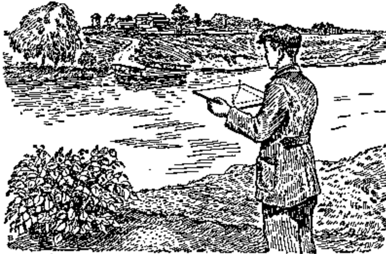
Figura 25. Medición de la anchura de un río con el aparato de alfileres
