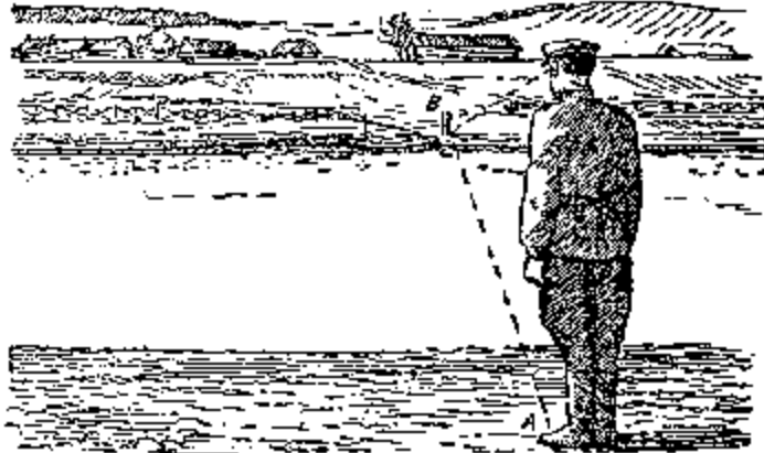
Figura 32. Por debajo de una visera deberemos notar un punto en la orilla apuesta.
