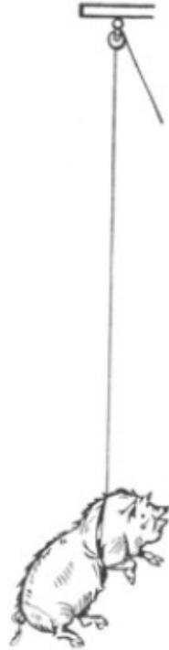
*Figura 48. Un cable de acero de cromo-níquel aguanta una carga de 200 kg por  $mm^2$*
