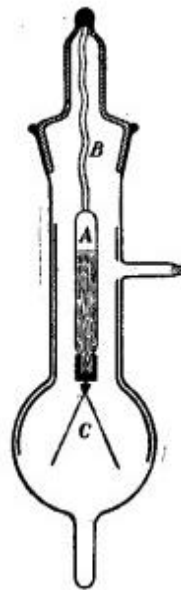
Figura 100. Reloj de radio con "cuerda casi perpetua" para 1.600 años.
