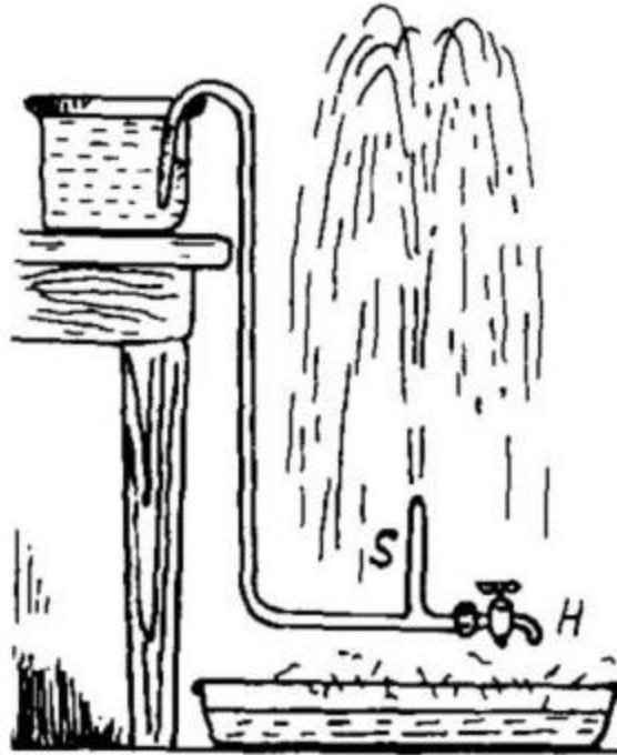
Experimento que ilustra el golpe hidráulico.
