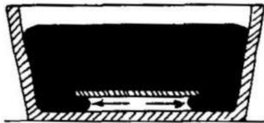
El mercurio no penetra por debajo de la lámina aplicada al fondo
