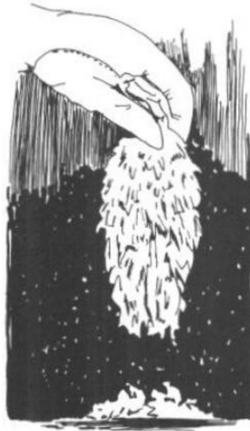
Figura 99. El anhídrido carbónico congelado forma una masa parecida a la nieve; después de prensarla se obtiene «hielo seco»
