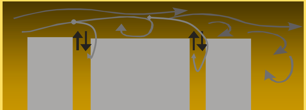
Variaciones de las isoclinas de presiones dinámicas unitarias sobre la envolvente de un volumen en dependencia de la dirección del viento
