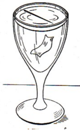
Figura 61. La aguja flotando en el agua. Arriba corte de la aguja (de 2 mm de diámetro) y forma exacta de la concavidad que se forma en la superficie del agua (aumentada en 2 veces). Abajo, procedimiento para hacer flotar la aguja por medio de un trozo de papel.
