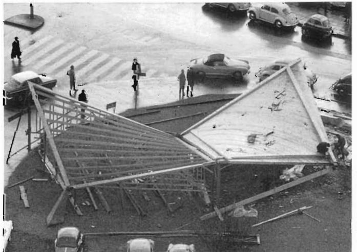
Cubierta en «cascaron» formando un paraboloides hiperbólico. Experimento para la Escuela Técnica Superior de Stuttgart. Proyecto de Curt Siegel; colaborador, Francisco Krauss. Producido por Karl Kübler AG, Göppingen. (Fotografía: cátedra de Estática y Construcción Industrial de la T.H. Stuttgart.)
