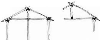
tejado de cabios con armadura autorresistente mediante postes enterrados (empotrados)
