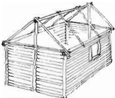
construcción en bloque, con paredes resistentes empleando mimbres
