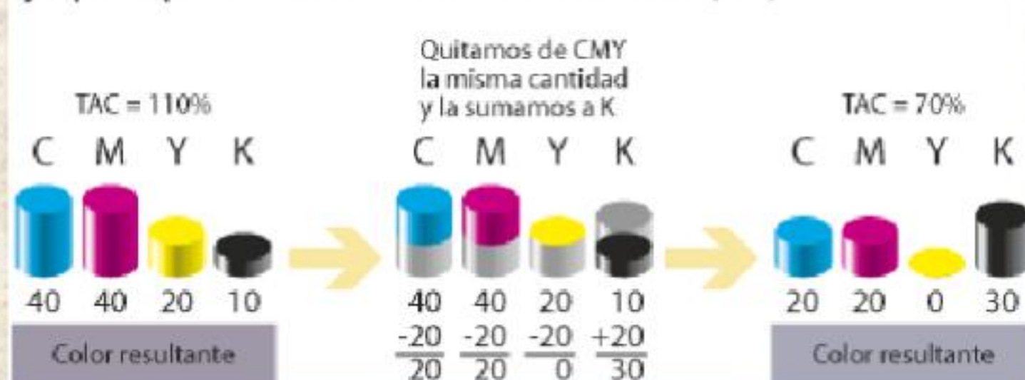
Ejemplo simplificado de reducción de cobertura de tinta (TAC)
