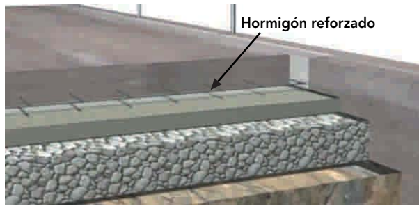
Figura 8 - 57: Colocación del hormigón que ha sido reforzado por la malla electrosoldada de 4.3 mm de espesor.
