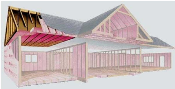
Figura 14 - 4: Lana de vidrio como aislación térmica en el complejo de techumbre.
