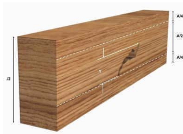
Figura 1- 49: Medición de bolsillo de corteza y/o resina en la zona central de la pieza.
