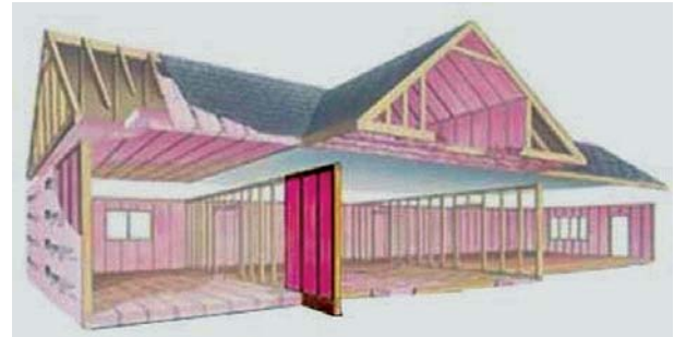
Figura 14 - 5: Lana de vidrio como aislación térmica en tabiques.
