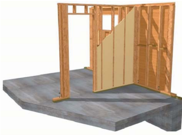
Figura 14-81: Vista entramado y revestimiento estructural de tabiques.
