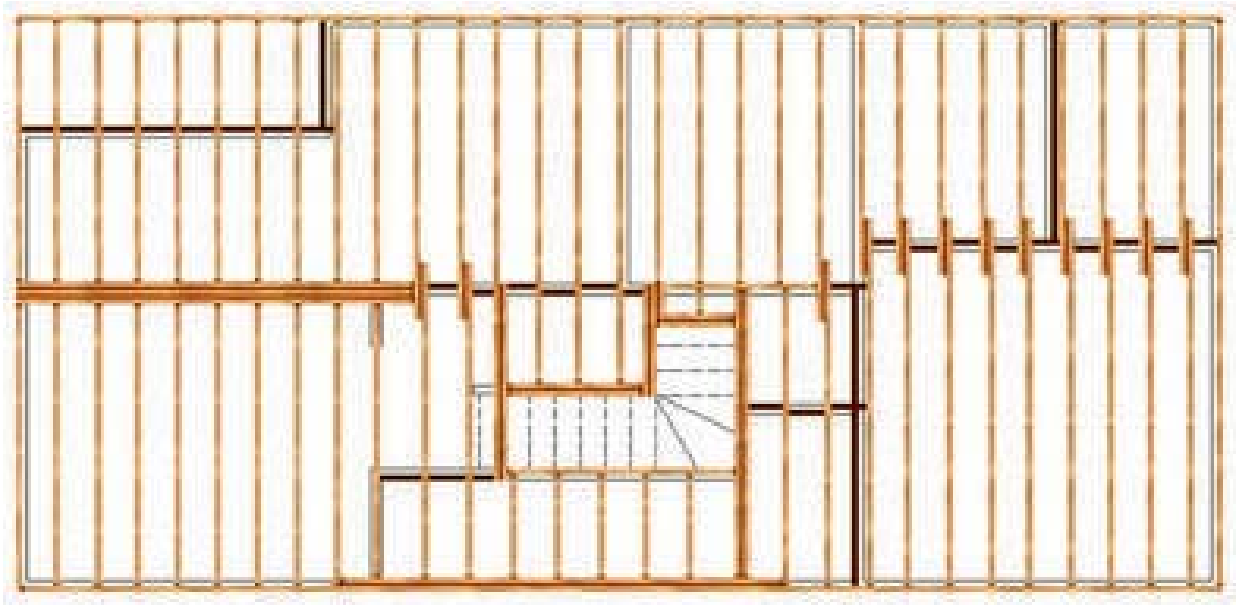
Figura 15 - 20: Etapa 3, colocación y fijación de vigas cortafuego sobre tabiques paralelos y ortogonales a vigas secundarias.
