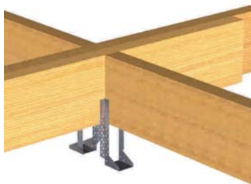
Figura 7-2 : Unión de vigas solucionado mediante colgadores metálicos.
