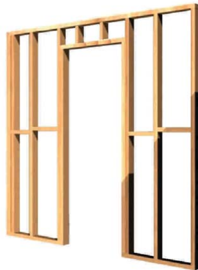
Figura 10 - 3a: Elevación de un tabique autosoportante prefabricado.
