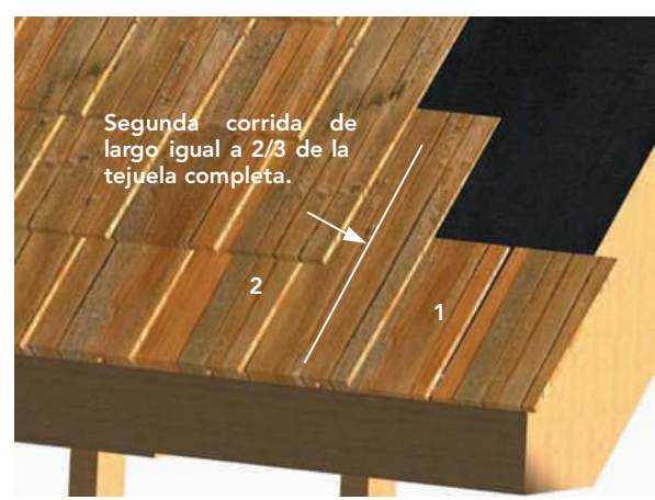
Figura 17-28: Como una forma de proteger el borde del alero, se debe colocar la segunda corrida a plomo con la primera, pero con tejas 1/3 más largas.
