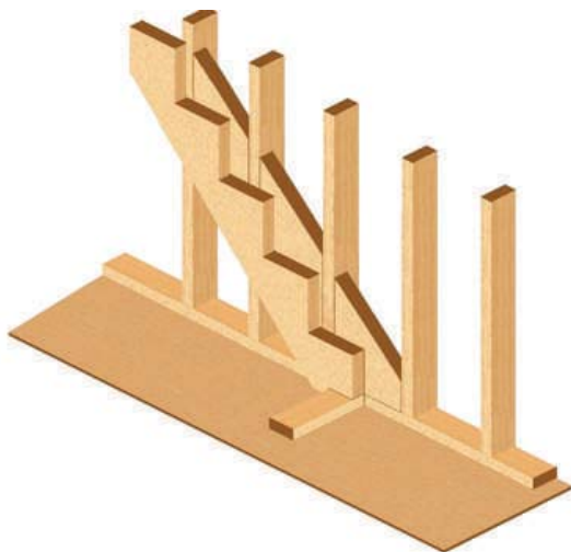
Figura 12 - 25: Colocación de componentes auxiliares para la fijación de los revestimientos y el anclaje de las zancas a la plataforma horizontal.
