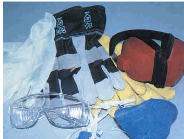
Figura 4 - 7: Diferentes elementos de protección que deben ser usados en obra según el riesgo para ojos, oídos, vías respiratorias y manos, entre otros.
