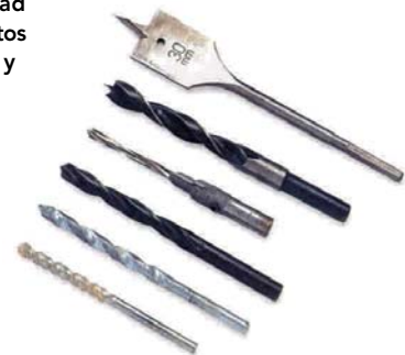
Figura 5 - 25 : Distintos tipos de brocas.
