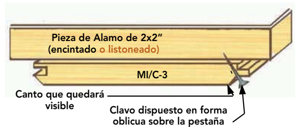
Figura 19-19: Corte que muestra la ubicación del clavo para fijar la moldura cuidando de no dañar el canto que quedará visible.
