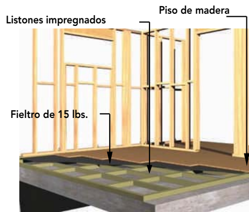
Figura 20 -10: Listones dispuestos formando un reticulado de entre 0,4 m a 0,6 m.
