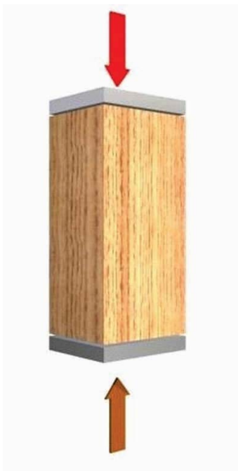
Figura 1 - 29: Esquema de ensayo de compresión paralela a las fibras.
