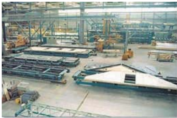
Figura 11-12: Fabricación de cerchas y frontones en planta industrializada.
