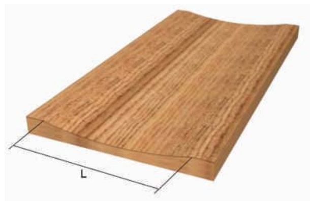
Figura 1 - 57: Depresión por cepillado.
