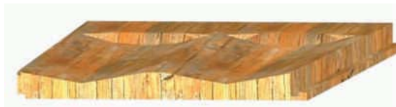
Figura 17 - 10: Tejuela con cortes superficiales.
