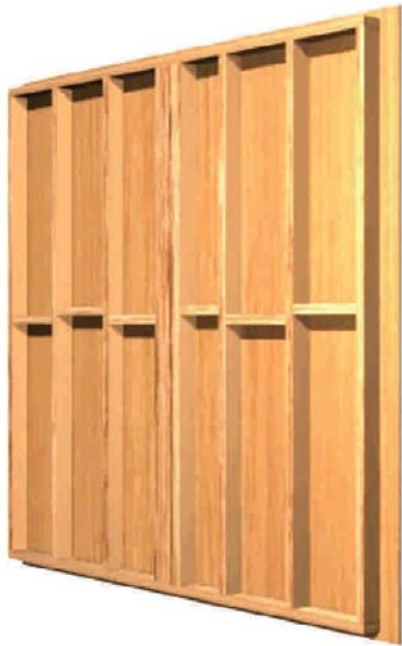
Figura 10 – 2a: Elevación de un tabique soportante de madera prefabricado, cuyo diseño considera como componente arriostrante la utilización de tablero contrachapado o de hebras orientadas (OSB). Vista por el interior.
