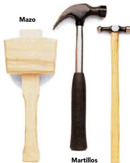
Figura 5 - 28 : Ejemplos de mazo y martillos que se pueden encontrar.
