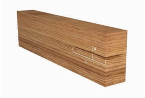
Figura 1 - 50: Forma y medición de una acebolladura.
