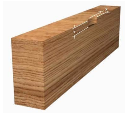
Figura 1- 45: Medición de agujero y/o nudo suelto en la arista.
