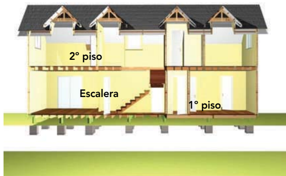
Figura 12 - 1b: Corte longitudinal de la vivienda tipo en que se observa el perfil de la escalera, establecido en el diseño arquitectónico y estructural de la vivienda.
