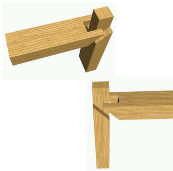
Figura 22 - 11 : Ensamble de quijera con inglete, se diseña en el caso que las caras del marco estén a la vista.
