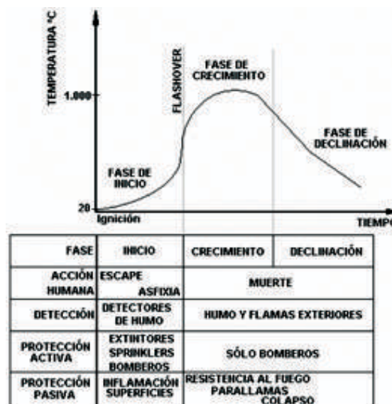
Figura 15 – 2: Gráfico de fases de un incendio.
