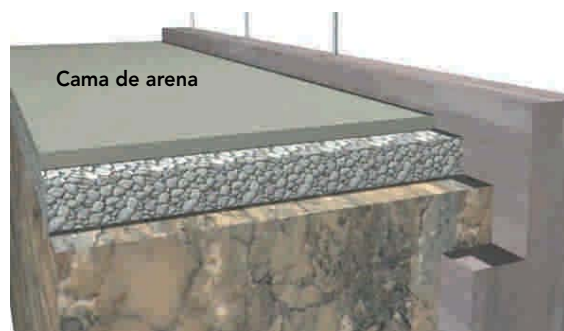
Figura 8 - 54: Colocación de cama de arena sobre el ripio.
