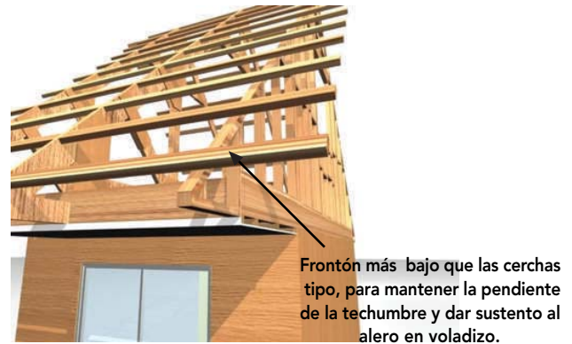
Figura 11-68: Figura que muestra el frontón de una altura menor a las cerchas para generar el alero con las costaneras.
