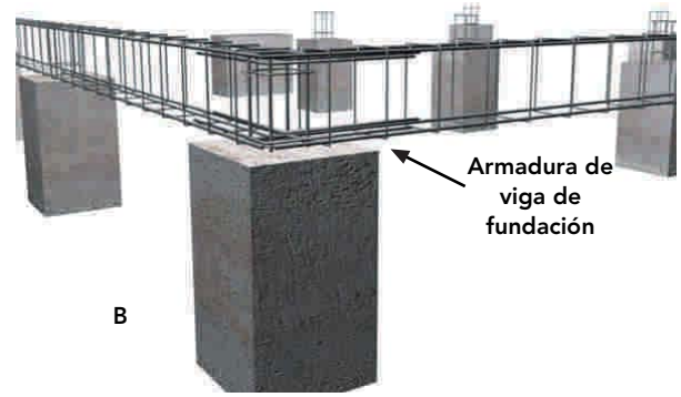
Figura 8 - 40: Vistas (A y B) de la unión entre la armadura del cimiento y la armadura de la viga de fundación y refuerzo de esquina.
