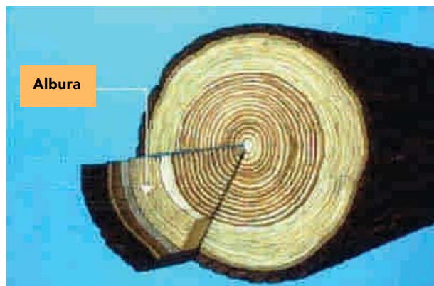
Figura 1-7: La zona al interior del cambium es la albura.
