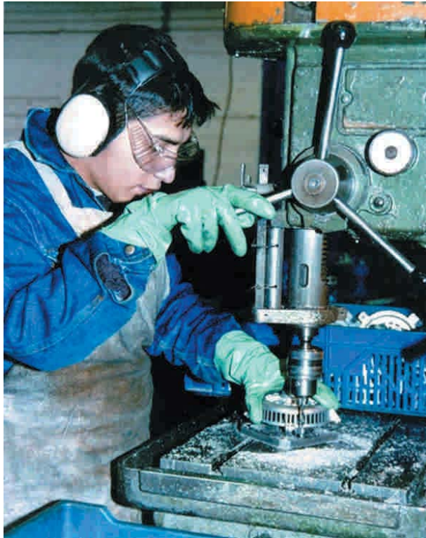
Figura 4 - 5: Trabajador protegiendo sus manos, ojos y oídos con los elementos adecuados de seguridad.
