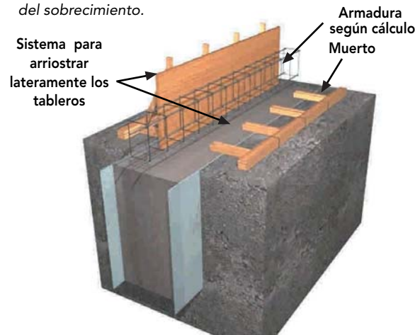
Figura 8 - 30: Instalación de la armadura para el sobrecimiento, en caso que el cálculo así lo indique.
