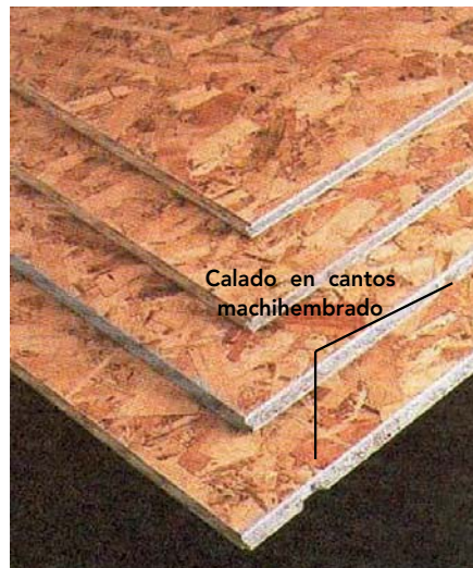
Figura 9 - 17: Tableros de hebras orientadas con cantos machihembrados y calados para eliminación de agua lluvia, en caso de dicho evento durante la instalación.
