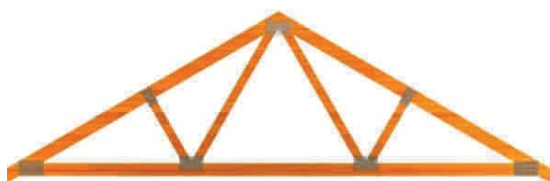
Figura 7- 37: Detalles de unión con placas que deben ir por ambos lados de la cercha.
