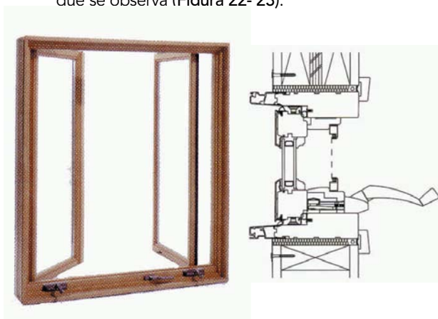
Figura 22 - 23 : Ventana de movimiento giratorio.
