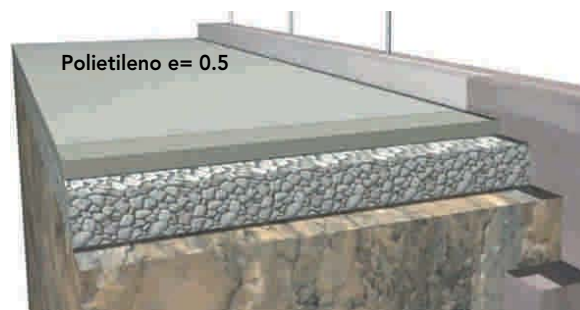
Figura 8 - 55: Instalación de la barrera de humedad, polietileno de e = 0,5 mm.
