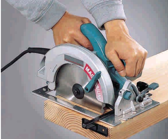
Figura 5 - 34 : Sierra circular eléctrica.
