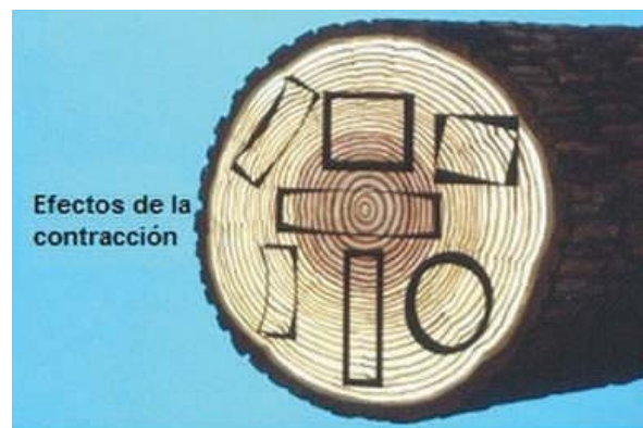
Figura 1-28: Efectos de la contracción en la madera.
