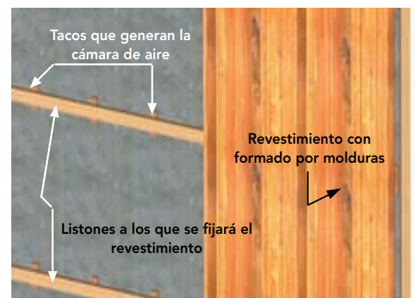
Figura 18 - 41: Instalación del revestimiento dispuesto en forma vertical sobre listones que generan la cámara de aire.
