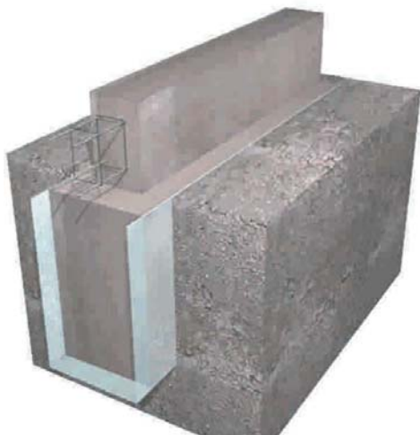
Figura 8 - 23: Sobrecimiento al que se le incorporó armadura de fierro según cálculo. Terreno de fundación es inferior a 2 kg/cm 2 .
