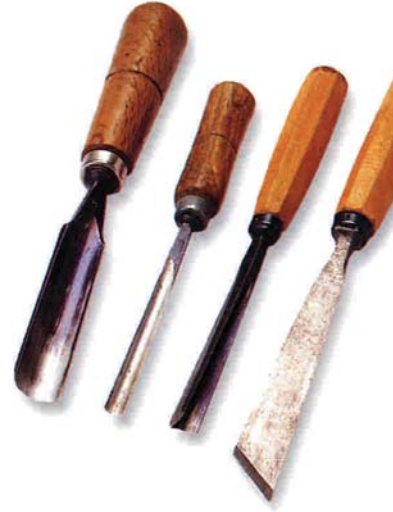
Figura 5 - 18: Distintos tipos de gubias.
