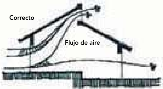
Figura 14 – 53: Incrementar la capacidad de ventilación cruzada.
