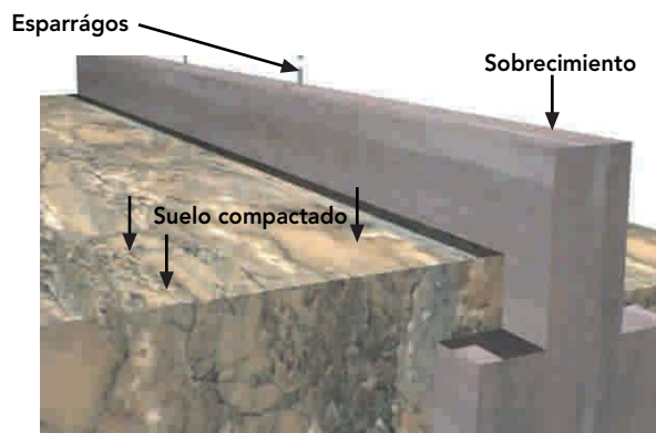
Figura 8 - 52: Rigurosa compactación del suelo, donde se apoya la plataforma de hormigón.
