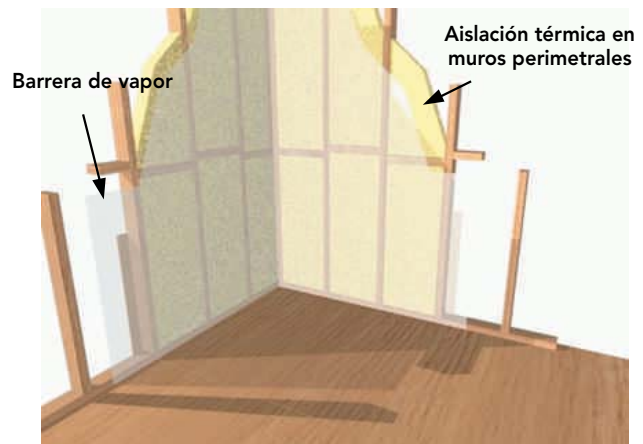
Figura 19-5: Barrera de vapor fijada a la estructura del tabique perimetral, luego de la colocación de la aislación térmica.
