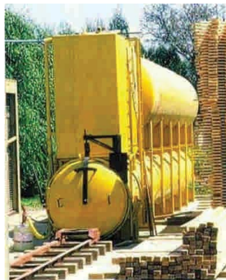
Figura 2 - 21: Planta de tratamiento mediante vacío/presión.
