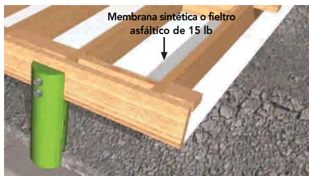
Figura 9 - 19: Instalación de membrana sintética o fieltro asfáltico de 15 libras como barrera de humedad en la plataforma anclada a la fundación aislada.
