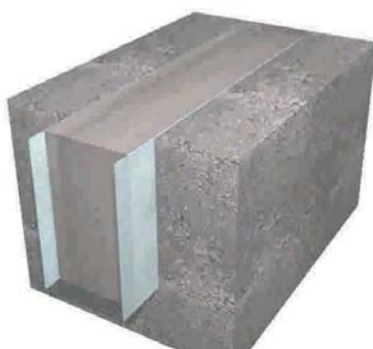
Figura 8 - 26: Cimiento hormigonado de acuerdo a las indicaciones, incorpora un hidrófugo.
