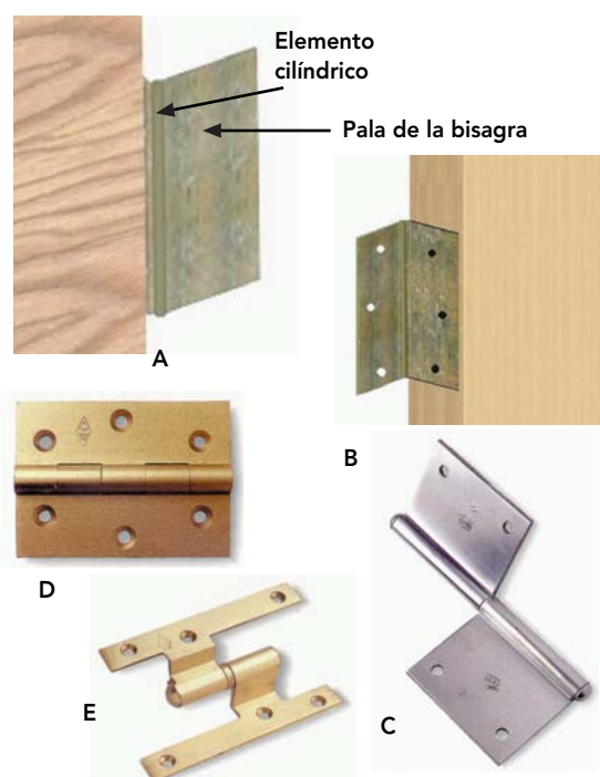
Figura 22 - 15: Diferentes dispositivos de giro aplicable a puertas y ventanas, bisagra pomel (A y B), de clavija (C), bisagra corriente con pasador incorporado (D) y bisagra en H, con pasador menor que las palas, que permite que quede un mayor distanciamiento entre el marco y la hoja de la puerta (E).
