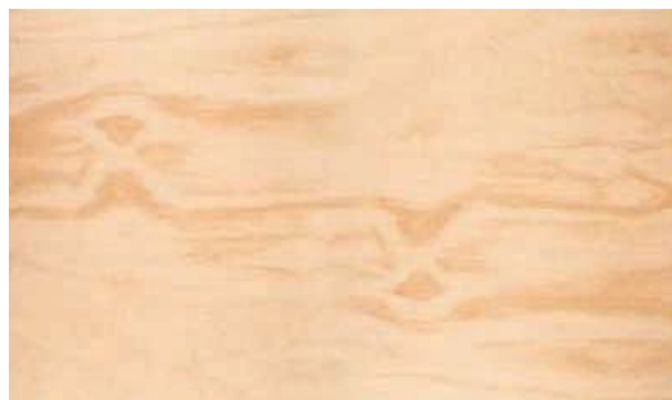
Figura 1 - 83: Tablero contrachapado con grados de cara An/B para confección de moldajes en hormigón, revestimientos interiores, muebles, clóset y elementos decorativos.
