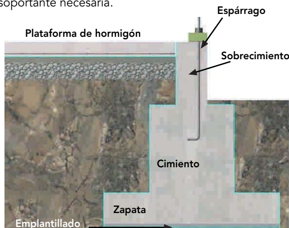
Figura 8 - 8 : Composición de las partes típicas de la fundación superficial, confinada a la plataforma de hormigón, que conforma el piso de la vivienda.
