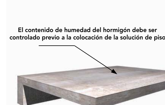
Figura 20-4: Losa de hormigón o radier sobre la cual se instalará un revestimiento de madera.
