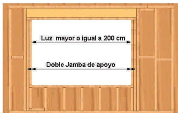
Figura 10 - 13b: Jamba doble en cada costado de un vano cuando éste tiene una luz igual o superior a 200 cm.
