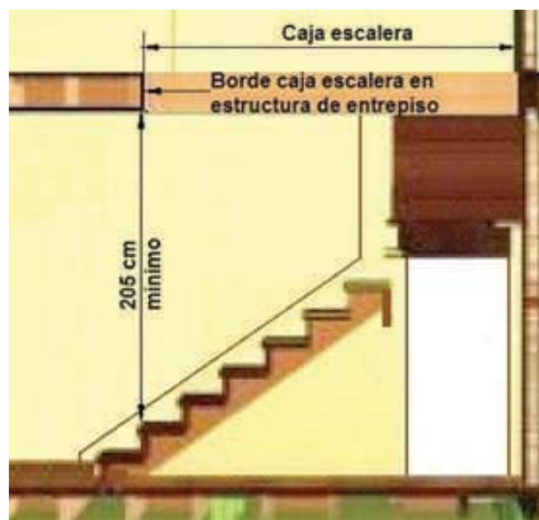
Figura 12 - 21: Altura libre vertical mínima entre huella y cielo raso. También puede considerarse todo elemento superior sobre la cabeza de quien sube o baja por la escalera.
