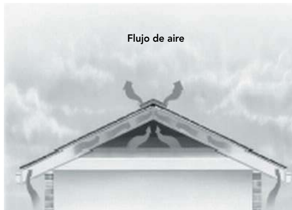
Figura 14 – 55: Ventilación en la estructura de techumbre.
