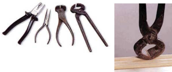
Figura 5 - 30 : Distintos tipos de tenazas.
