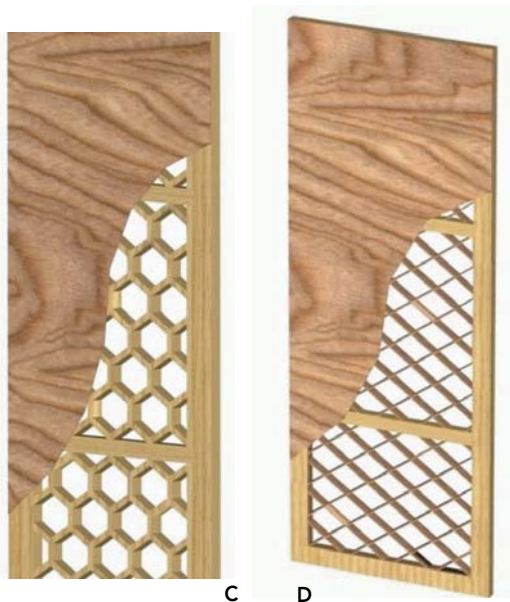
Figura 22-5 : C) Chapas de madera o láminas de plástico conforman el llamado panal de abejas. D) Tablillas de chapa de madera dispuestas en forma rectangular.
