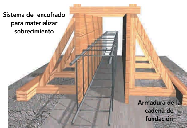
Figura 8 - 31: Control geométrico de la instalación del encofrado del sobrecimiento.
