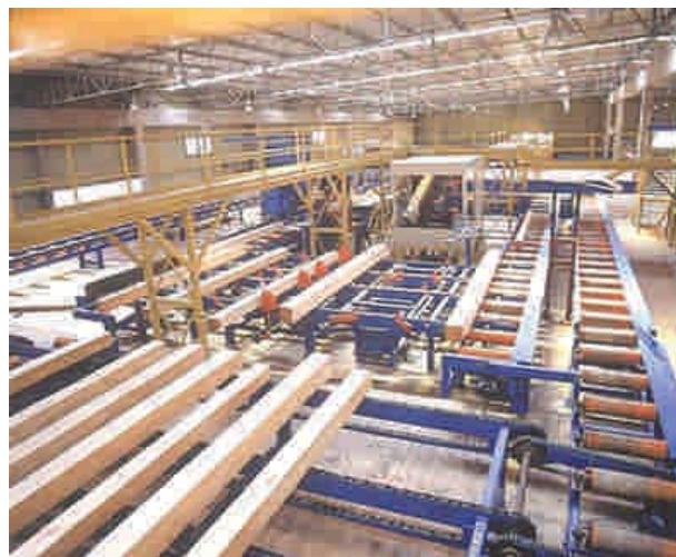
Foto 1 - 16: Aserradero automatizado donde la madera es dimensionada.
