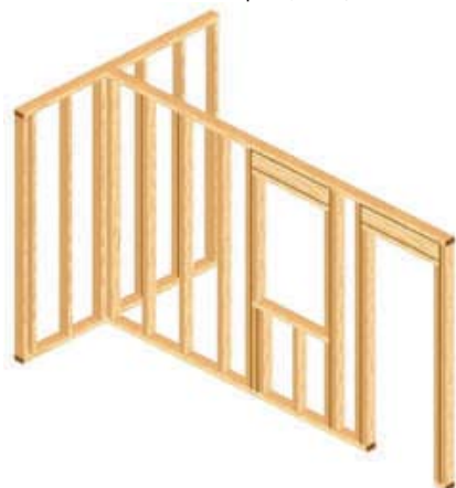
Figura 12 - 22: Tabiques de la estructura vistos desde el interior de la vivienda, en los cuales se apoyará la escalera.
