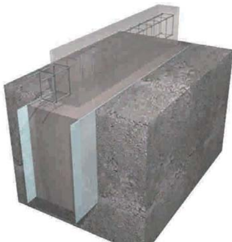
Figura 8 - 32: Fundación continua con sobrecimiento de hormigón armado.
