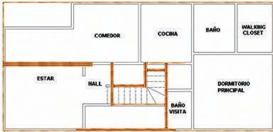
Figura 15 – 18: Etapa 1, montaje del friso y vigas principales en la estructura de entrepiso.
