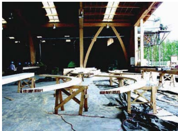
Figura 1 - 94: Vigas curvas de variados radios circulares o de radios compuestos.
