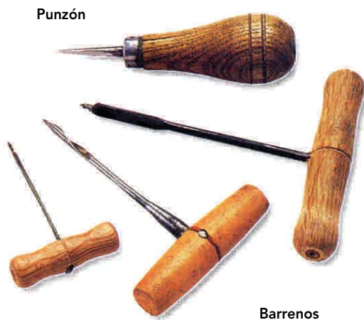
Figura 5 - 23 : Punzón y barrenos.
