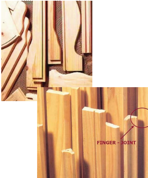
Figuras 1 - 77 y 78: Uniones mediante finger-joint o multidedo: se basan en realizar un dentado y contradentado a la madera, aumentando al máximo la superficie de unión, y por tanto la resistencia de ésta. La tecnología finger-joint se basa en que la unión de las partes se realice mediante la zona lateral de los dedos, por lo que siempre debe quedar un mínimo espacio en la testa de los dedos.
