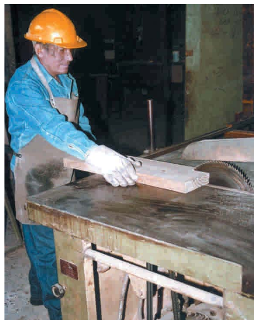
Figura 4-3: Trabajador realizando cortes en la madera en la sierra de banco protegiendo sus manos (guantes), oídos (tapones) y cabeza (casco).
