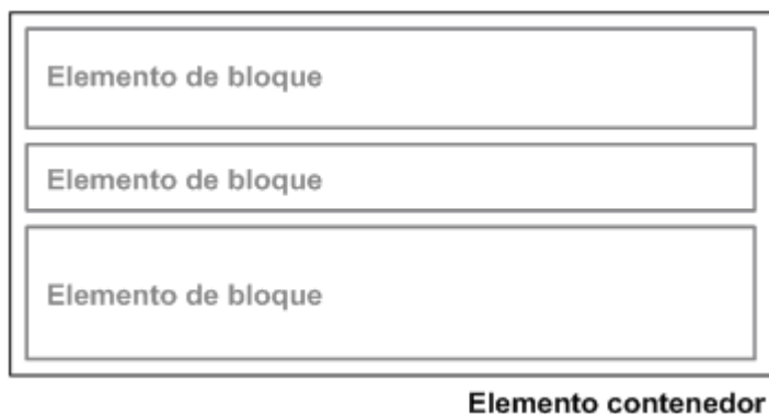
Figura 5.2. Posicionamiento normal de los elementos de bloque
