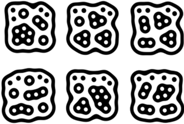
Marcadores fiduciales del sistema Reactivision, utilizados en Reactable Fuente: reactivision.sourceforge.net
