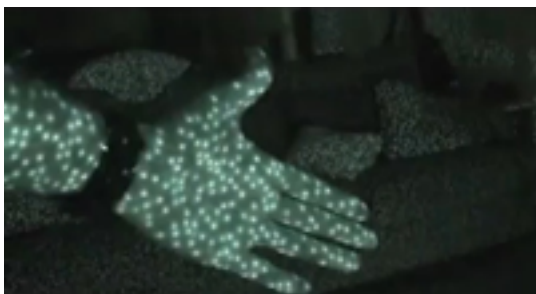
Fotografía infrarroja en la que se muestra la nube de puntos infrarrojos que emite la Kinect para obtener la profundidad de la imagen. Fuente: www.mattcutts.com
