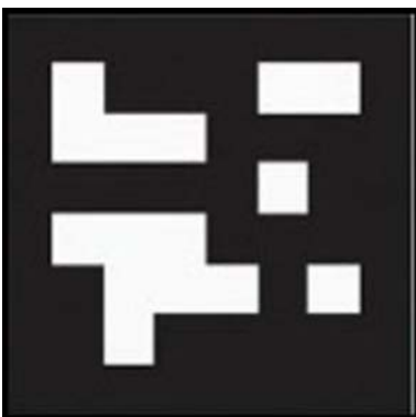
Ejemplo de marcador de un sistema de realidad aumentada
