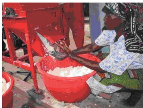
Figura 63 \_\_\_ Rallador de mandioca rediseñado.
