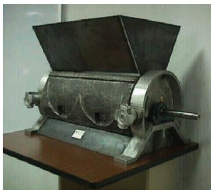
Figura 45 \_\_\_ Concepto y el nuevo despulador de REA.
