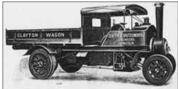
Camión de vapor de 3 toneladas (1,9 m³) empleado en el tiro de áridos
