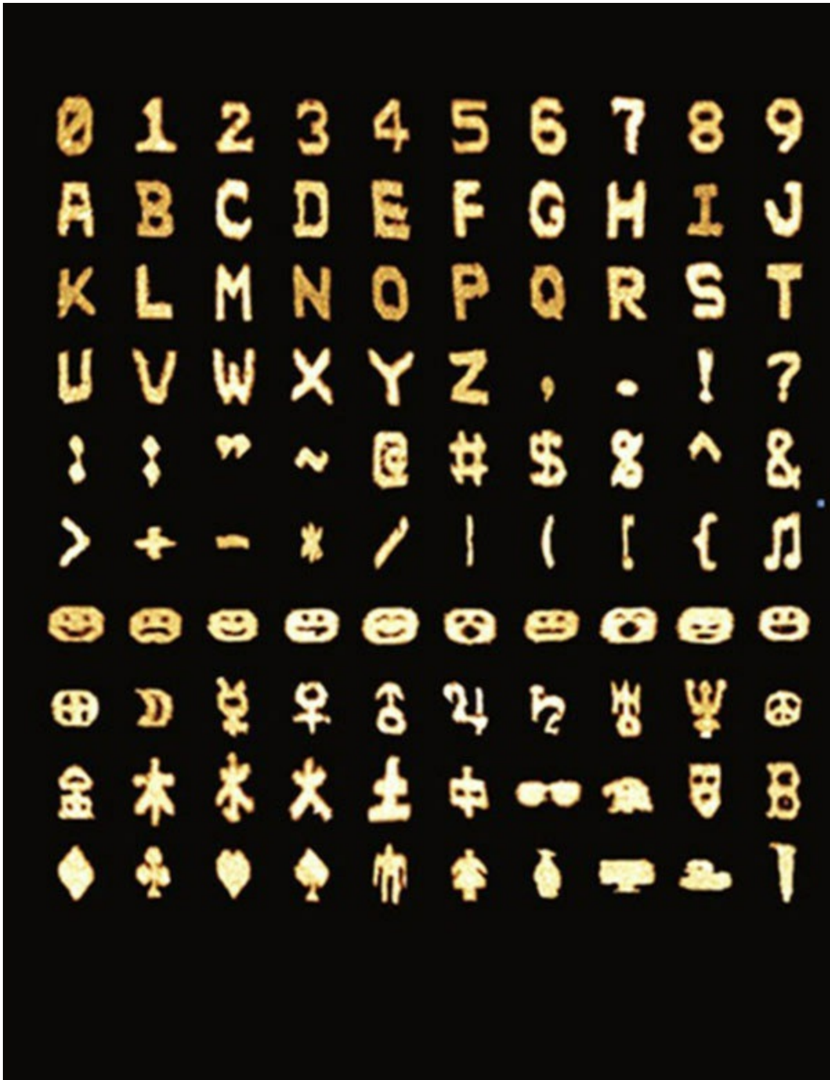
Esta imagen muestra un alfabeto completo, junto a varios símbolos y emoticonos, construido mediante la tecnología denominada origami de ADN. Cada uno de estos caracteres, con tamaño de fuente de 100 nm, está formado por cientos de moléculas de ADN de cadena sencilla y 42 nucleótidos de longitud, cuyas secuencias han sido diseñadas para que se autoensamblen y originen la forma deseada. El resultado final se ha visualizado por microscopía de fuerza atómica (AFM). Imagen obtenida por Bryan Wei, Mingjie Dai y Peng Yin (Instituto Wyss de Ingeniería Bioinspirada, Universidad de Harvard, USA). Figura adaptada con permiso de Macmillan Publishers Ltd: Nature 485 (2012).
