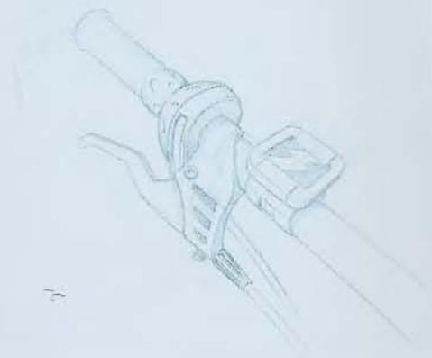
*Os pormenores devem ser realizados numa escala maior para que se apreciem melhor. Em determinados casos podemos destacá-los com cores e desenhar o resto utilizando uma técnica monocromática.*
