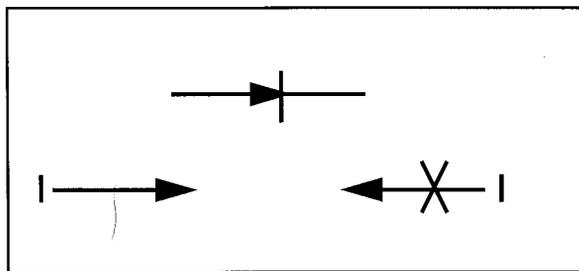
FIGURA 4.5: REPRESENTACIÓN DE UN DIODO
