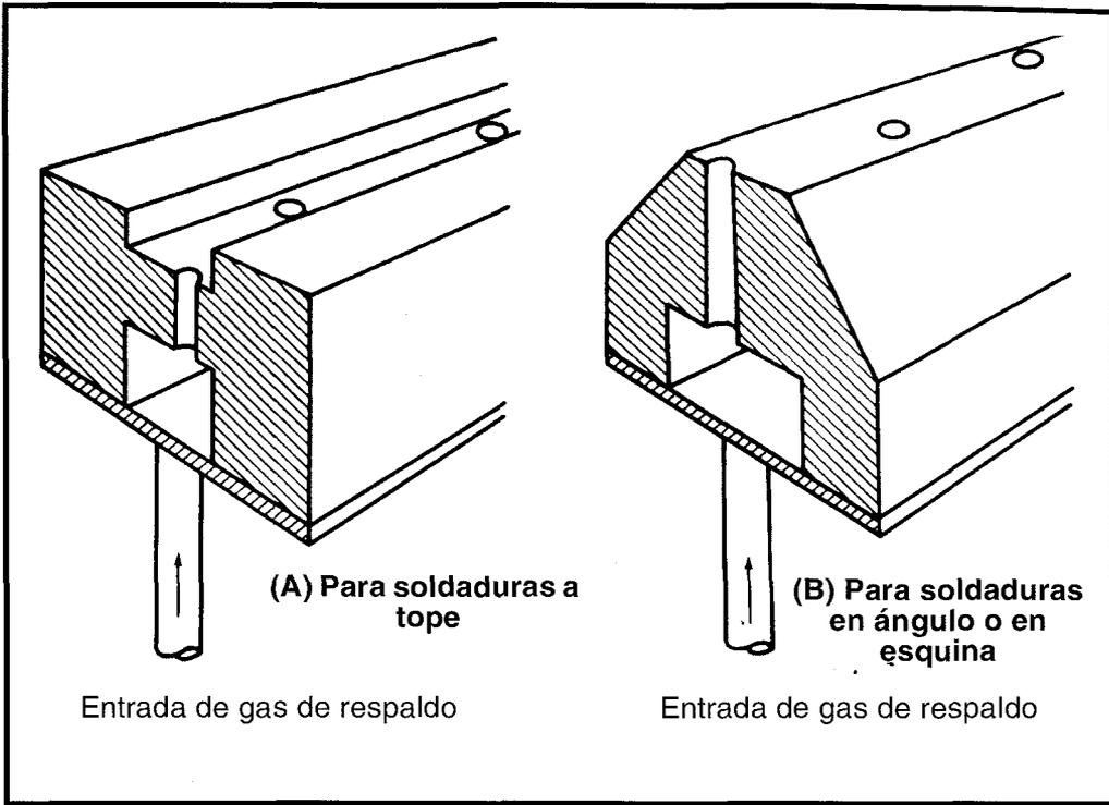
FIGURA 29.4: ZAPATAS DE RESPALDO PARA SUMINISTRO DE GAS
