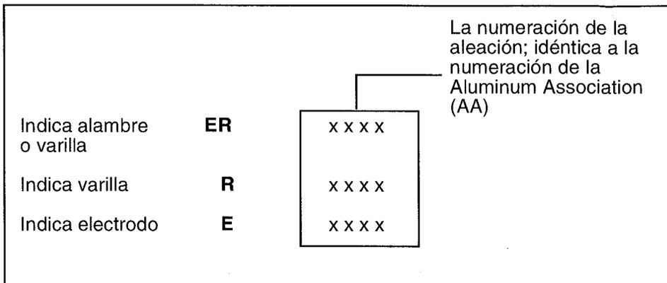
FIGURA 26.3: DESIGNACIÓN DE LOS MATERIALES DE APORTACIÓN DE ALUMINIO CONFORME A AWS
