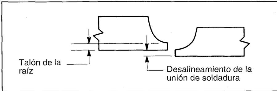
FIGURA 5.3: DESALINEAMIENTO DE LA UNIÓN DE SOLDADURA
