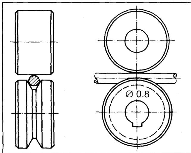
FIGURA 13.11: RODILLOS PARA EL SOLDEO MIG/MAG
