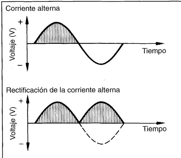
FIGURA 4.6: RECTIFICACIÓN DE LA CORRIENTE ALTERNA MONOFÁSICA
