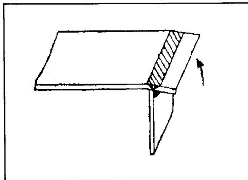
FIGURA 21.13: ENDEREZADO DE UNA PIEZA SOLDADA EN ÁNGULO MEDIANTE LÍNEA DE CALOR
