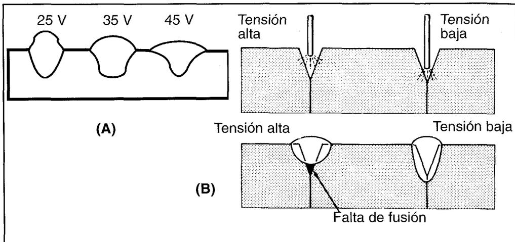
FIGURA 15.7: EFECTO DE LA TENSION EN EL ASPECTO DEL CORDÓN.
