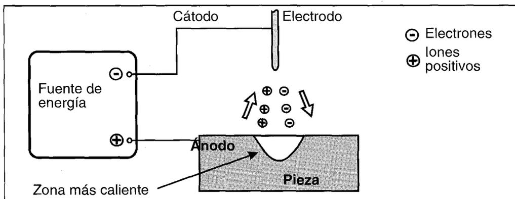
FIGURA 3.6: CORRIENTE CONTINUA ELECTRODO NEGATIVO (CCEN). POLARIDAD DIRECTA
