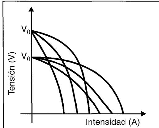
FIGURA 4.17: AJUSTE DE LA TENSIÓN DE VACÍO
