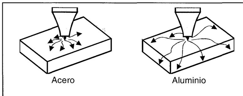
FIGURA 26.1: COMPARACIÓN DE LA CONDUCTIVIDAD TÉRMICA DEL ACERO Y DEL ALUMINIO
