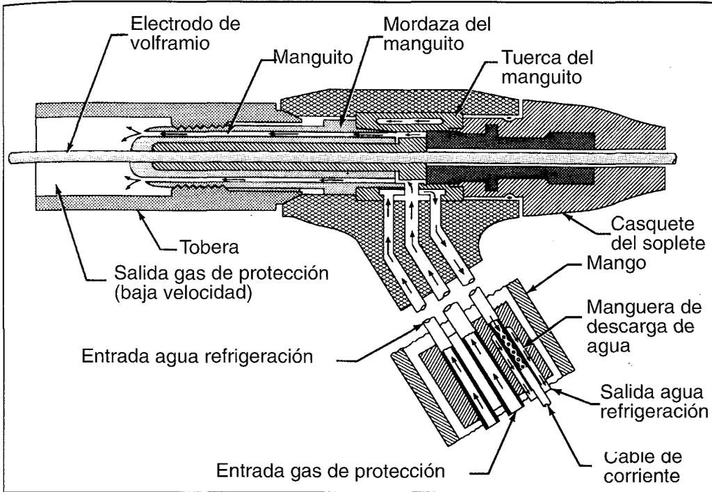
FIGURA 12.9: PORTAELECTRODO CON REFRIGERACIÓN POR AGUA PARA TIG
