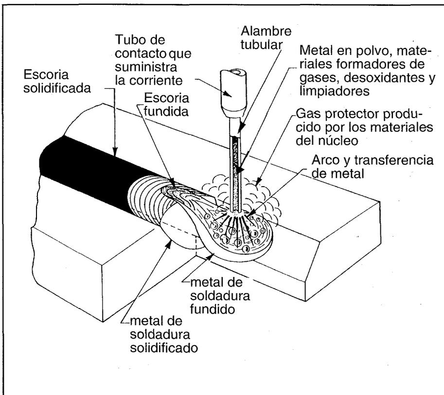
FIGURA 14.1: PROCESO CON ALAMBRE TUBULAR AUTOPROTEGIDO
