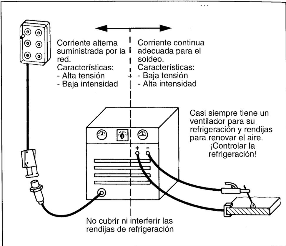
FIGURA 4.4: RECTIFICADOR DE SOLDEO
