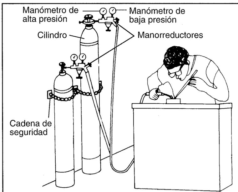
FIGURA 7.2: SUJECIÓN DE BOTELLAS
