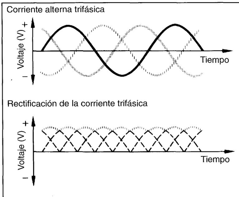
FIGURA 4.7: RECTIFICACIÓN DE LA CORRIENTE ALTERNA TRIFÁSICA
