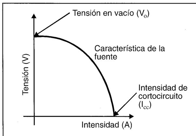
FIGURA 4.14: CARACTERÍSTICA DE UNA FUENTE DE ENERGÍA DE INTENSIDAD CONSTANTE
