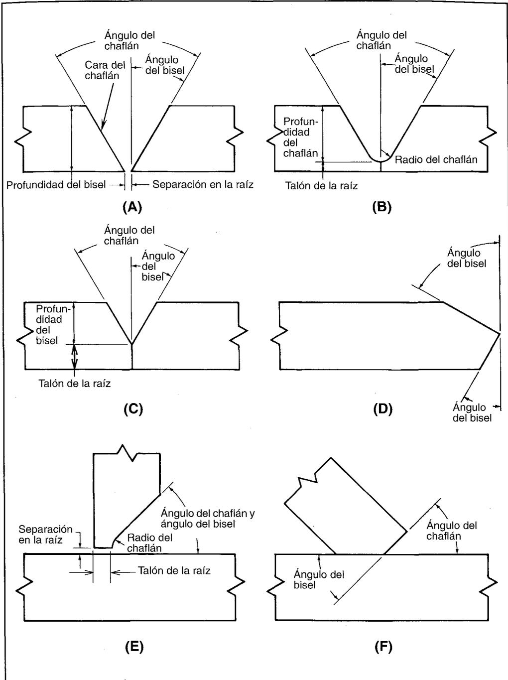
FIGURA 5.2: GEOMETRÍA DEL CHAFLÁN DE UNA SOLDADURA
