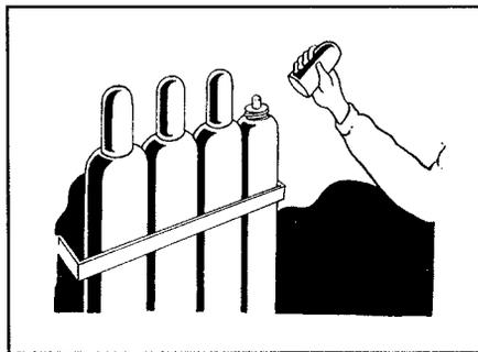
FIGURA 7.4: CAPERUZA DE PROTECCIÓN DE VÁLVULA
