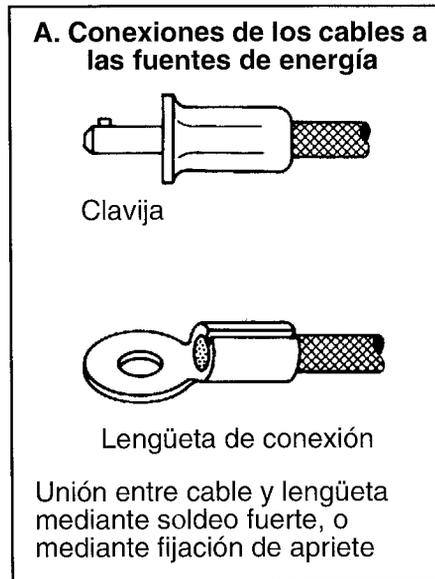
FIGURA 4.11: CONEXIONES PARA CABLES DE SOLDEO
