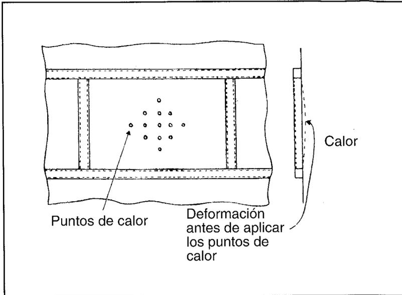
FIGURA 21.12: ENDEREZADO MEDIANTE PUNTOS DE CALOR
