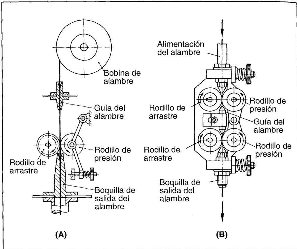
FIGURA 15.4: (A) UNIDAD DE ALIMENTACIÓN DE ALAMBRE DE 2 RODILLOS.
