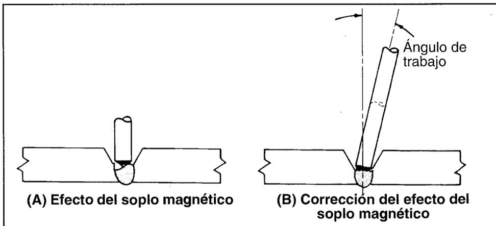
FIGURA 10.20: CORRECCIÓN DEL EFECTO DEL SOPLO MAGNÉTICO
