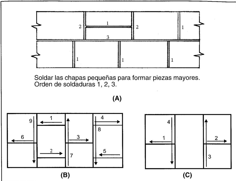
FIGURA 21.10: SOLDEO DE UN CONJUNTO DE CHAPAS
