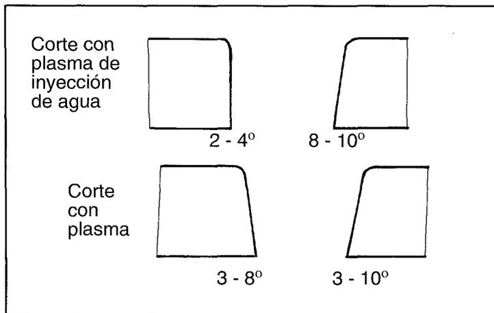
FIGURA 8.13: INCLINACIÓN DE LAS SUPERFICIES CORTADAS POR PLASMA
