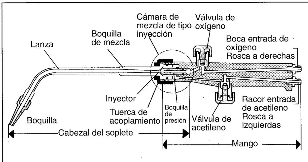
FIGURA 9.5: SOPLETE DE INYECCIÓN PARA SOLDEO OXIACETILÉNICO
