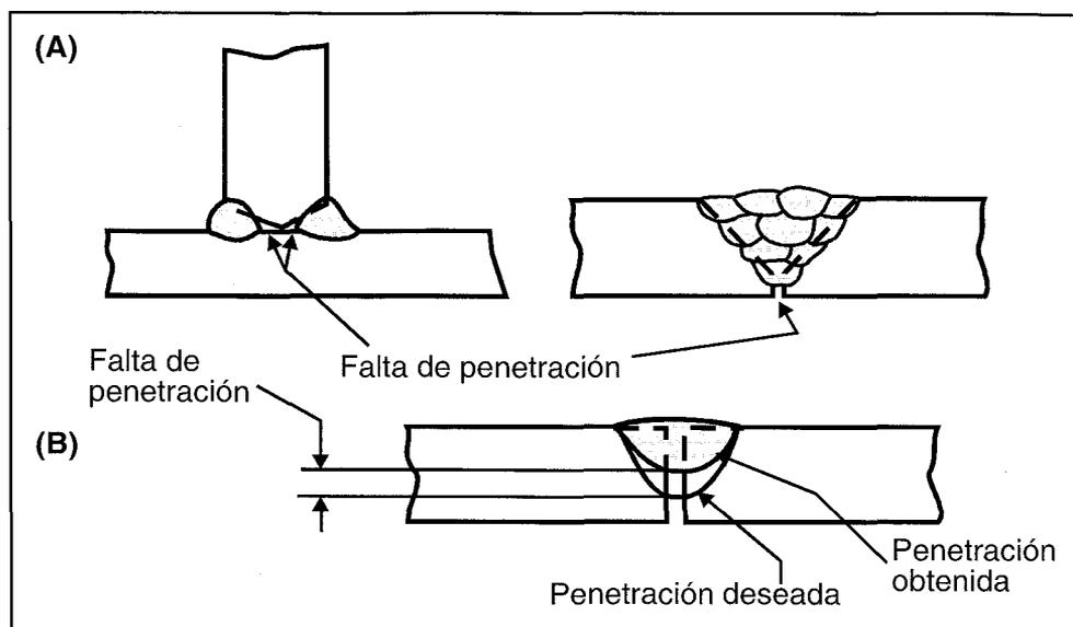
FIGURA 30.5: FALTA DE PENETRACIÓN
