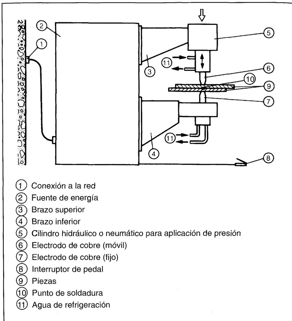
FIGURA 16.2: EQUIPO DE SOLDEO POR PUNTOS
