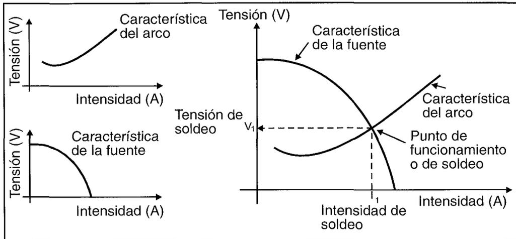
FIGURA 4.13: CURVA CARACTERÍSTICA DEL ARCO, DE LA FUENTE Y PUNTO DE FUNCIONAMIENTO
