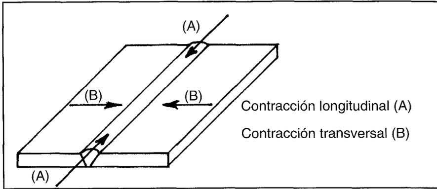
FIGURA 21.3: CONTRACCIONES TRANSVERSALES Y LONGITUDINALES PRODUCIDAS AL REALIZAR LA SOLDADURA
