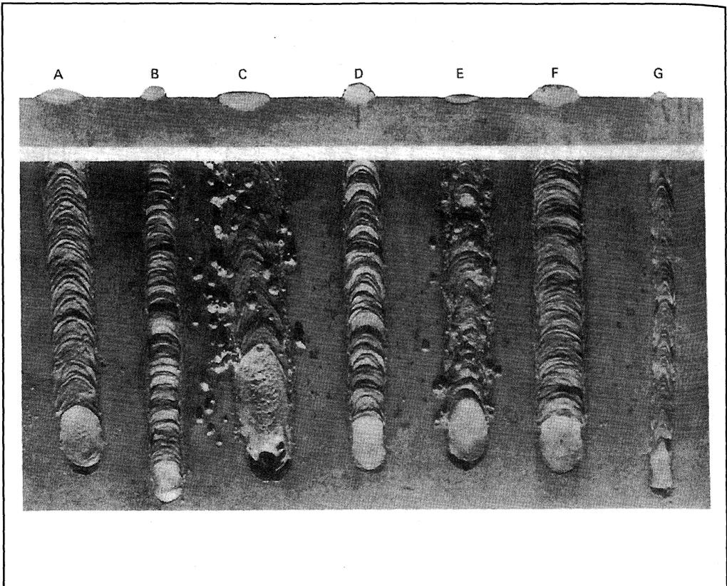
FIGURA 10.10: EFECTO DEL AMPERAJE, LONGITUD DEL ARCO Y VELOCIDAD DE DESPLAZAMIENTO; (A) AMPERAJE, LONGITUD DE ARCO Y VELOCIDAD DE DESPLAZAMIENTO APROPIADAS; (B) AMPERAJE DEMASIADO BAJO; (C) AMPERAJE DEMASIADO ALTO; (D) LONGITUD DE ARCO DEMASIADO CORTA; (E) LONGITUD DE ARCO DEMASIADO LARGA; (F) VELOCIDAD DE DESPLAZAMIENTO DEMASIADO LENTA; (G) VELOCIDAD DE DESPLAZAMIENTO DEMASIADO RÁPIDA
