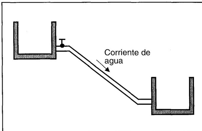
FIGURA 2.4: ESTABLECIMIENTO DE UNA CORRIENTE DE AGUA AL CONECTAR DOS DEPÓSITOS A DIFERENTE ALTURA
