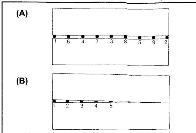
FIGURA 25.4: MÉTODO DE PUNTEADO. (A) DISTRIBUCIÓN CORRECTA DE LOS PUNTOS. (B) DISTRIBUCIÓN INCORRECTA, LA CHAPA SE CIERRA
