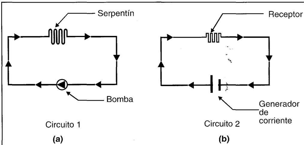
FIGURA 2.3: (a) SÍMIL HIDRÁULICO DE UN CIRCUITO ELÉCTRICO. (b) CIRCUITO ELÉCTRICO
