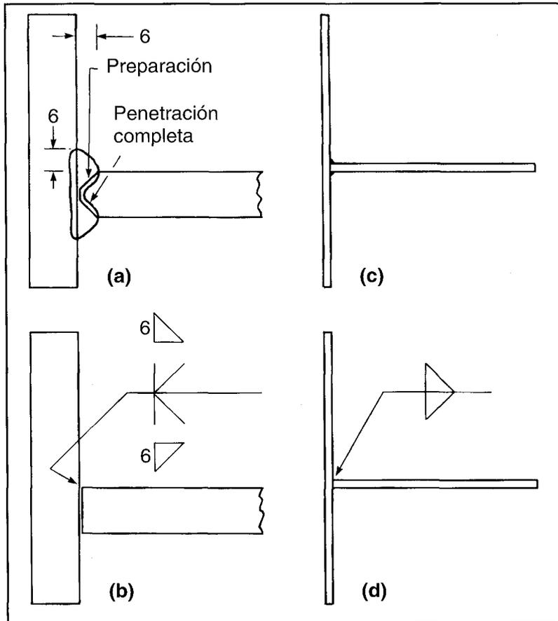
FIGURA 6.2: VENTAJAS DE UN SISTEMA DE SIMBOLIZACIÓN
