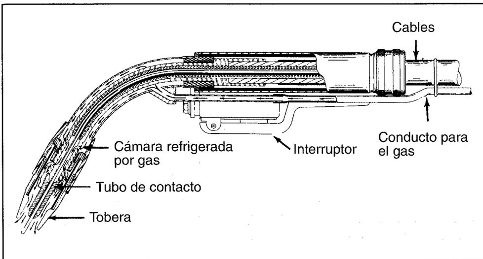
FIGURA 14.4 (B): PISTOLAS PARA EL SOLDEO CON PROTECCIÓN DE GAS
