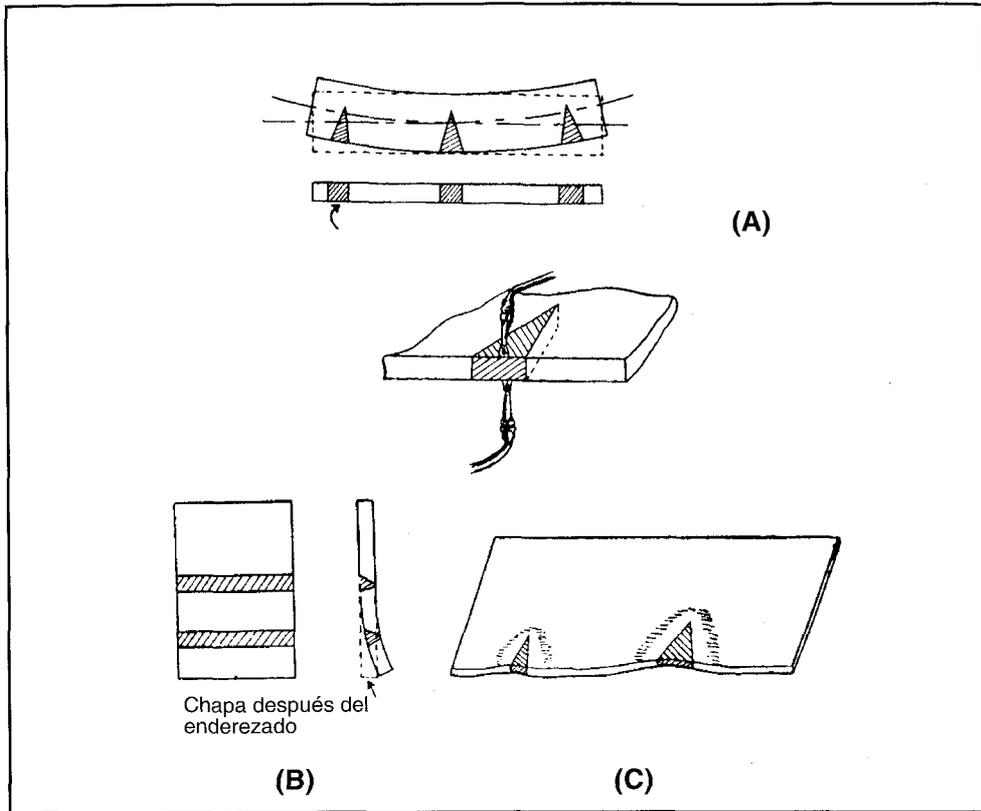
FIGURA 21.14: (A) ENDEREZADO POR CALENTAMIENTO LOCAL EN FORMA DE CUÑA. PUEDE REALIZARSE SOBRE AMBAS SUPERFICIES AL MISMO TIEMPO. (B) ENDEREZADO DE CHAPA CURVADA. (C) ENDEREZADO DE CHAPA ALABEADA
