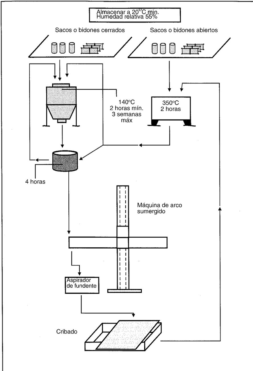
FIGURA 15.5: SECADO Y RECICLADO DE FUNDENTE
