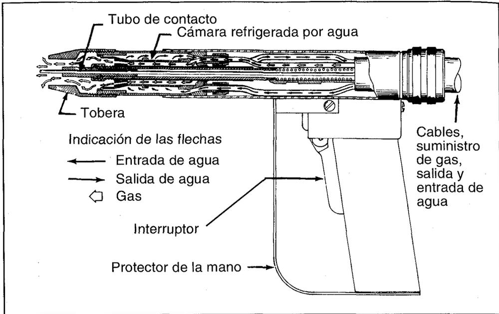
FIGURA 14.4 (B) (CONTINUACIÓN): PISTOLAS PARA EL SOLDEO CON PROTECCIÓN DE GAS
