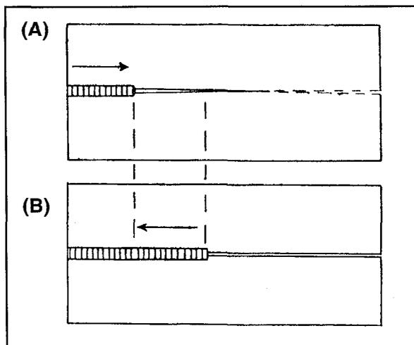
FIGURA 21.9: MÉTODO DE CORREGIR LA DISMINUCIÓN DE LA SEPARACIÓN EN LA RAÍZ: CAMBIAR EL SENTIDO DEL SOLDEO
