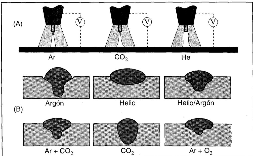
FIGURA 11.2 (A): FORMA DE LA COLUMNA DE PLASMA EN FUNCIÓN DEL GAS DE PROTECCIÓN (SOLDEO MIG O MAG); (B): FORMA DEL CORDÓN EN FUNCIÓN DEL GAS DE PROTECCIÓN (SOLDEO MIG O MAG)
