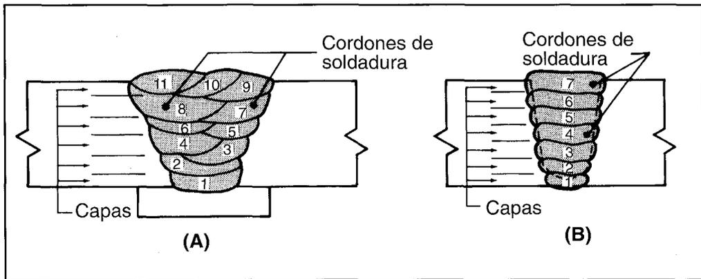
FIGURA 5.7: CORDONES DE SOLDADURA Y CAPAS DE SOLDADURA
