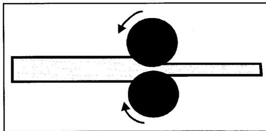
FIGURA 18.2: REPRESENTACIÓN ESQUEMÁTICA DEL PROCESO DE LAMINACIÓN
