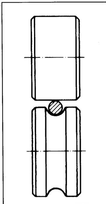
FIGURA 26.5: RODILLOS PARA SOLDEO MIG DEL ALUMINIO Y SUS ALEACIONES
