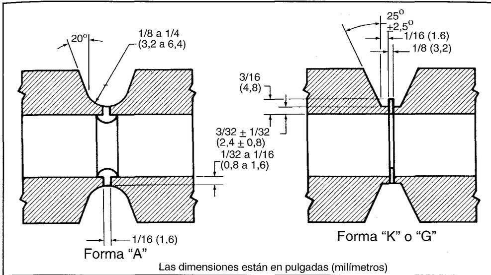
FIGURA 12.14 (B): DISPOSICIÓN TÍPICA DE INSERTOS CONSUMIBLES EN TUBERÍA
