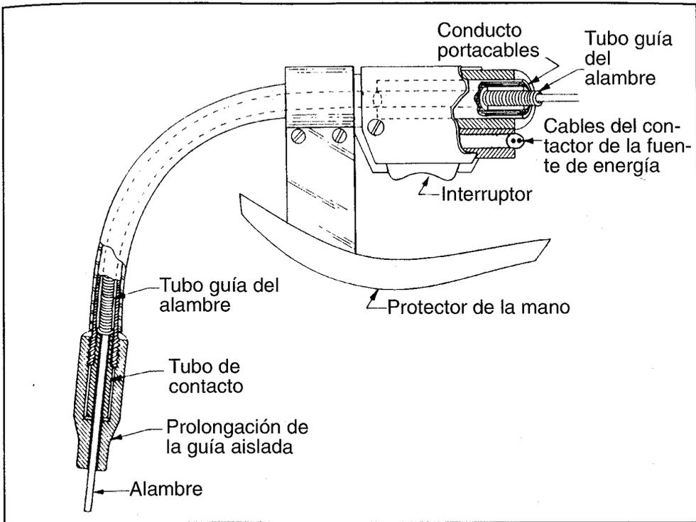
FIGURA 14.4 (A): PISTOLA PARA SOLDEO CON ALAMBRE AUTOPROTEGIDO
