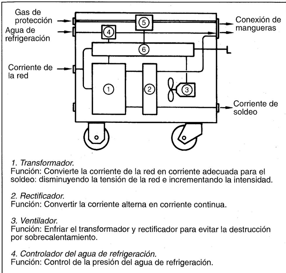
FIGURA 12.5 (B): COMPONENTES DEL EQUIPO DE CORRIENTE CONTINUA
