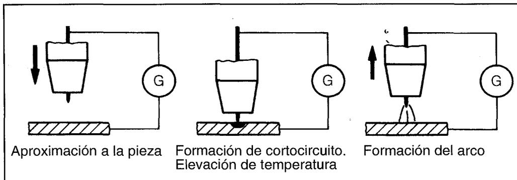
FIGURA 12.15: CEBADO DEL ARCO POR RASPADO. G = FUENTE DE ALIMENTACIÓN
