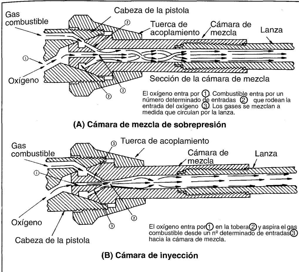
FIGURA 9.6: CÁMARAS DE MEZCLA. A) DE SOBREPRESIÓN. B) DE BAJA PRESIÓN.
