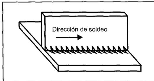
FIGURA 10.16: AL REALIZAR CORDONES CON BALANCEO EN POSICIÓN PB SE DEBE LLEVAR MÁS AVANZADA LA PARTE BAJA DEL CORDÓN
