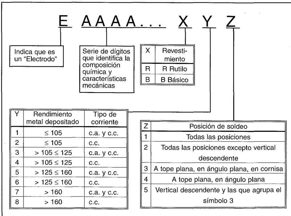
FIGURA 25.3: DESIGNACIÓN DE LOS ELECTRODOS REVESTIDOS PARA EL SOLDEO MANUAL POR ARCO DE LOS ACEROS INOXIDABLES Y RESISTENTES AL CALOR DE ACUERDO CON UNE-EN 1600:1998
