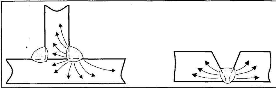
FIGURA 22.2: COMPARACIÓN DE LA TRANSMISIÓN DE CALOR EN UNA SOLDADURA EN ÁNGULO Y EN UNA A TOPE
