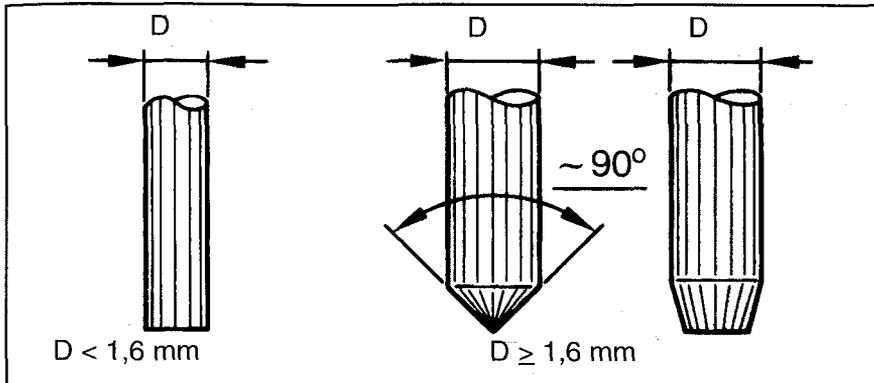
FIGURA 12.13: PREPARACIÓN ACONSEJABLE DE LA PUNTA DEL ELECTRODO PARA SOLDEO CON CORRIENTE ALTERNA
