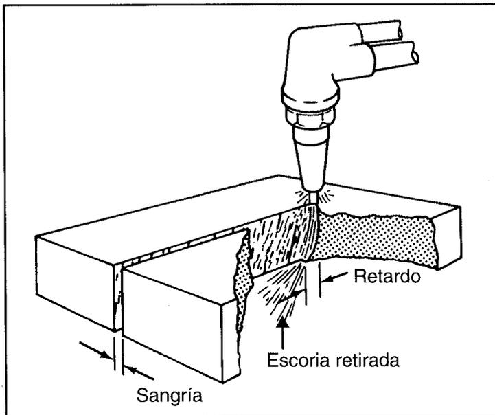
FIGURA 8.3: EL OXÍGENO DE CORTE QUEMA EL METAL PRECALENTADO Y RETIRA LA ESCORIA FORMADA, DEJANDO UN CANAL DENOMINADO "SANGRÍA"
