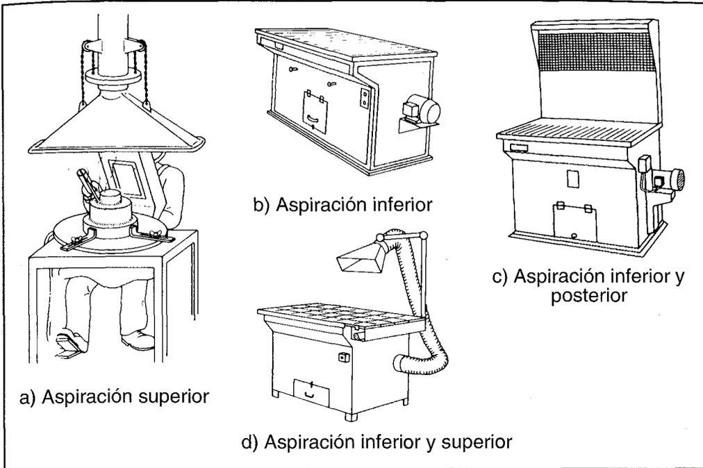
FIGURA 7.13: EXTRACCIÓN DE HUMOS EN BANCOS DE SOLDEO
