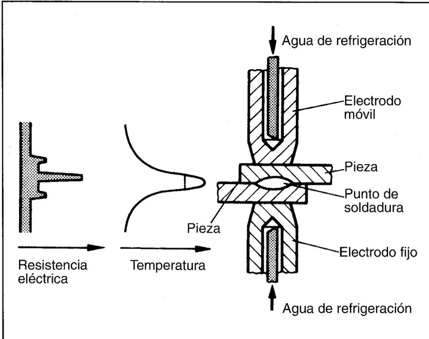
FIGURA 16.1: SOLDEO POR PUNTOS
