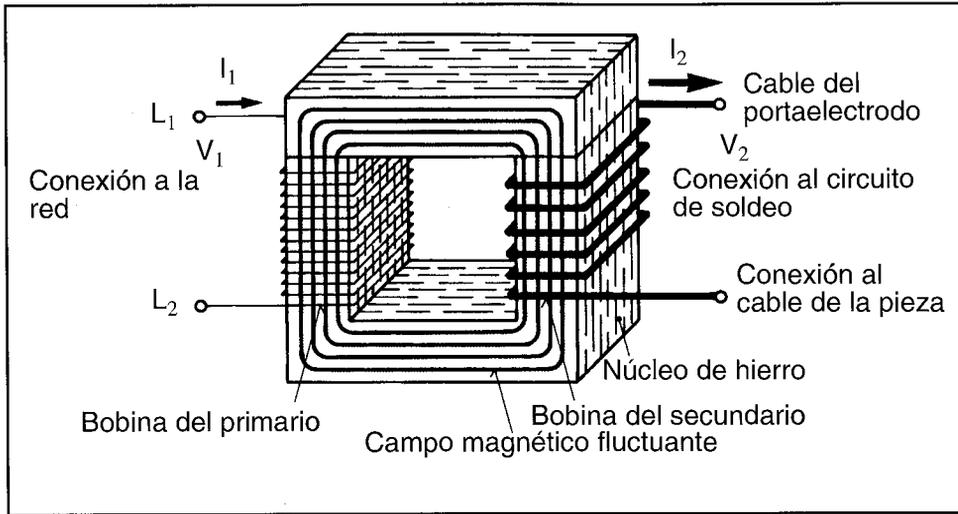
FIGURA 4.3: CONSTITUCIÓN Y PRINCIPIO DEL TRANSFORMADOR
