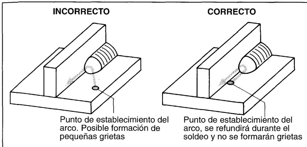
FIGURA 10.15: ESTABLECIMIENTO DEL ARCO EN LA POSICIÓN CORRECTA
