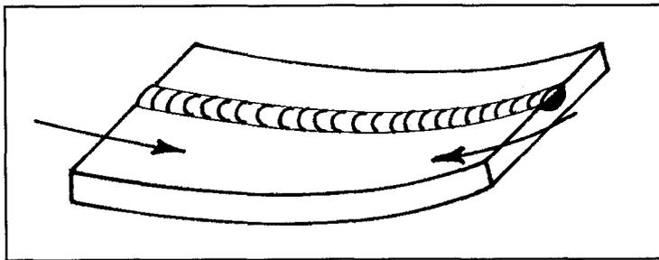
FIGURA 21.4: DEFORMACIÓN POR CONTRACCIÓN LONGITUDINAL
