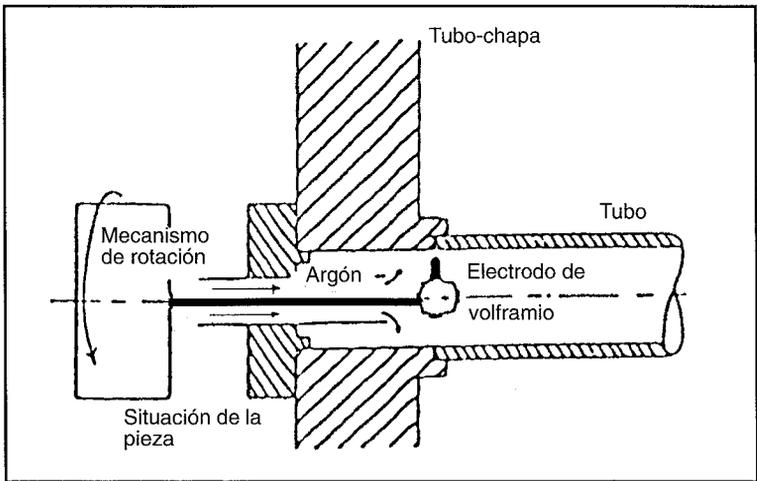
FIGURA 12.21: SOLDEO ORBITAL
