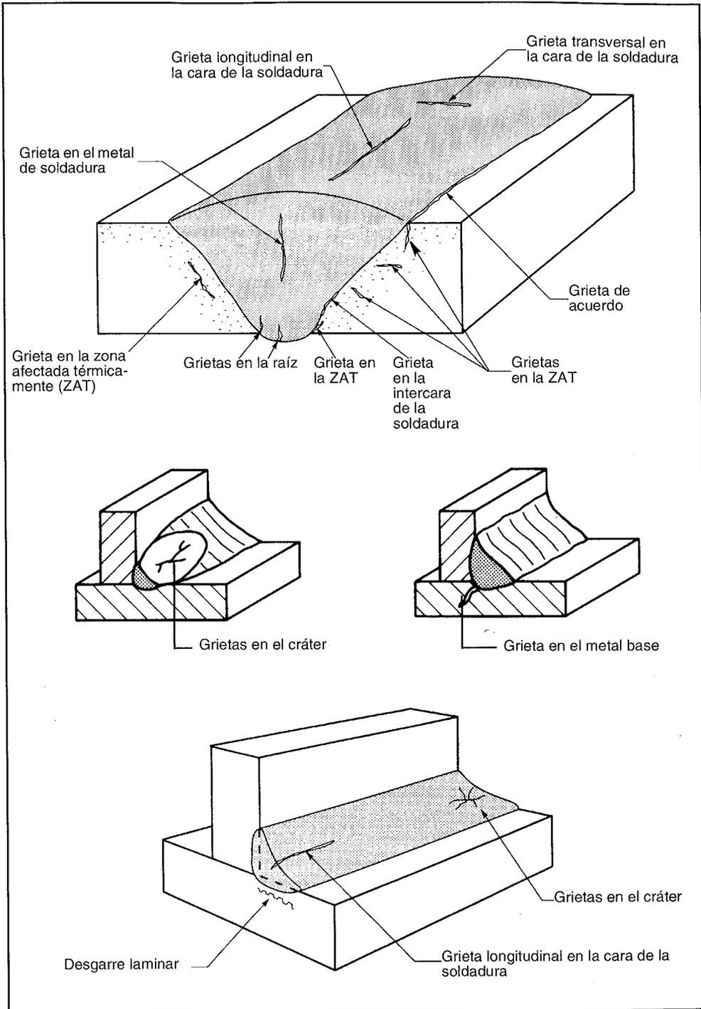
FIGURA 30.1: GRIETAS EN LAS SOLDADURAS
