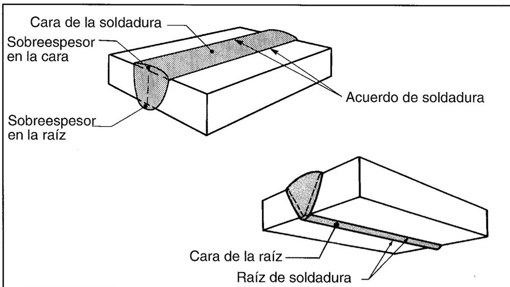
FIGURA 5.6: CARA Y RAÍZ DE UNA SOLDADURA
