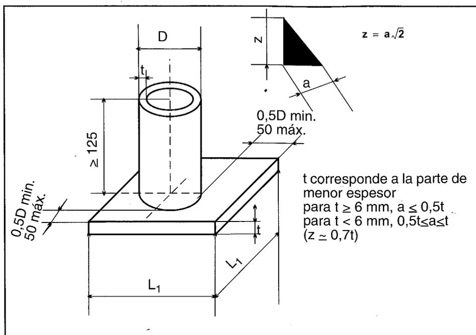
FIGURA 32.4: DIMENSIONES DEL CUPÓN DE PRUEBA PARA EL SOLDEO DE TUBOS EN ÁNGULO (DIMENSIONES EN MILÍMETROS)
