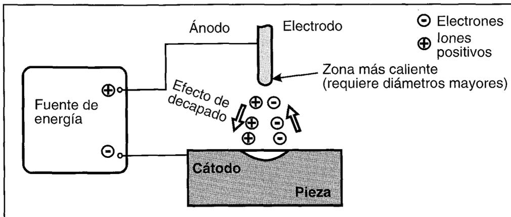
FIGURA 3.5: CORRIENTE CONTINUA ELECTRODO POSITIVO, (CCEP). POLARIDAD INVERSA
