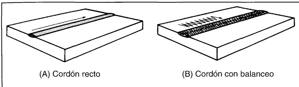
Nota: Las flechas adyacentes a los cordones de soldadura indican el movimiento relativo del haz, electrodo o llama respecto a la pieza.
