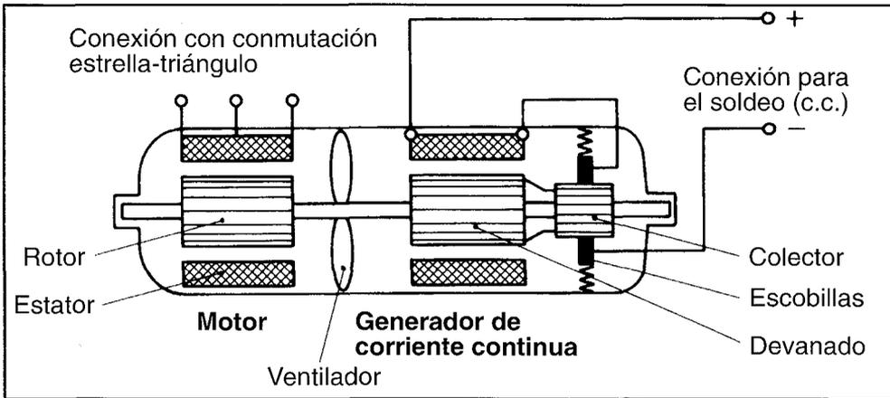
FIGURA 4.9: CONVERTIDOR DE SOLDEO
