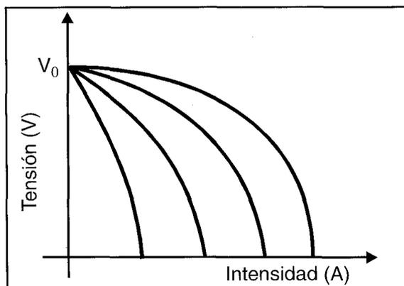
FIGURA 4.16: VARIACIÓN DE LA CORRIENTE EN UNA FUENTE DE ENERGÍA DE INTENSIDAD CONSTANTE
