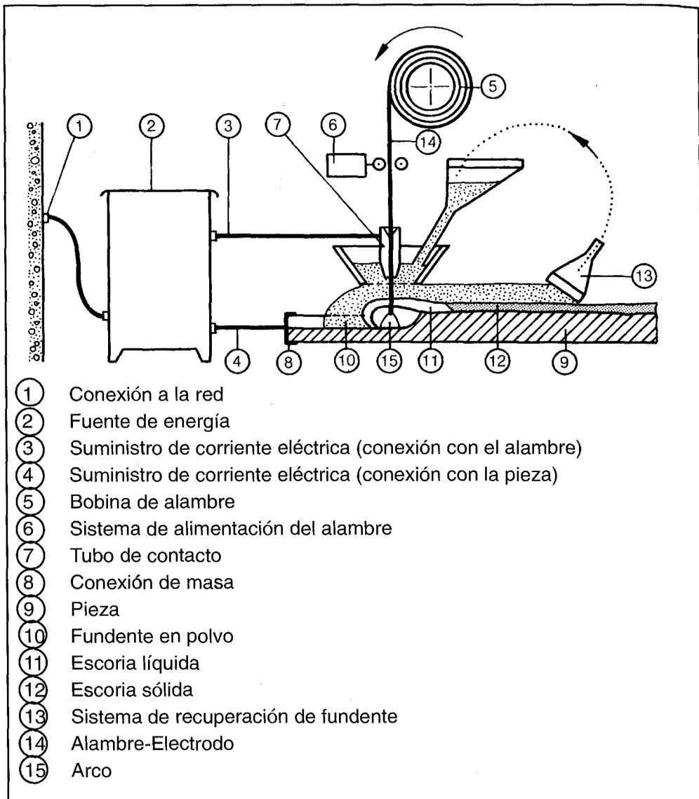
FIGURA 15.3: EQUIPO PARA SOLDEO POR ARCO SUMERGIDO
