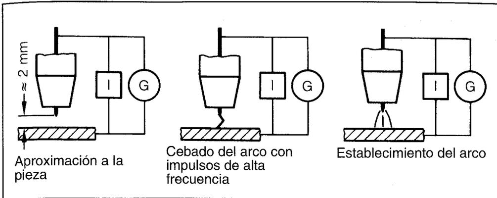
FIGURA 12.16: CEBADO DE ARCO POR CORRIENTE DE ALTA FRECUENCIA.
