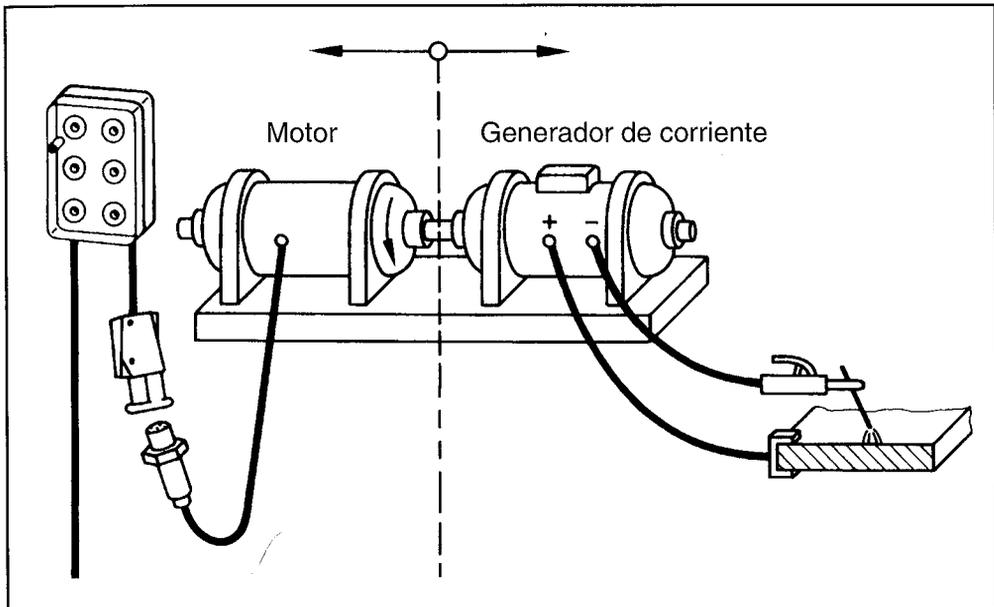
FIGURA 4.8: CONVERTIDOR DE SOLDEO
