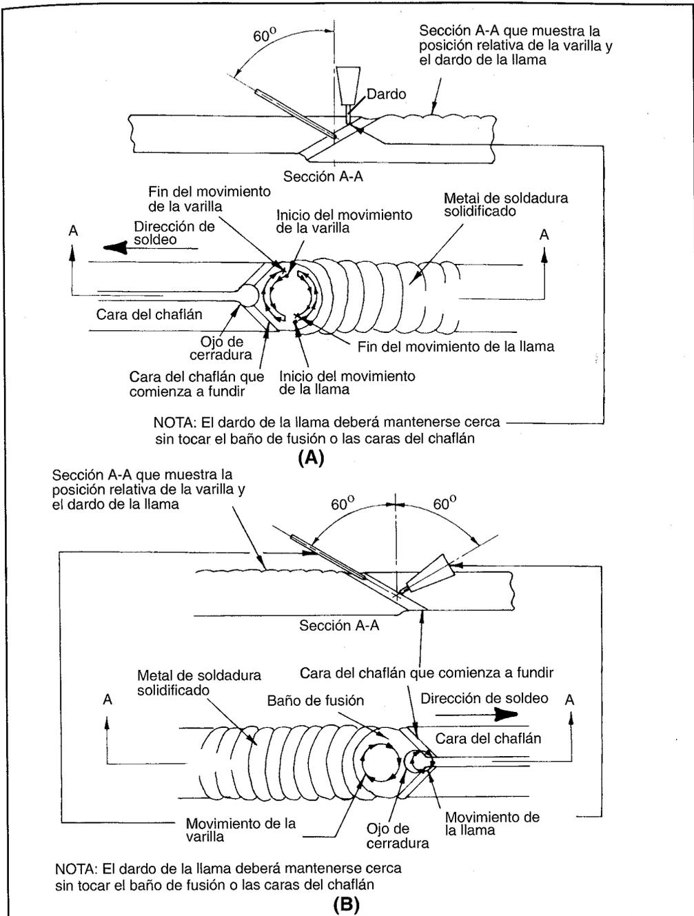
FIGURA 9.12: (A) TÉCNICA DE SOLDEO HACIA ADELANTE O A IZQUIERDAS.
