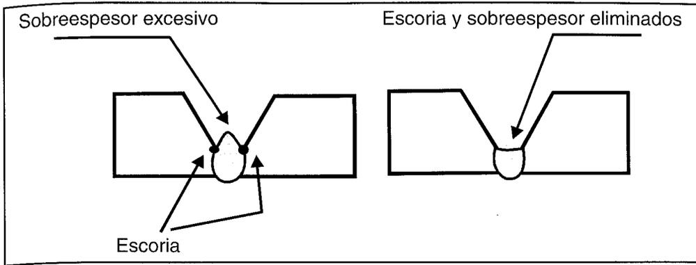
FIGURA 10.19: ELIMINAR EL SOBREESESOR EXCESIVO Y LA ESCORIA ATRAPADA ANTES DE DEPOSITAR EL SIGUIENTE CORDÓN
