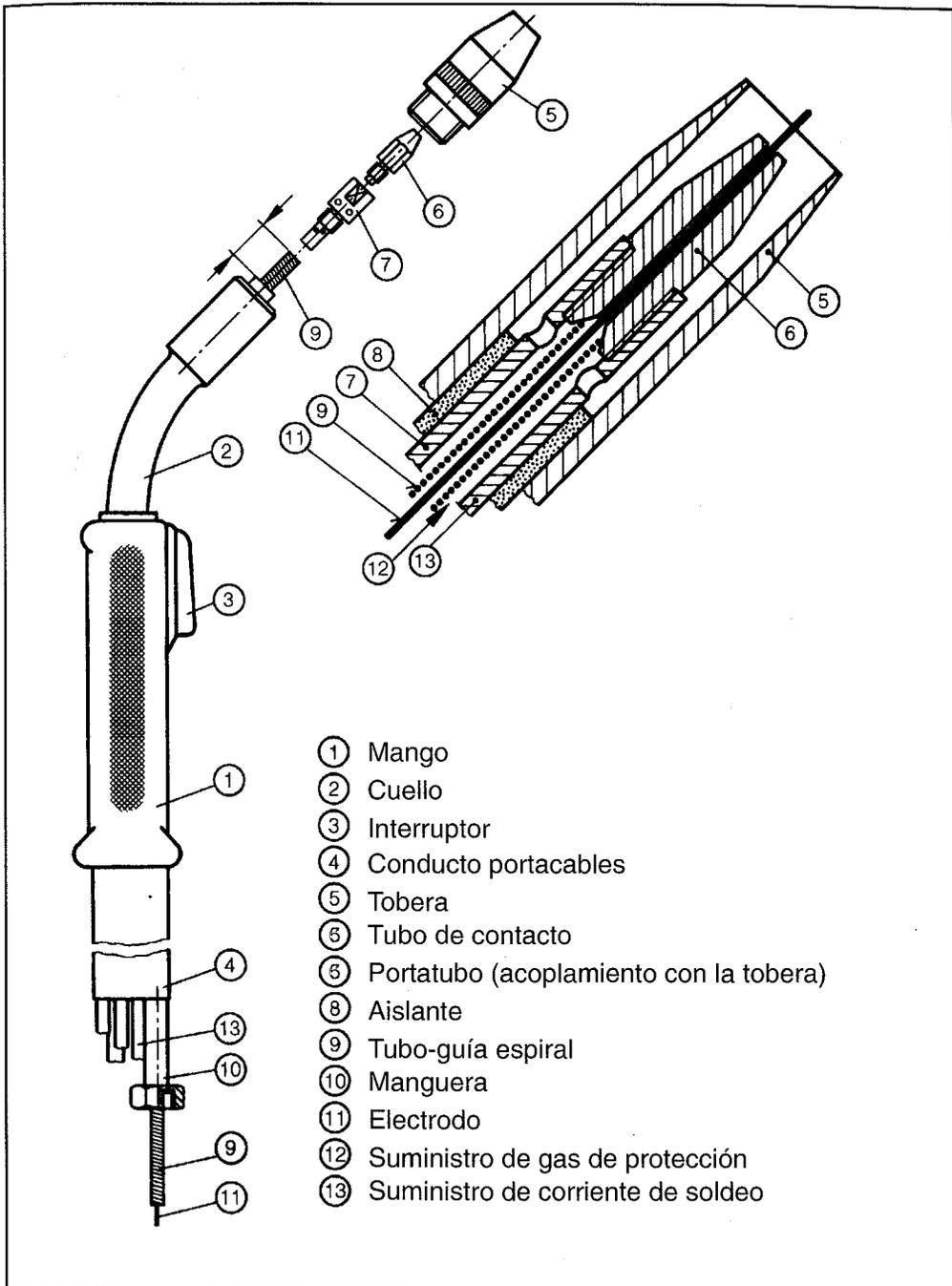
FIGURA 13.12: PISTOLA PARA SOLDEO MIG/MAG (ACERO AL CARBONO)
