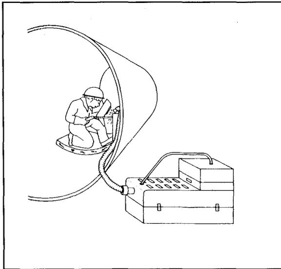
FIGURA 7.12: EXTRACCIÓN CON UNIDAD FILTRANTE PORTÁTIL
