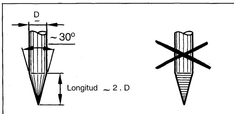
FIGURA 12.12: PREPARACIÓN ACONSEJABLE DE LA PUNTA DEL ELECTRODO PARA SOLDADO CON CORRIENTE CONTINUA
