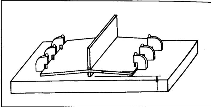
FIGURA 21.6: PREDEFORMAR ELÁSTICAMENTE LA PIEZA ANTES DEL SOLDEO
