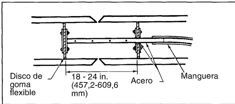
FIGURA 11.4: DISPOSITIVO PARA GAS DE RESPALDO
