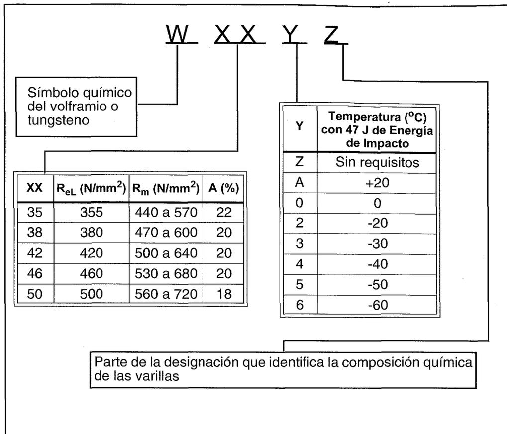
FIGURA 22.6: DESIGNACIÓN Y CLASIFICACIÓN DE LAS VARILLAS, ALAMBRES Y DEPÓSITOS PARA SOLDEO TIG, DE ACUERDO CON UNE-EN 1668:1997 UTILIZANDO EN 439-I1 (100% ARGÓN) COMO GAS DE PROTECCIÓN
