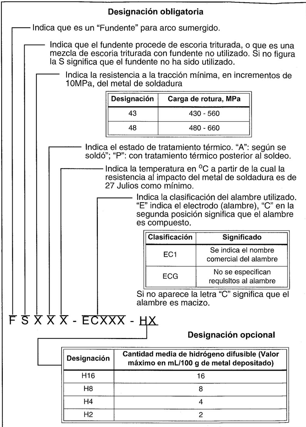
FIGURA 22.10: CLASIFICACIÓN DE LOS ALAMBRES Y FUNDENTES PARA EL SOLDEO POR ARCO SUMERGIDO DE ACEROS AL CARBONO DE ACUERDO CON ANSI/AWS
