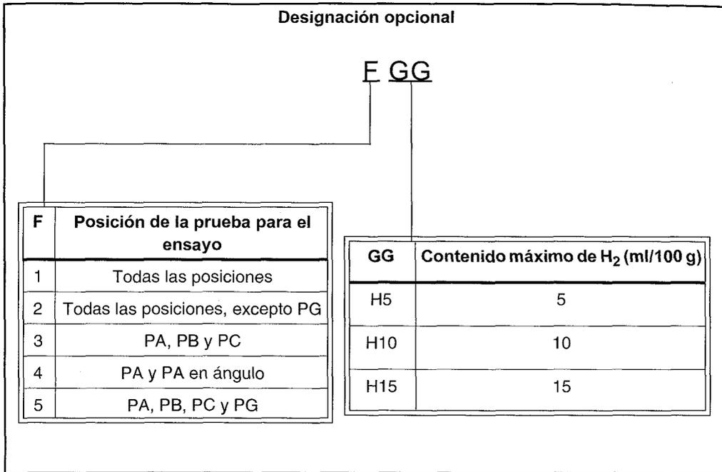
FIGURA 22.8 (CONTINUACIÓN): CLASIFICACIÓN DE LOS ALAMBRES TUBULARES PARA EL SOLDEO POR ARCO CON Y SIN GAS DE PROTECCIÓN DE LOS ACEROS NO ALEADOS Y DE GRANO FINO DE ACUERDO CON UNE-EN 758:1997
