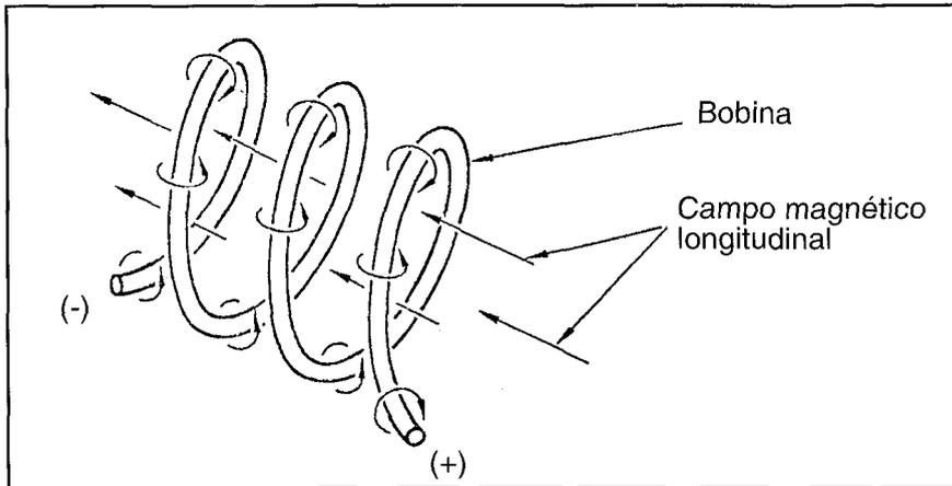
FIGURA 2.14: PRODUCCIÓN DE CAMPO MAGNÉTICO LONGITUDINAL
