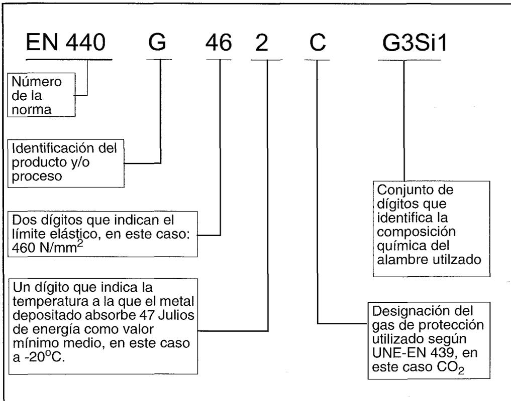
FIGURA 22.7: CLASIFICACIÓN DE LOS ALAMBRES DE DEPÓSITOS PARA SOLDEO POR ARCO CON PROTECCIÓN GASEOSA DE LOS ACEROS NO ALEADOS Y DE GRANO FINO SEGUN UNE-EN 440:1995
