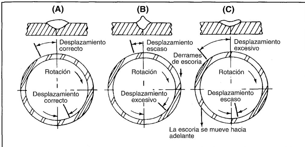
FIGURA 15.10: EFECTO DE LAS POSICIONES DEL ELECTRODO SOBRE LA FORMA DEL CORDÓN DE SOLDADURA DURANTE EL SOLDEO CIRCUNFERENCIAL
