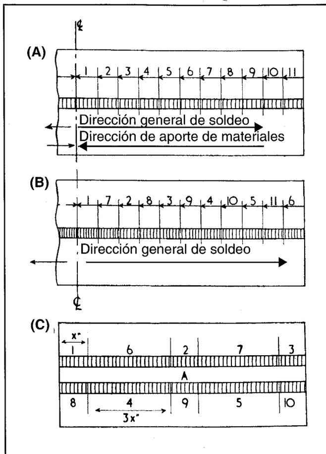
FIGURA 21.8: (A) SOLDEO DE PASO DE PEREGRINO. (B) SOLDEO A SALDOS. (C) TÉCNICA PARA REALIZAR DOS SOLDADURAS EN ÁNGULO EN FORMA DE T
