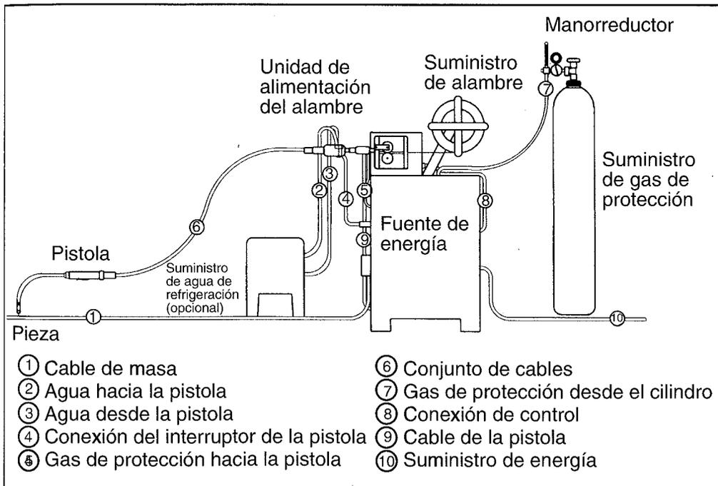
FIGURA 13.2: EQUIPO PARA EL SOLDEO MIG/MAG
