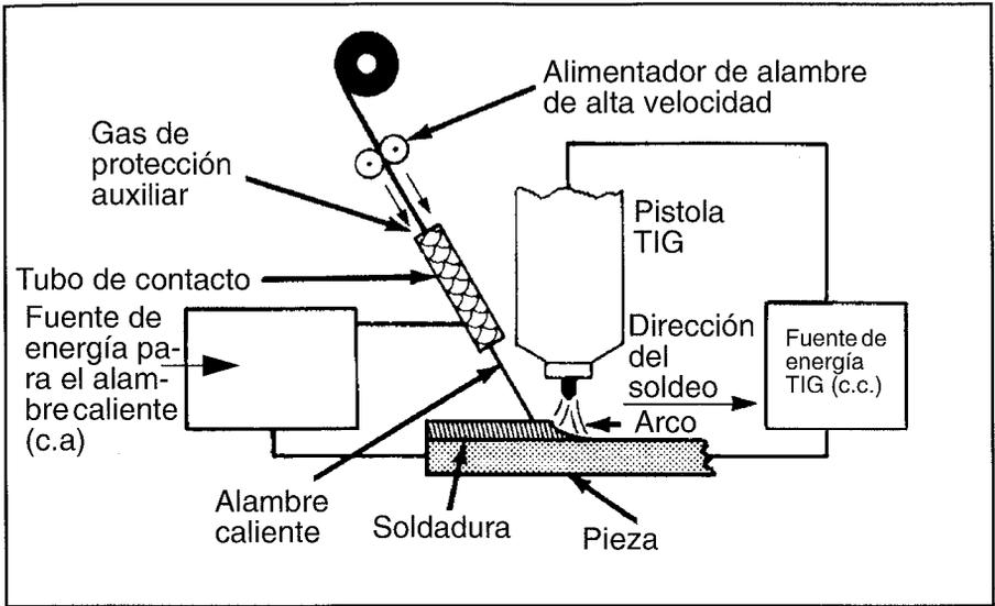
FIGURA 12.20: INSTALACIÓN PARA SOLDEO TIG CON ALAMBRE CALIENTE
