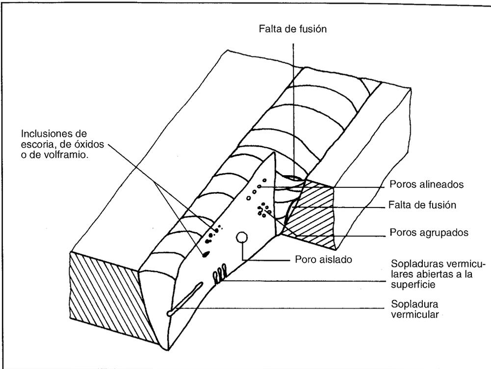
FIGURA 30.2: DEFECTOS INTERNOS EN UNA SOLDADURA
