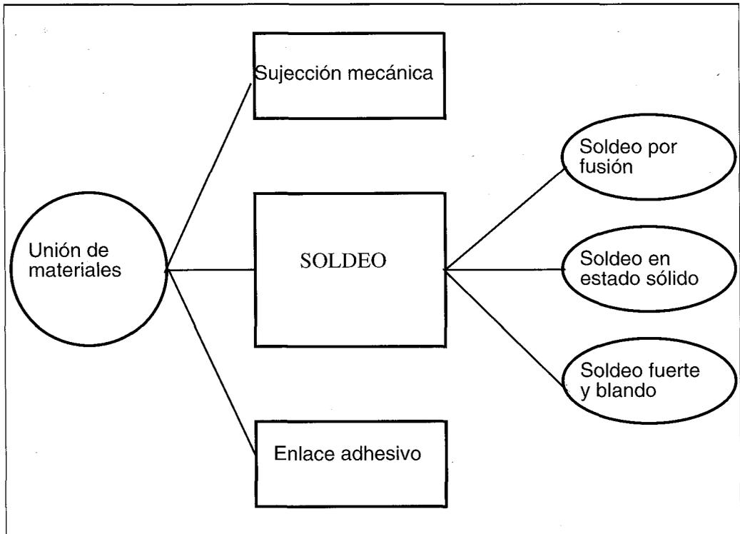
FIGURA 1.2: ESQUEMA DE LOS MÉTODOS DE UNIÓN DE MATERIALES
