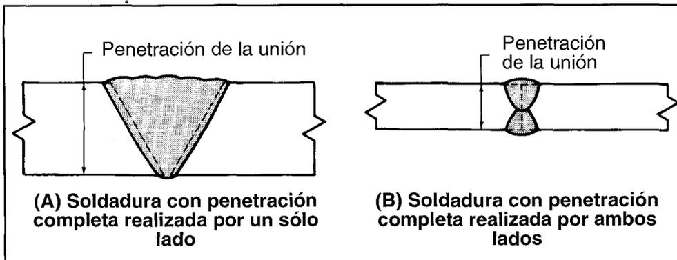
FIGURA 5.8: SOLDADURAS CON PENETRACIÓN COMPLETA
