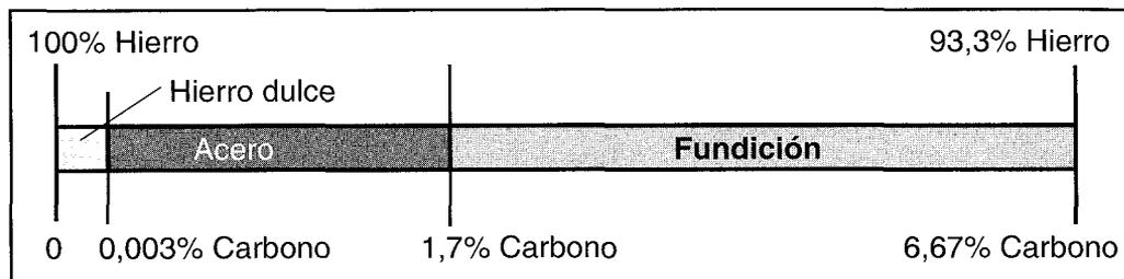
FIGURA 22.1: DIFERENCIA ENTRE ACERO Y FUNDICIÓN POR SU COMPOSICIÓN QUÍMICA
