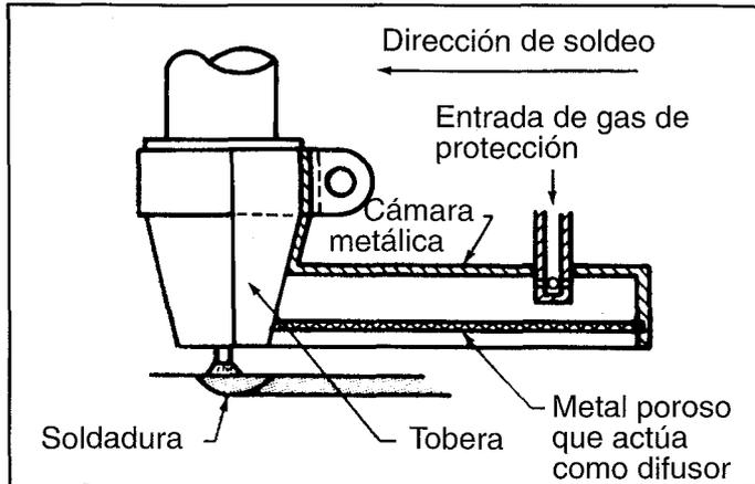
FIGURA 29.1: CÁMARA REMOLCADA PARA SOLDEO DE TITANIO
