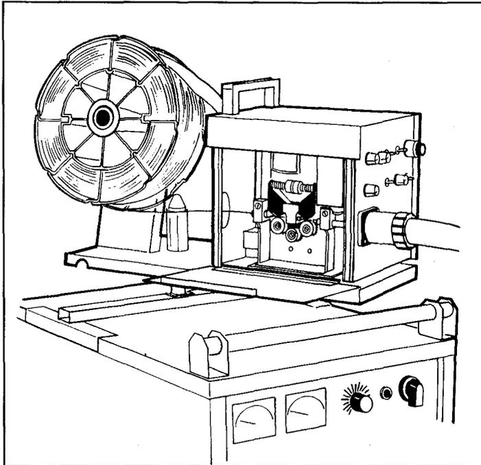
FIGURA 13.7: EJEMPLO DE MECANISMO ALIMENTADOR DEL ALAMBRE
