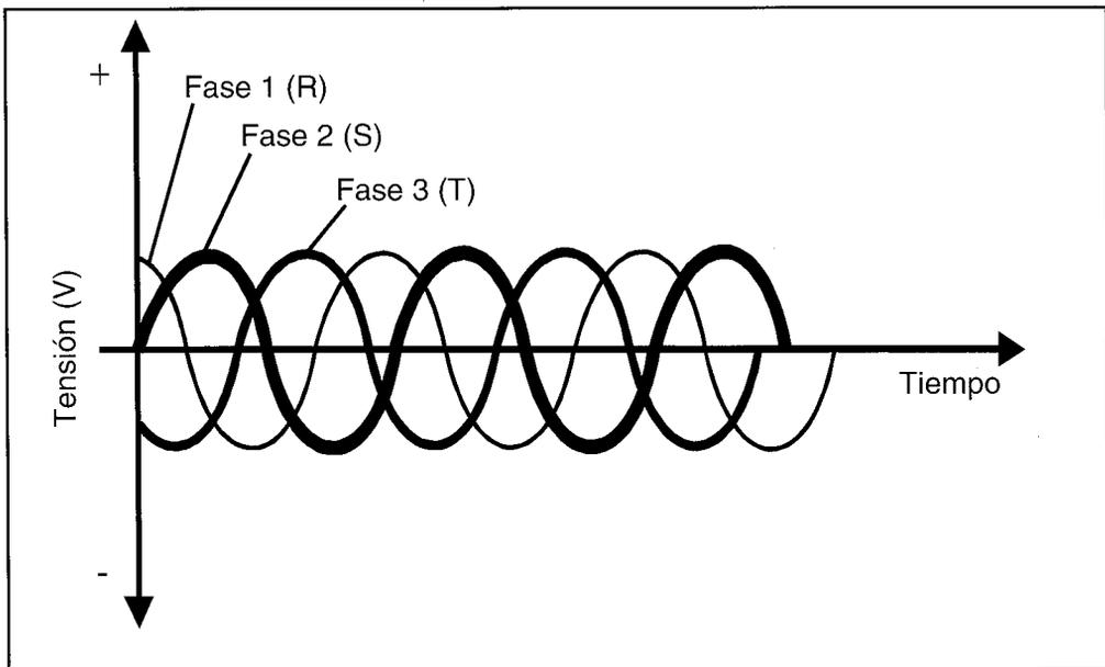
FIGURA 2.8: CORRIENTE ALTERNA TRIFÁSICA
