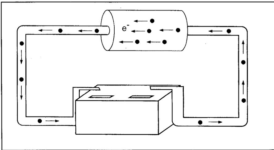
FIGURA 2.2: CORRIENTE ELÉCTRICA COMO FLUJO DE ELECTRONES ( $e^-$ )
