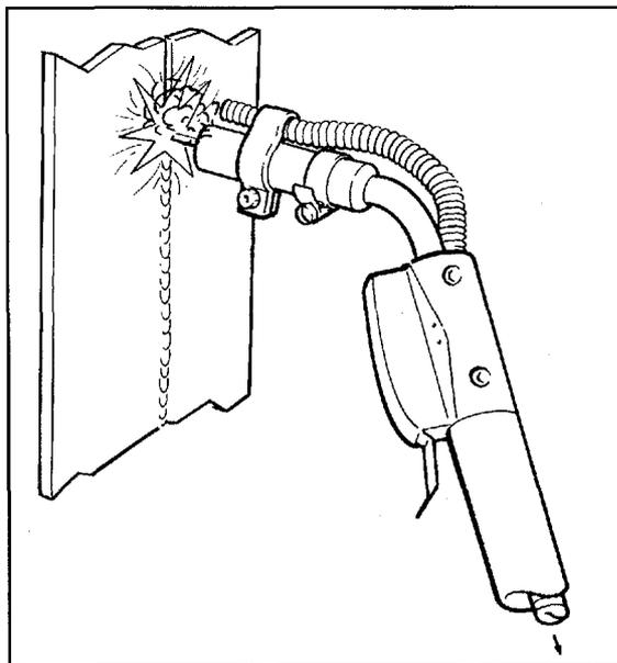
FIGURA 7.14: PISTOLA DE SOLDEO CON EXTRACTOR
