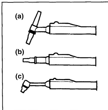
FIGURA 12.8: CONFIGURACIONES DEL PORTAELECTRODOS TIG.
