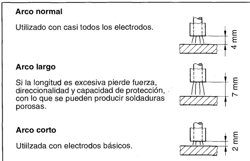
FIGURA 10.13: LONGITUDES DE ARCO NORMALES PARA UN ELECTRODO DE 4 mm Ø
