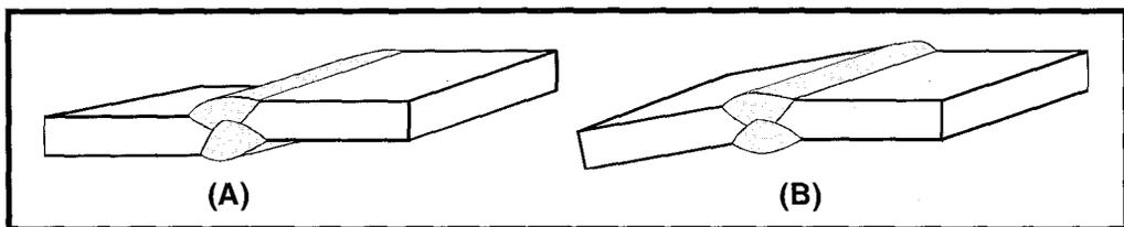
FIGURA 30.10: (A) FALTA DE ALINEACIÓN. (B) DEFORMACIÓN ANGULAR
