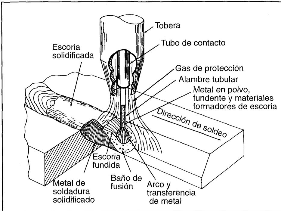
FIGURA 14.2: PROCESO CON ALAMBRE TUBULAR CON PROTECCIÓN GASEOSA
