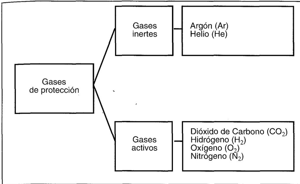
FIGURA 11.1: CLASIFICACIÓN DE LOS GASES DE PROTECCIÓN
