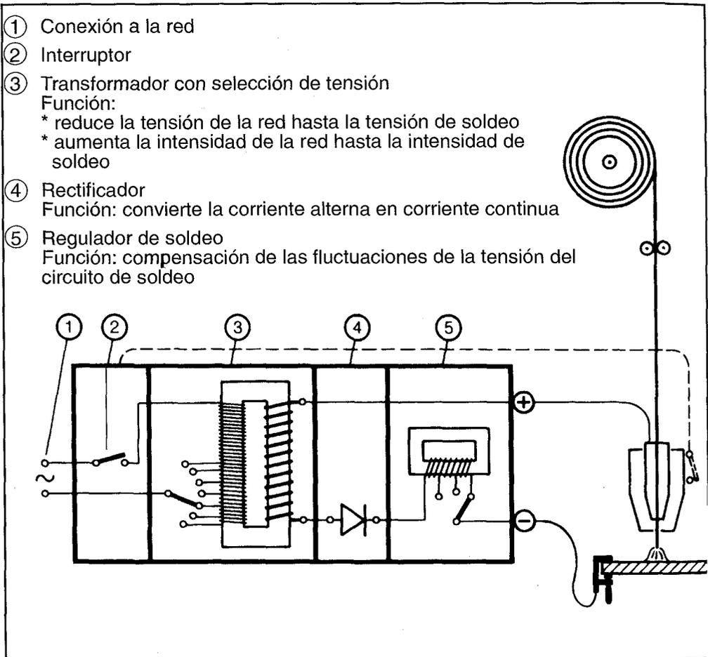
FIGURA 13.6: COMPONENTES DE LA FUENTE DE ENERGÍA
