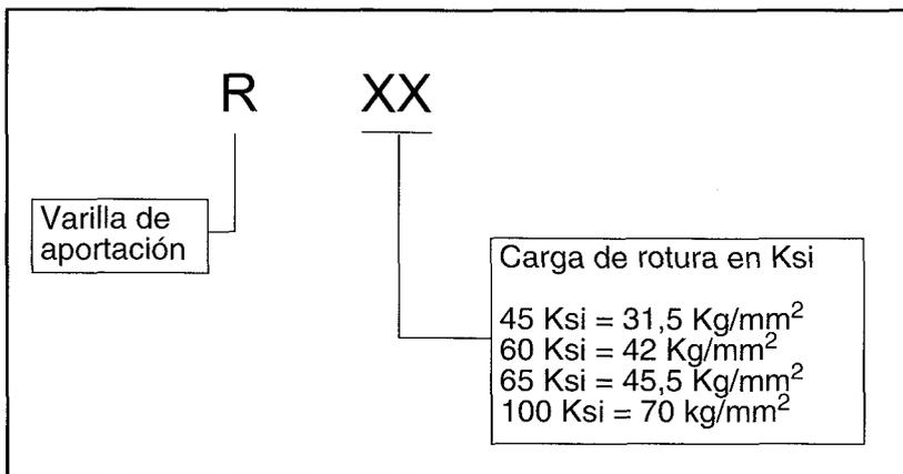
FIGURA 22.12: VARILLAS DE APORTACIÓN PARA EL SOLDEO OXIGÁS DE ACEROS AL CARBONO Y DE BAJA ALECIÓN DE ACUERDO CON ANSI/AWS A5.2-92
