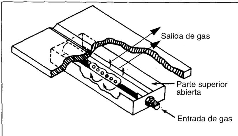
FIGURA 11.3: ZAPATA PARA GAS DE RESPALDO
