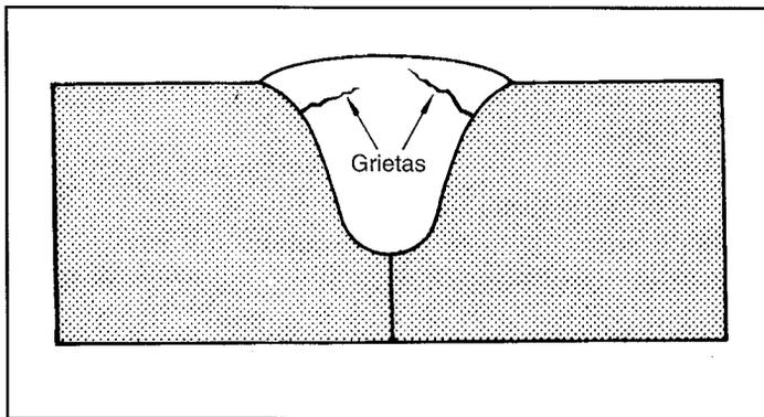
FIGURA 15.8: FORMACIÓN DE GRIETAS EN EL CORDÓN DE SOLDADURA DEBIDO A LA BAJA VELOCIDAD DE SOLDEO Y LA ALTA TENSION
