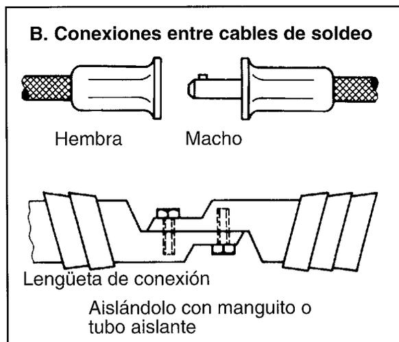
FIGURA 4.11: CONEXIONES PARA CABLES DE SOLDEO
