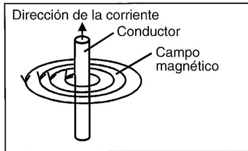
FIGURA 2.12: CAMPO MAGNÉTICO CREADO POR UNA CORRIENTE QUE CIRCULA POR UN CONDUCTOR
