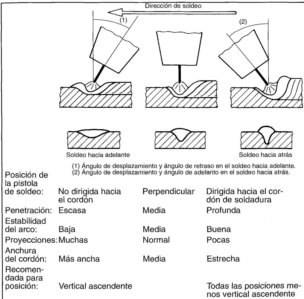
FIGURA 5.17: SOLDEO HACIA ATRÁS Y HACIA ADELANTE. ÁNGULO DE RETRASO Y DE ADELANTO
