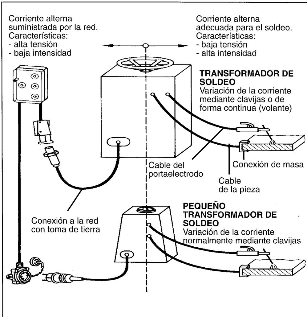
FIGURA 4.2: TRANSFORMADORES DE SOLDEO
