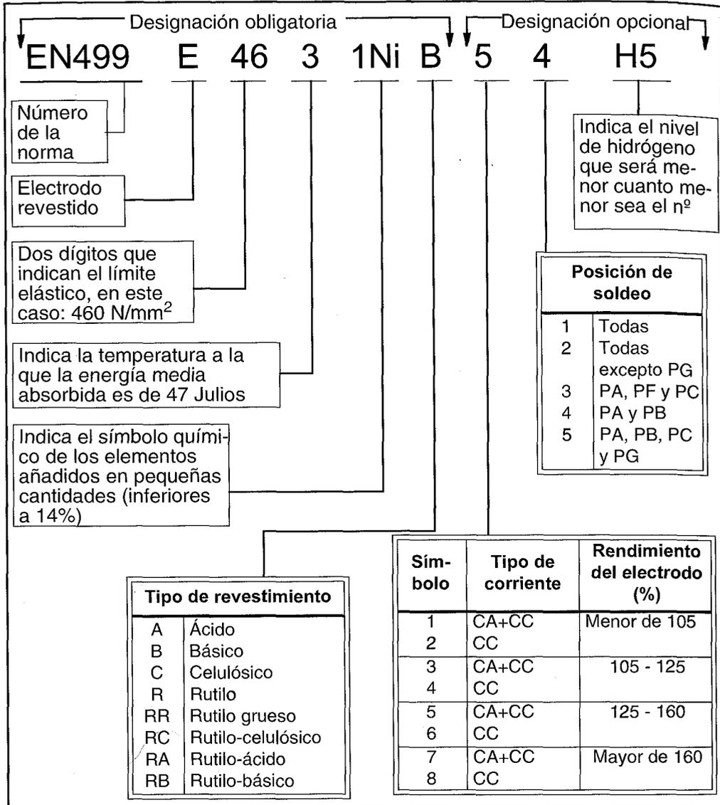
FIGURA 22.4: DESIGNACIÓN Y CLASIFICACIÓN DE LOS ELECTRODOS REVESTIDOS POR EL SOLDEO DE ACEROS NO ALEADOS DE ACUERDO CON UNE-EN 499:1995
