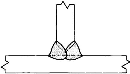
Una de las piezas sobre las que se realiza la soldadura tiene los bordes preparados, de esta forma se facilita la penetración.
