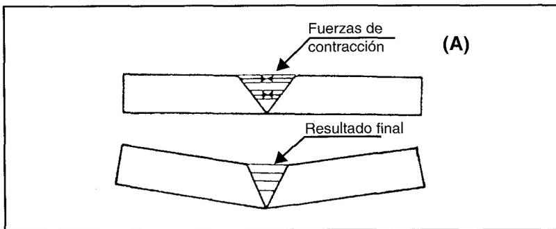
FIGURA 21.5: DEFORMACIÓN ANGULAR
