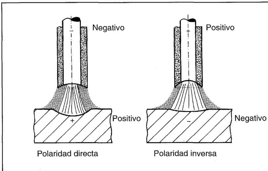
FIGURA 10.2: PENETRACIÓN OBTENIDA EN FUNCIÓN DE LA POLARIDAD
