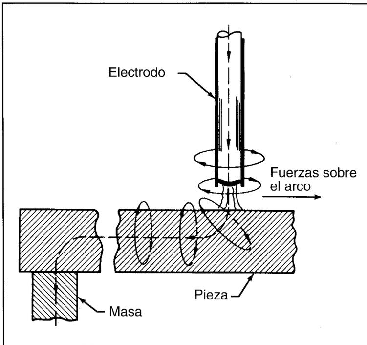
FIGURA 3.9: CAMBIO DE DIRECCIÓN DE LA CORRIENTE AL DIRIGIRSE HACIA LA CONEXIÓN DE MASA Y DISTORSIÓN DEL CAMPO MAGNÉTICO PROVOCADO POR ESTE CAMBIO
