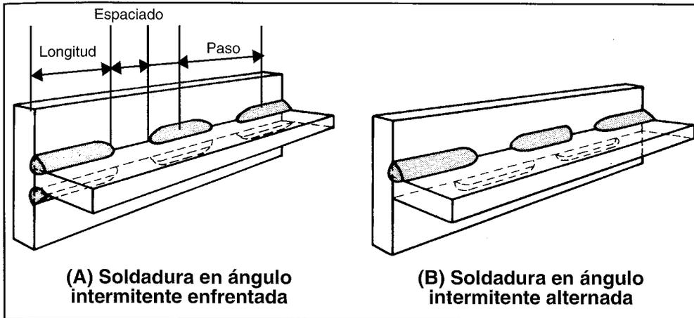
FIGURA 5.5: SOLDADURAS EN ÁNGULO INTERMITENTES
