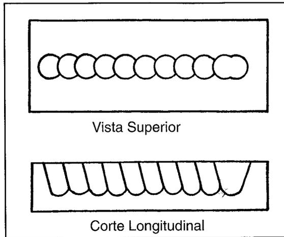
FIGURA 12.19: SOLDADURA OBTENIDA POR EL PROCESO TIG CON ARCO PULSADO
