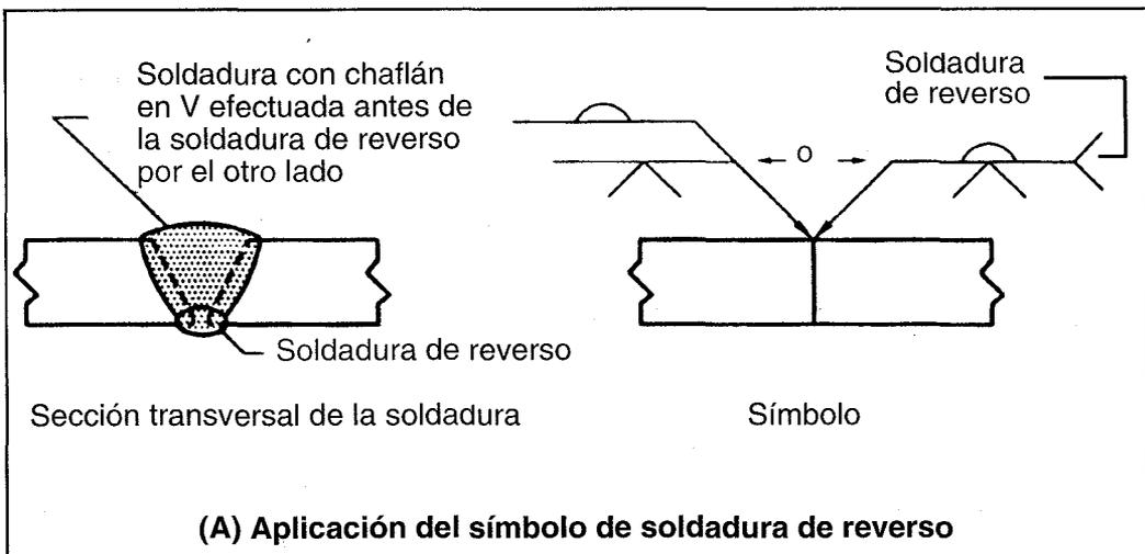
FIGURA 6.5: APLICACIONES DEL SÍMBOLO DE SOLDADURA DE REVERSO O RESPALDO
