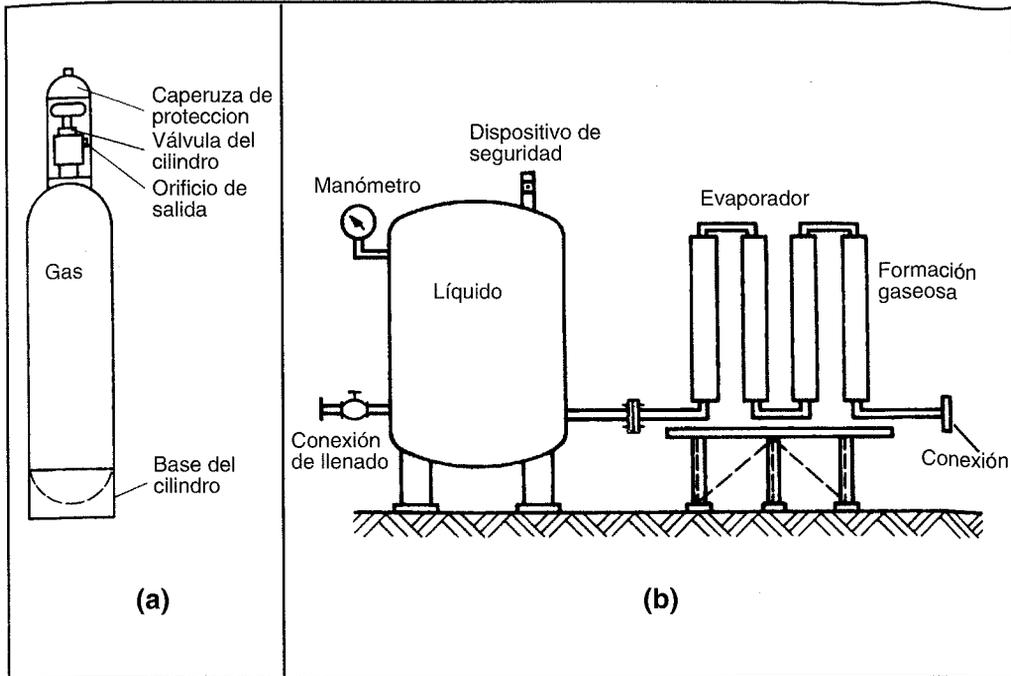
FIGURA 7.8: ALMACENAMIENTO DE GASES COMO EL OXÍGENO Y LOS GASES INERTES
