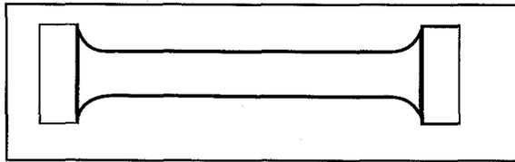
FIGURA 19.3: PROBETA PARA EL ENSAYO DE TRACCIÓN
