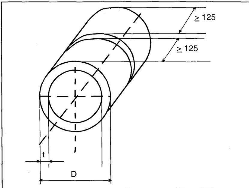
FIGURA 32.3: DIMENSIONES DEL CUPÓN DE PRUEBA PARA EL SOLDEO DE TUBOS A TOPE (DIMENSIONES EN MILÍMETROS)
