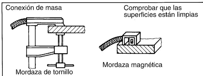
FIGURA 4.10: CONEXIÓN DE MASA
