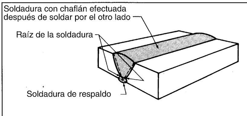
FIGURA 5.12: SOLDADURA DE RESPALDO
