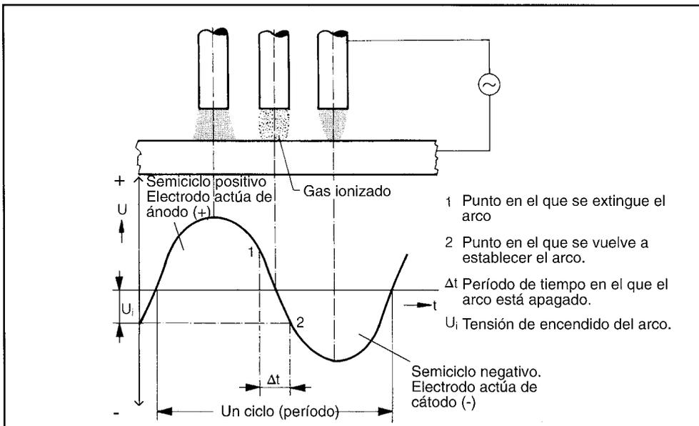
FIGURA 3.7: EFECTO DE LA CORRIENTE ALTERNA EN EL ARCO ELÉCTRICO
