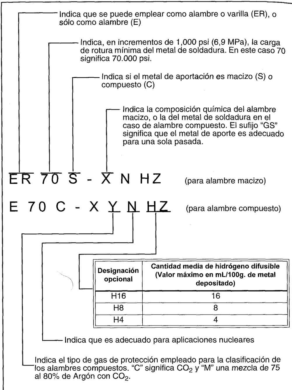
FIGURA 22.5: CLASIFICACIÓN DE LOS ALAMBRES Y VARILLAS PARA EL SOLDEO PROTEGIDO CON GAS DE ACEROS AL CARBONO DE ACUERDO CON ANSI/AWS A5.18-93
