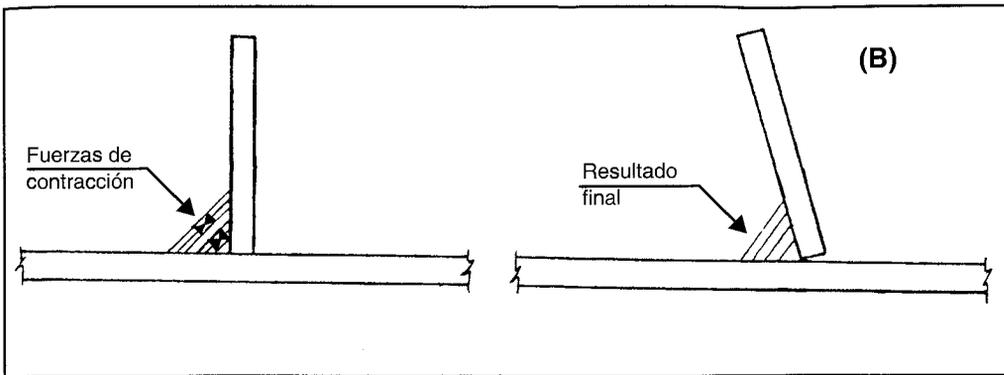
FIGURA 21.5: DEFORMACIÓN ANGULAR
