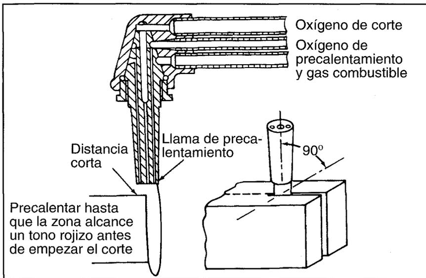
FIGURA 8.7: MÉTODO PARA EMPEZAR EL CORTE
