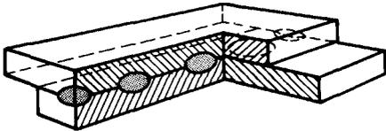
Soldaduras por puntos por resistencia
