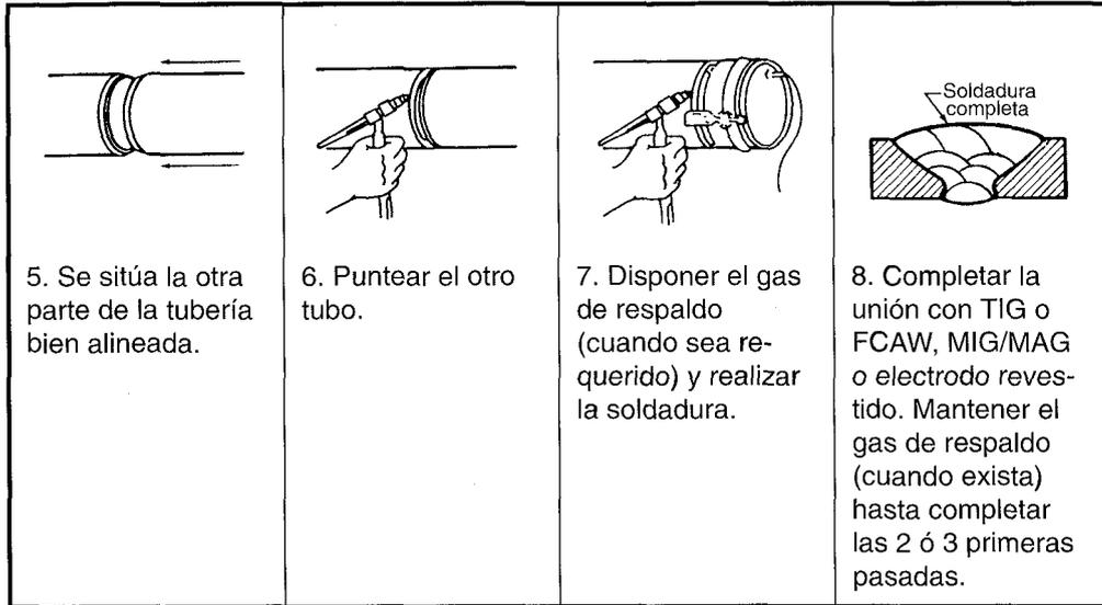
FIGURA 12.14 (C) (CONTINUACIÓN): PASOS A SEGUIR PARA SOLDAR TUBERÍA CON INSERTOS CLASE 1, 2, 3 Y 5
