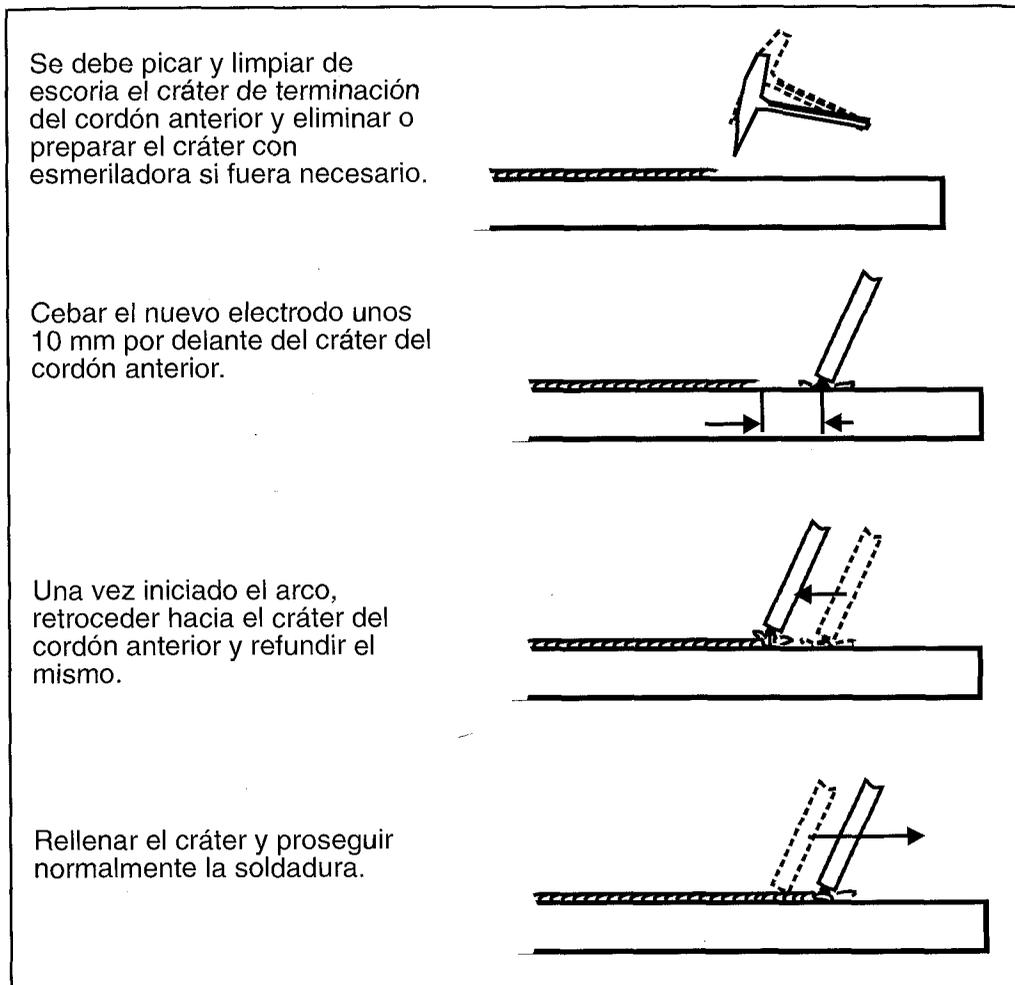
FIGURA 10.18: REALIZACIÓN CORRECTA DE LOS EMPALMES DE LOS CORDONES DE SOLDADURA
