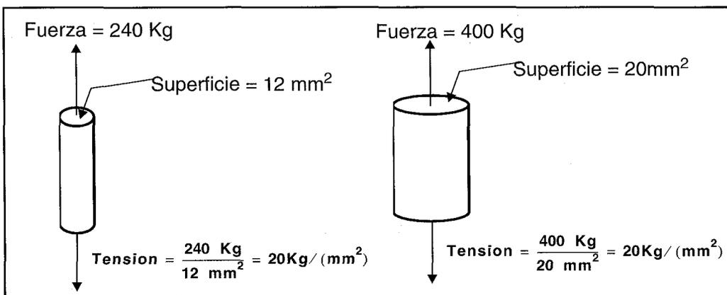
FIGURA 19.2: COMPARACIÓN ENTRE LOS CONCEPTOS DE TENSION Y FUERZA
