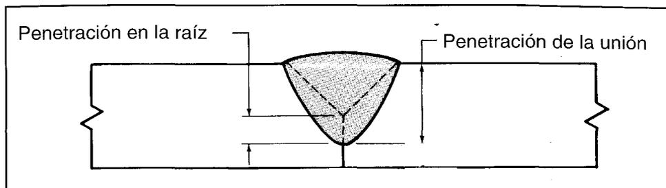
FIGURA 5.9: SOLDADURA CON PENETRACIÓN PARCIAL
