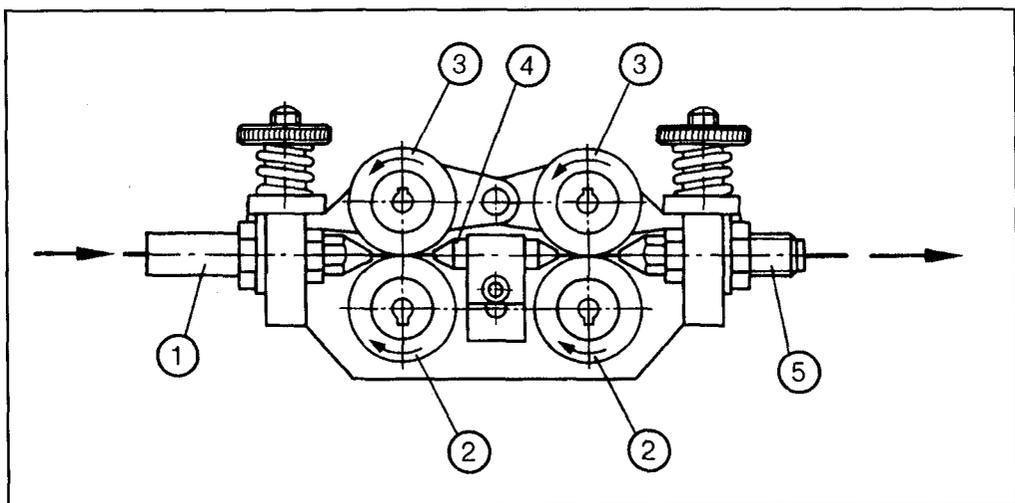
FIGURA 13.9: ALIMENTADOR DE ALAMBRE DE CUATRO RODILLOS
