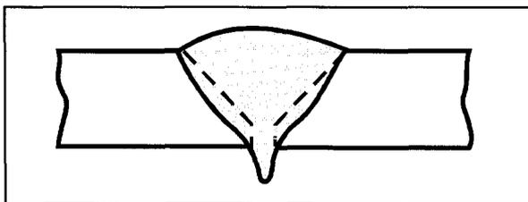
FIGURA 30.8: EXCESO DE PENETRACIÓN
