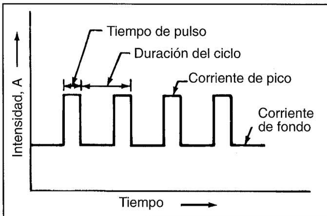
FIGURA 12.18: CICLO DE CORRIENTE EN EL SOLDEO CON ARCO PULSADO
