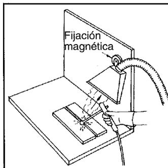
FIGURA 7.11: EXTRACTOR SEMIMÓVIL CON FIJACIÓN MAGNÉTICA
