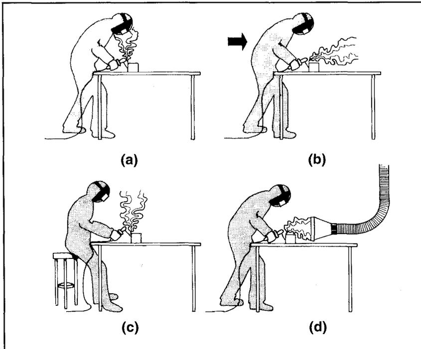
FIGURA 7.9: a) EXCESIVA EXPOSICIÓN A LOS HUMOS DE SOLDEO b) VENTILACIÓN GENERAL c) POSICIÓN DE SOLDEO ADECUADA d) EXTRACCIÓN LOCALIZADA
