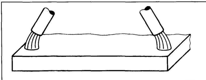
FIGURA 3.13: ELECCIÓN DEL ÁNGULO DE SOLDEO ADECUADO PARA DISMINUIR EL SOPLO MAGNÉTICO
