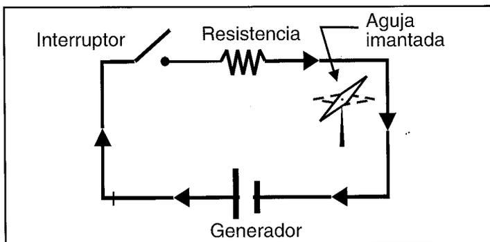
FIGURA 2.9: EFECTOS DE LA CORRIENTE ELÉCTRICA
