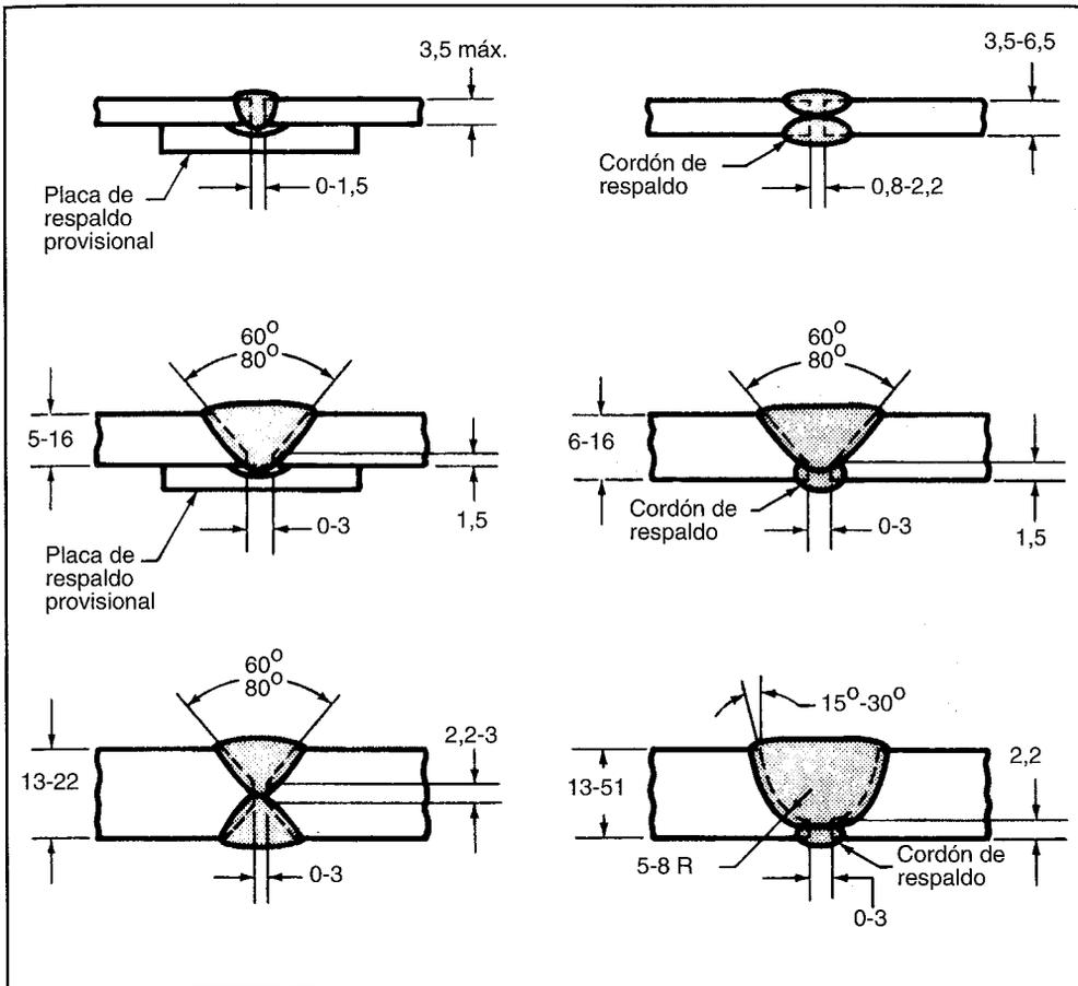
FIGURA 27.1: DISEÑO DE UNIONES A TOPE PARA EL SOLDEO DE ALEACIONES DE NÍQUEL
