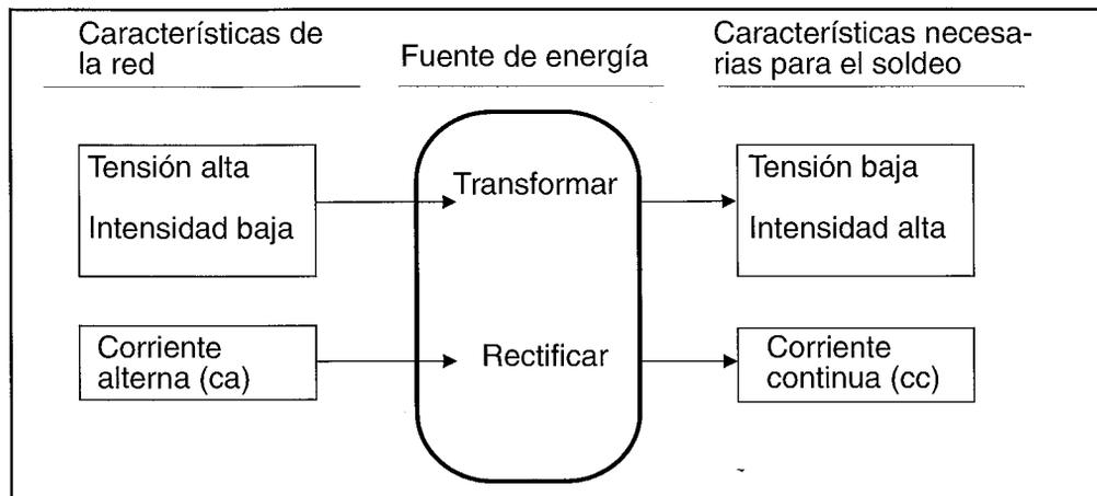
FIGURA 4.1: FUNCIONES FUNDAMENTALES DE LA FUENTE DE ENERGÍA
