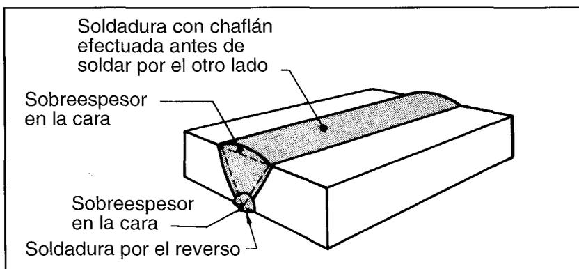
FIGURA 5.10: SOLDADURA POR EL REVERSO
