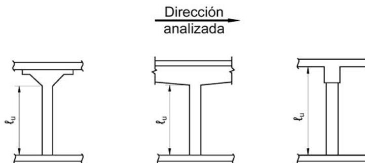
Figura 401: Longitudes de columnas sin apoyo lateral  $l_u$  (referencia 109)
