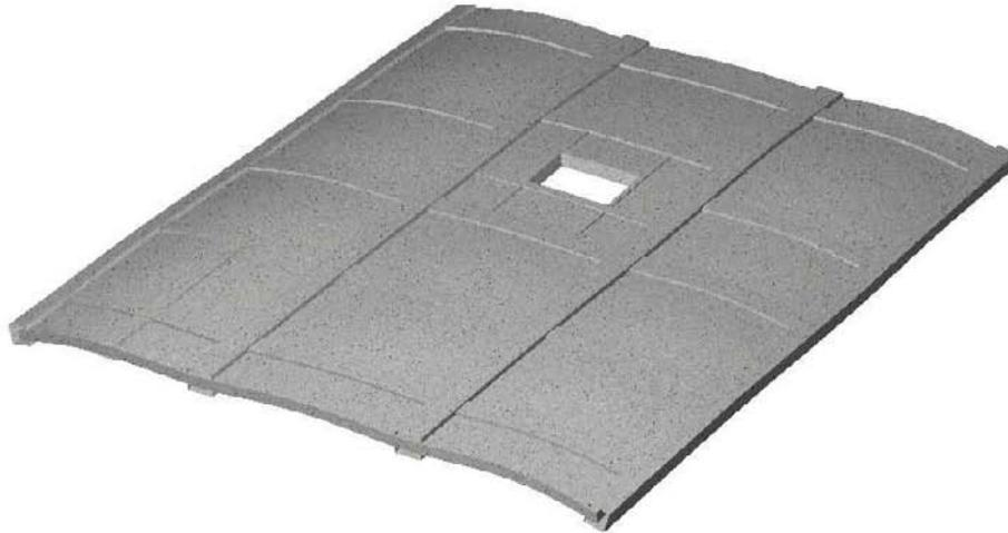
Figura 469: Deformada a partir de la modelación por elementos finitos de una platea con nervios rigidizantes
