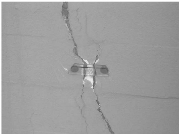
Figura 14: Control del avance de fisuras sobre una estructura de hormigón
