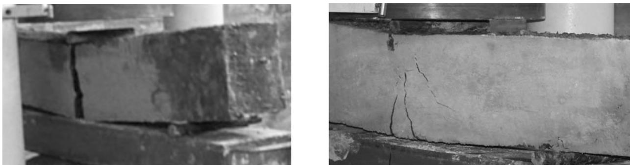
Figura 56: Falla frágil (izq.) y dúctil (der.) de una viga ensayada a flexión con una carga céntrica (LABIEVI de la UNPSJB)
