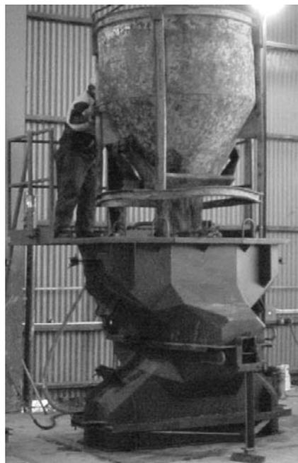
Figura 36: Hormigonado de elementos premoldeados de hormigón simple para escolleras en la Obra de Remodelación de Puerto Rawson
