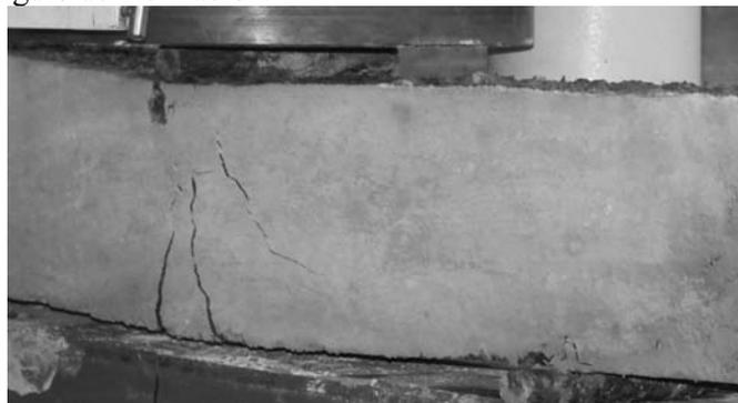
Figura 221: Ensayo a flexión y corte de una viga simplemente apoyada (LABIEVI de la UNPSJB)
