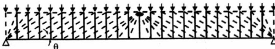
Figura 200: Modelo del reticulado según la Teoría del Campo a Compresión
