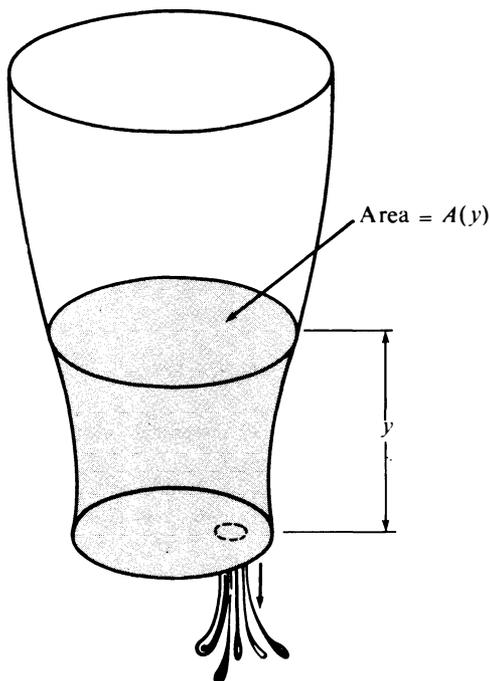
FIGURA 8.15 Salida de un líquido por un orificio
