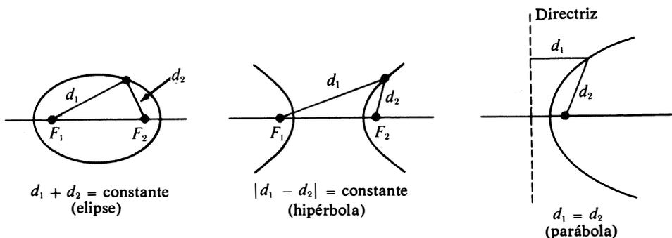
FIGURA 13.10 Definiciones focales de las secciones cónicas.
