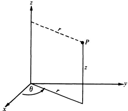
FIGURA 14.18 Coordenadas cilíndricas.
