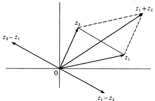
FIGURA 9.2 Adición y sustracción de números complejos representados geoméricamente mediante la ley del paralelogramo.
