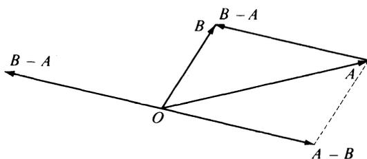
FIGURA 12.5 Significado geométrico de la sustracción de vectores.
