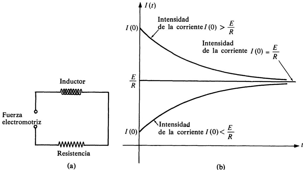
FIGURA 8.2 a) Diagrama para un circuito simple en serie. b) Intensidad resultante al aplicar un voltaje constante  $E$ .
